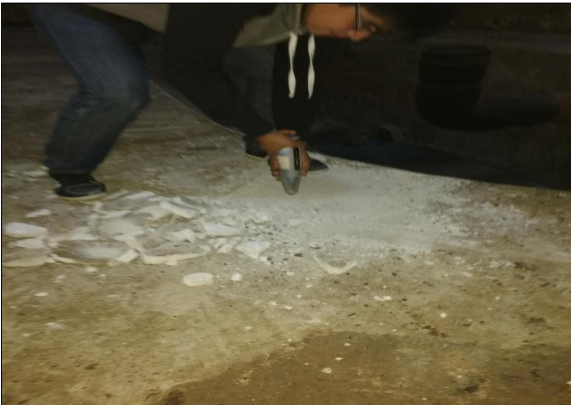
**Fotografía 20.** Realización del ensayo con esclerómetro en la losa de fondo.
