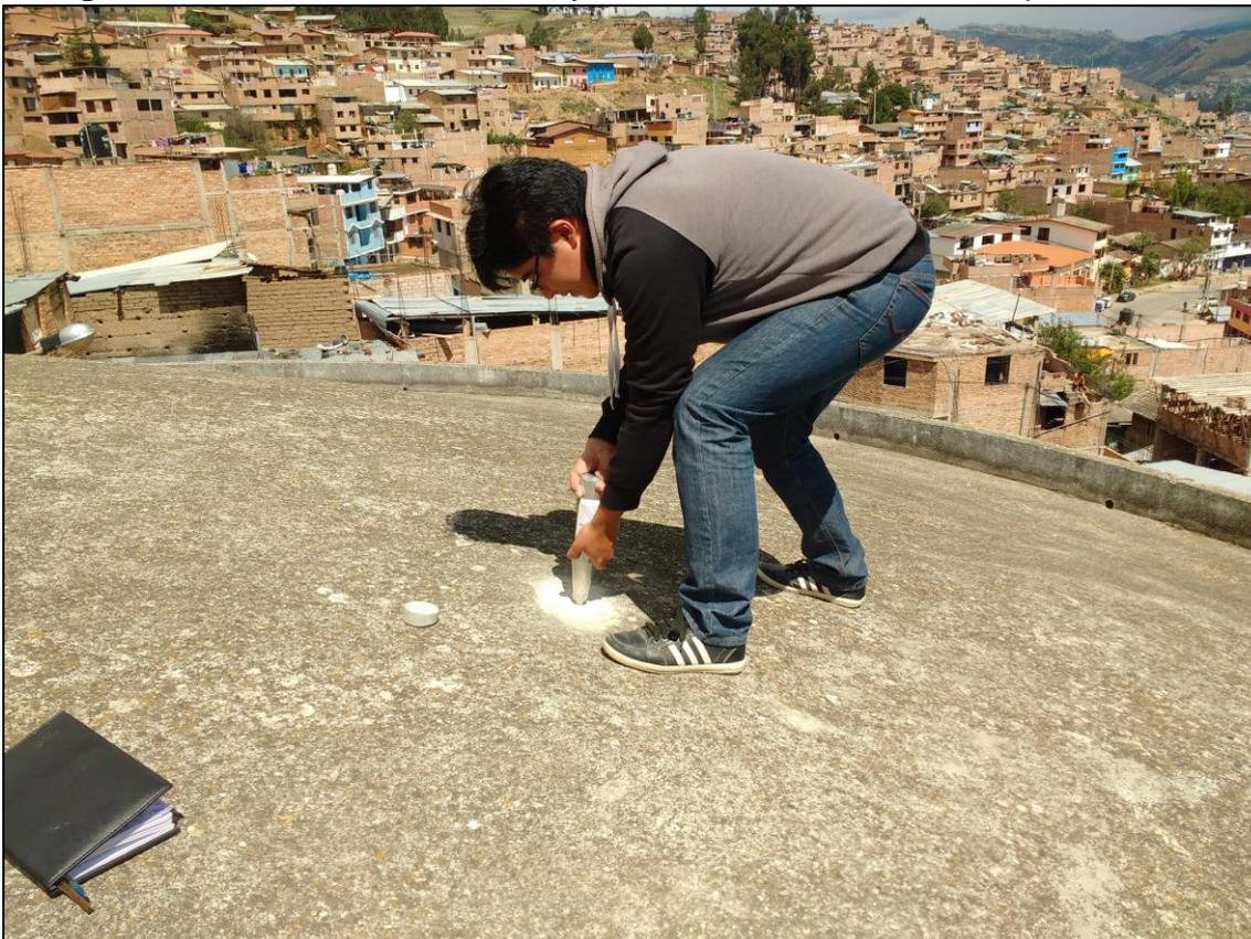
**Fotografía 19.** Realización del ensayo con esclerómetro en la losa de fondo del reservorio.
