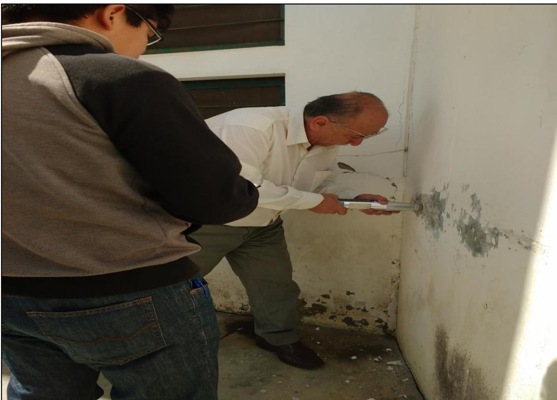
**Fotografía 18.** Realización del ensayo con esclerómetro en la cúpula.
