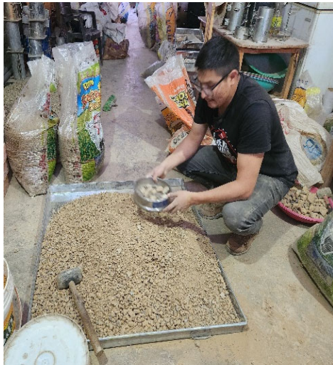
Fotografía N° 9. Preparación de muestras para ensayo de CBR - Suelo Natural
