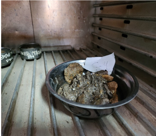
Fotografía N° 5. Secado de Muestra después de lavado de finos
