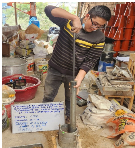
Fotografía N° 11. Compactación para Ensayo de CBR – Suelo Natural
