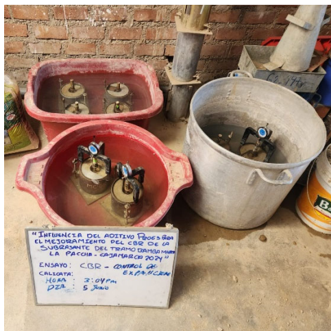
Fotografía N° 15. Adición de Aditivo Proes al Optimo contenido de Humedad - Suelo +Aditivo
