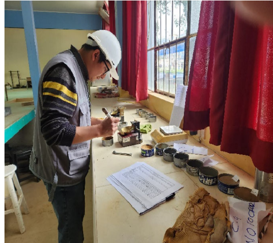
Fotografía N°6. Ejecución de Ensayo de Limite Liquido
