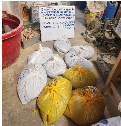
Fotografía N° 16. Colocación de con aditivo en bolsas plásticas para uniformizar la humedad -Suelo + Aditivo
