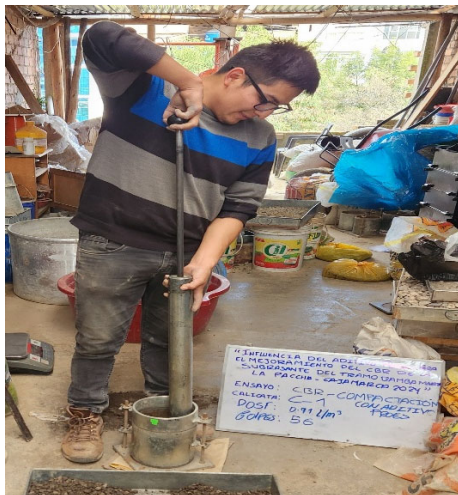
Fotografía N°17. Compactación para CBR – Suelo +Aditivo
