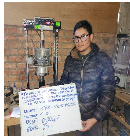
Fotografía N° 20. Ensayo de Penetración - Suelo +Aditivo
