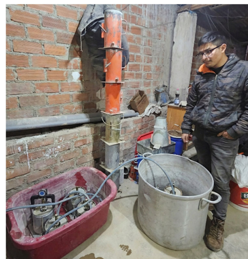
Fotografía N° 12. Sumersión de moldes con suelo compactado – Suelo Natural para ensayo de Hinchamiento
