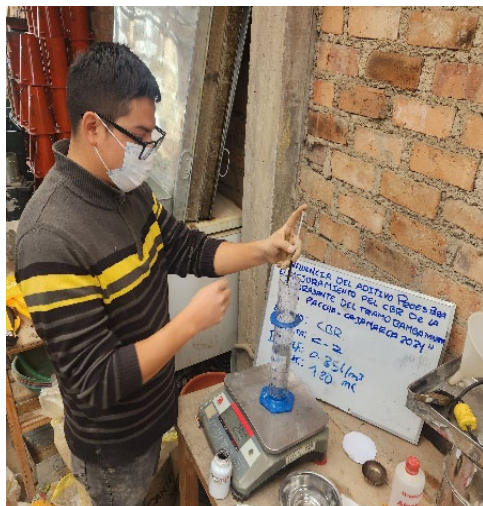
Fotografía N° 15. Adición de Aditivo Proes al Optimo contenido de Humedad - Suelo +Aditivo
