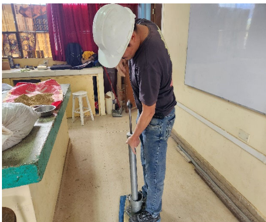
Fotografía N° 7. Ensayo de Proctor Modificado
