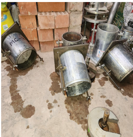
Fotografía N° 19. Drenado los moldes para someterlos a ensayo de Penetración
