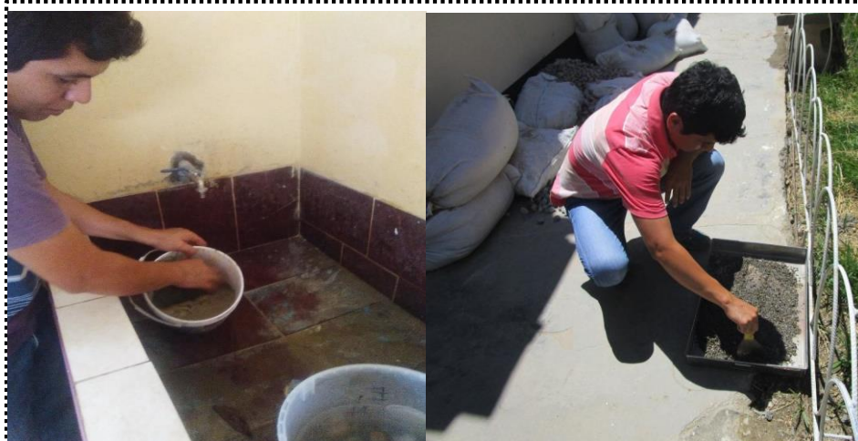
Imagen N° 11: Ensayo Peso específico y absorción (saturando los agregados por 24 horas, y saturado con superficie seca).
