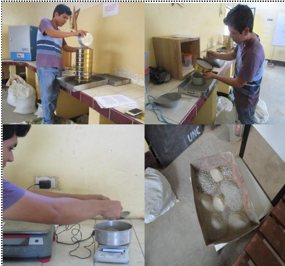
Imagen N° 8: Ensayo de granulometría agregado fino.
