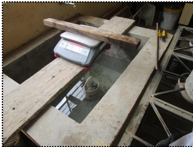
Imagen N° 13: Peso sumergido del agregado grueso.
