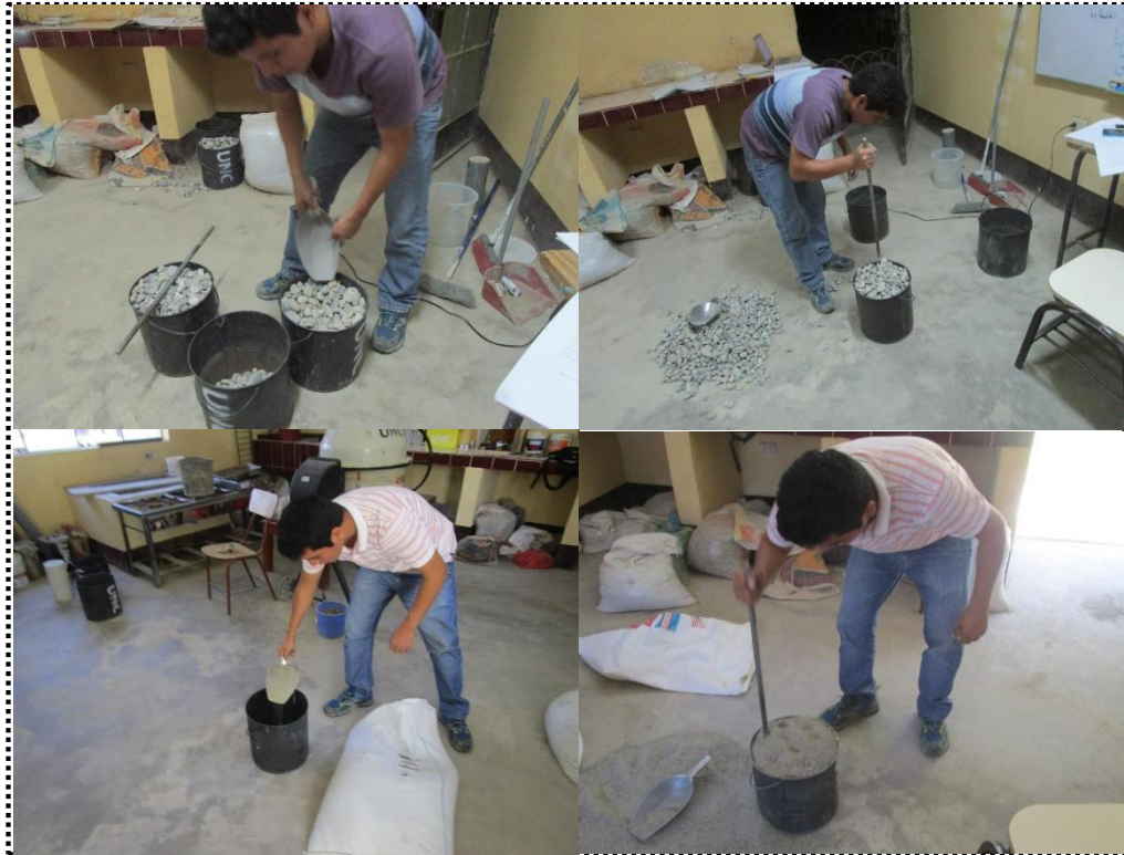
Imagen N° 14: Ensayo peso unitario suelto del agregado grueso y fino, ensayo peso unitario suelto agregado fino y grueso.
