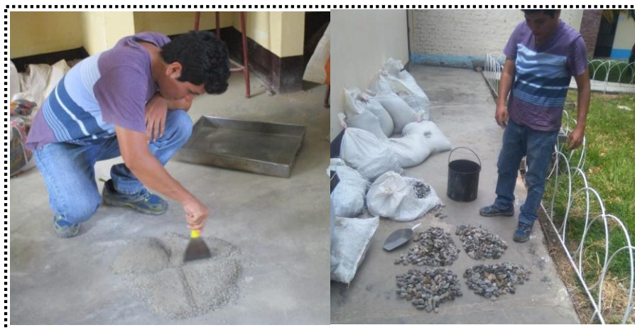
Imagen N° 7: Reducción de las muestras de agregado a tamaño de ensayo de agregado fino y agregado grueso.
