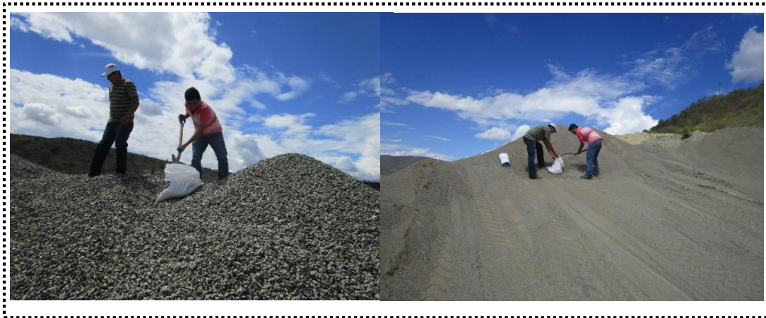
Imagen N° 6: Muestreo del agregado.
