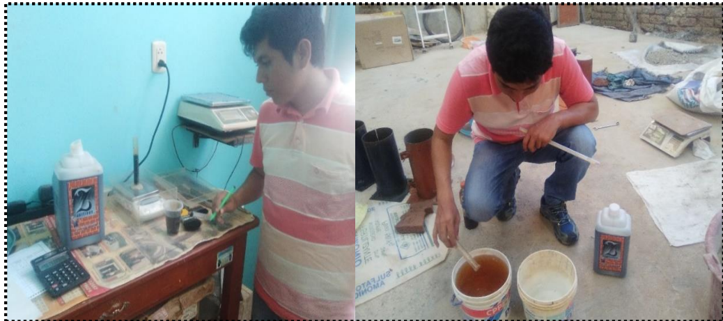
Imagen N° 17: Midiendo y mezclando el aditivo Z RETAR con el agua.
