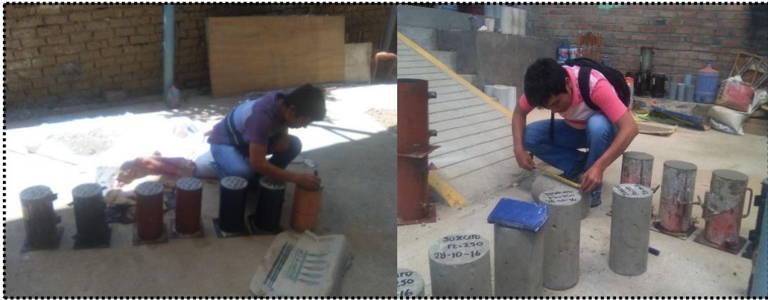
Imagen N° 22: Identificación y medición de las probetas.
