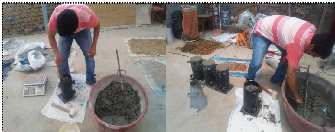
Imagen N° 20: Realización de las probetas los especímenes cilíndricos.
