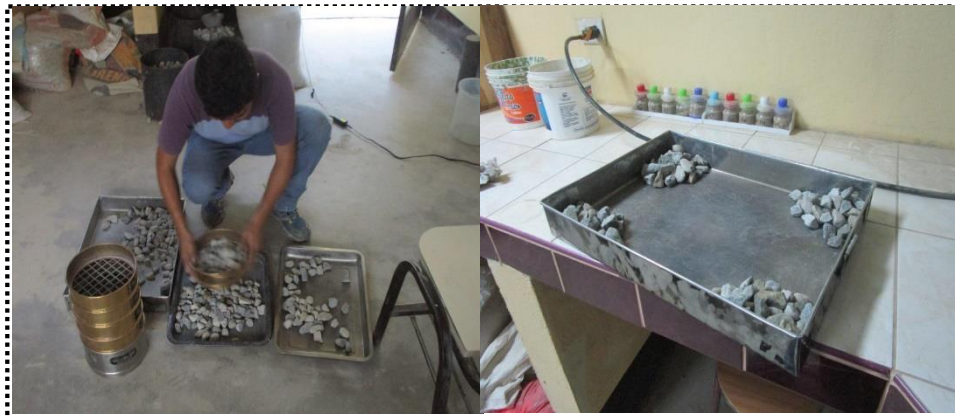
Imagen N° 9: Ensayo de granulometría agregado grueso.
