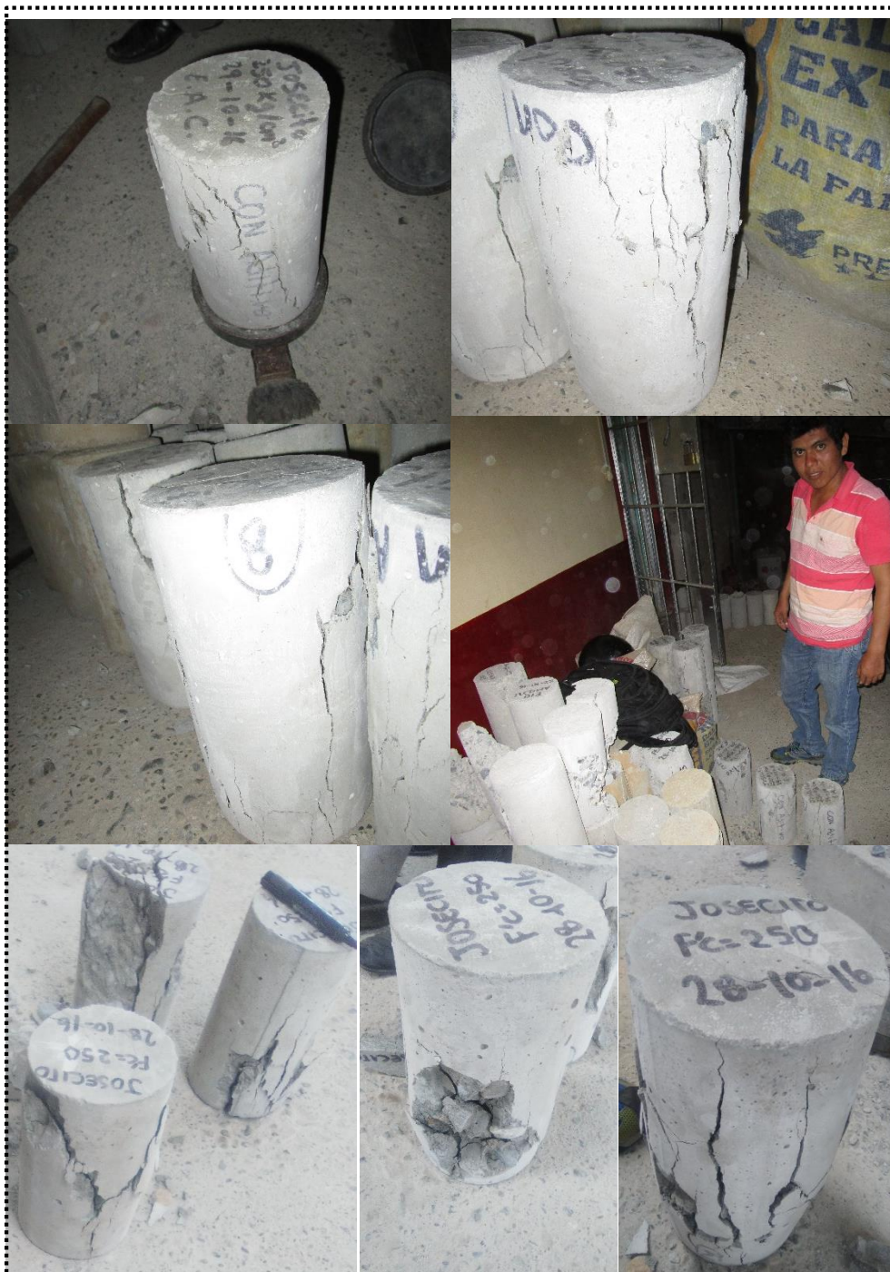
Imagen N° 25: Tipo de fallas en los ensayos de resistencia a la compresión.
