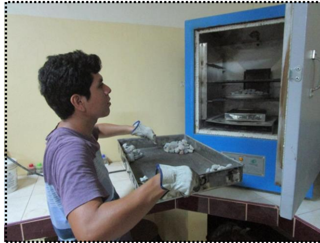
Imagen N° 12: Colocación del agregado grueso al horno a una temperatura 105 °C.
