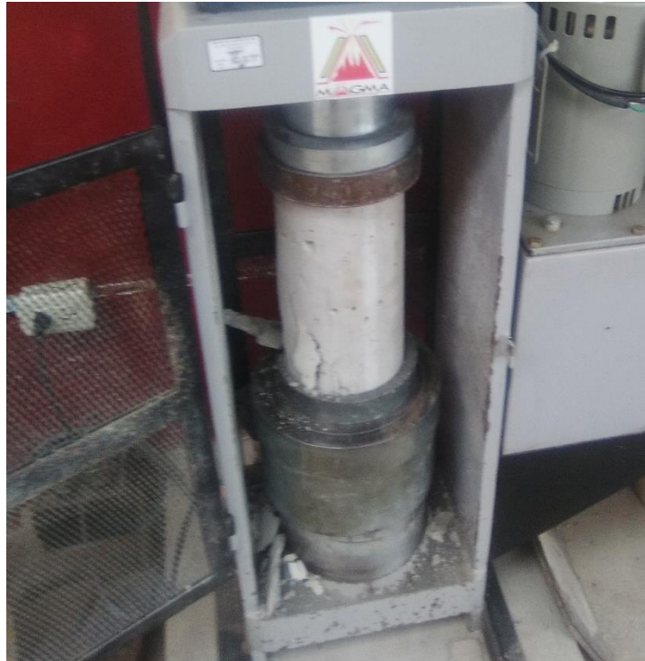
Imagen N° 4: Ensayo a compresión, registro de tipo de falla.
