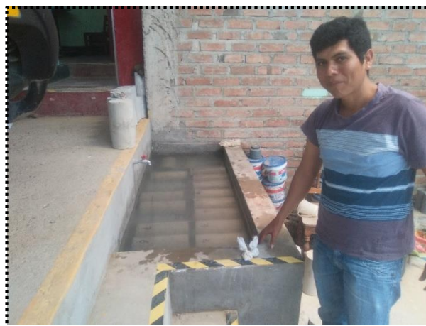
Imagen N° 23: Curado con agua las probetas.
