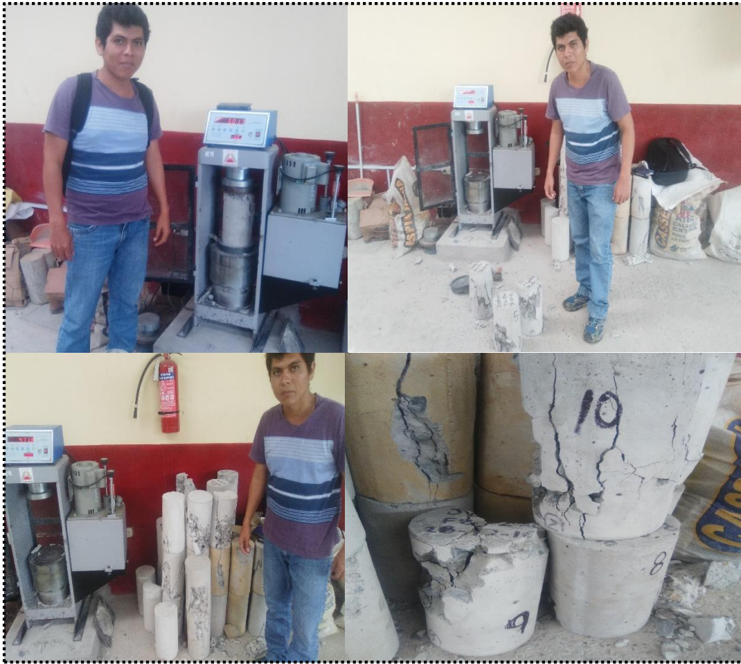
Imagen N° 24: Ensayo a la compresión de las probetas.
