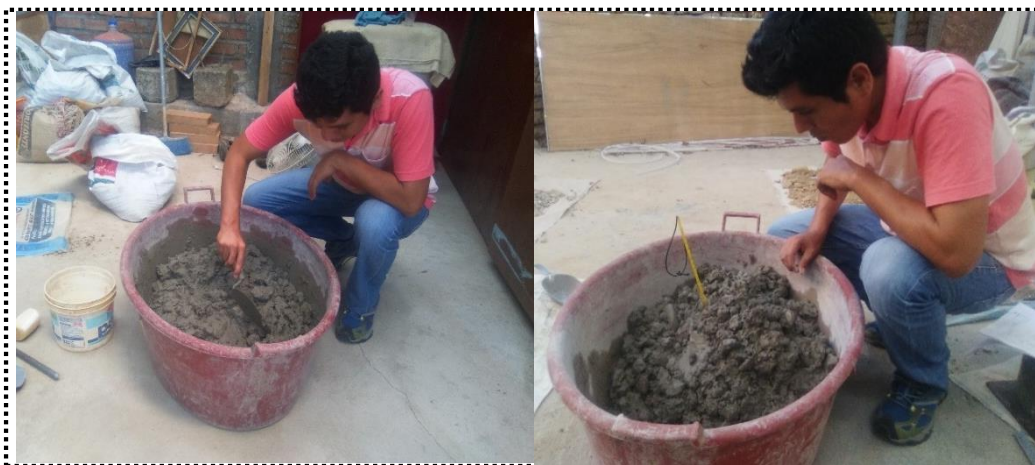
Imagen N° 18: Mezclando los materiales con el agua y midiendo la temperatura del concreto.
