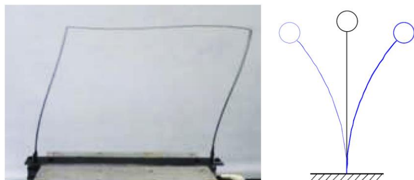
Figura 4. Vibración de un pórtico de un piso o péndulo simple.
