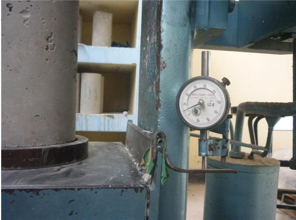
**Fotografía 35: Control de deformaciones con deformímetro**
