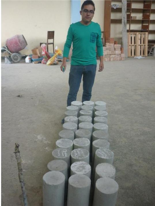
**Fotografía 25: Preparación de las probetas para iniciar la ruptura**
