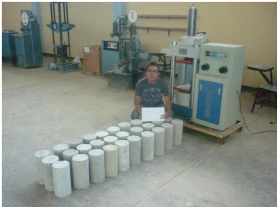
**Fotografía 32: Preparación de probetas para ruptura**
