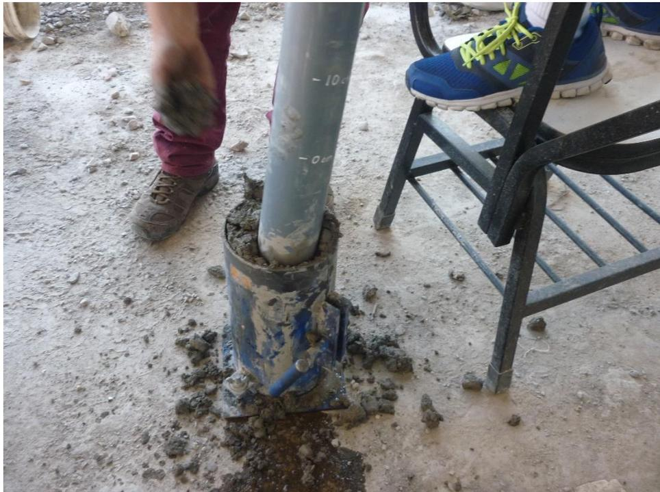
**Fotografía 20: Compactación de concreto en las últimas capas**
