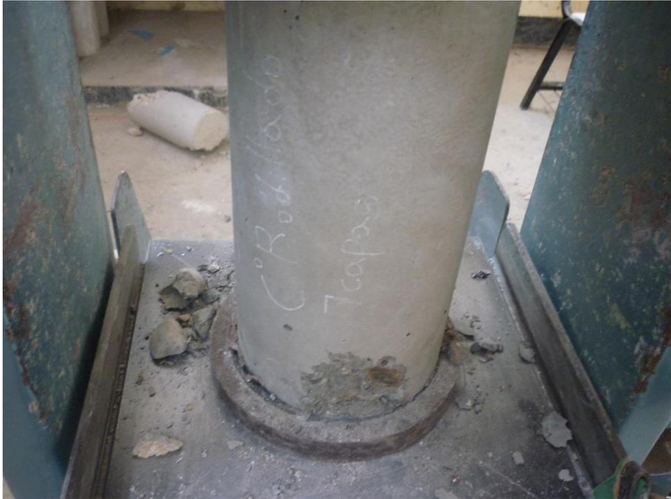
**Fotografía 29: Falla en la probeta al momento de la ruptura**
