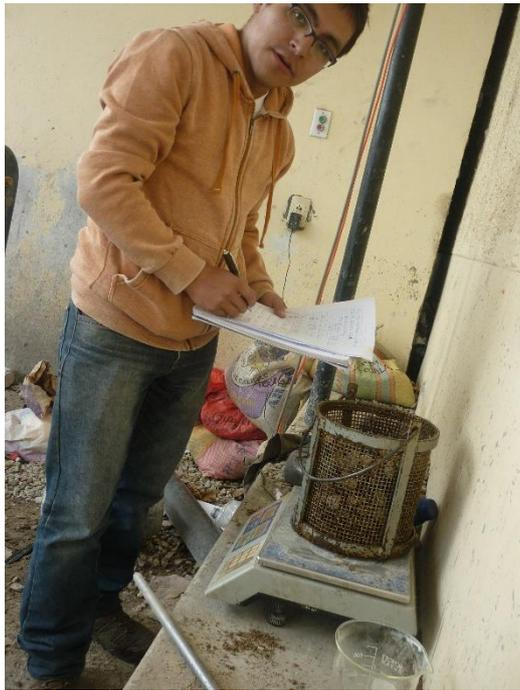
**Fotografía 4: Ensayo para peso específico del agregado grueso.**
