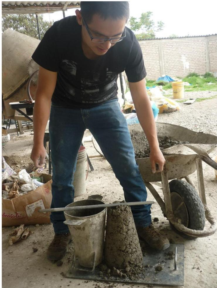
**Fotografía 6: Medición de Slump del concreto rodillado**
