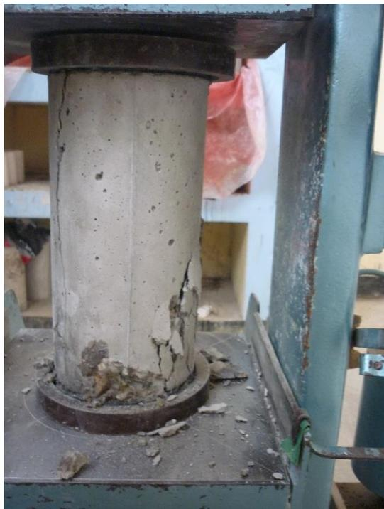
**Fotografía 14: Ruptura de las probetas patrón de concreto**
