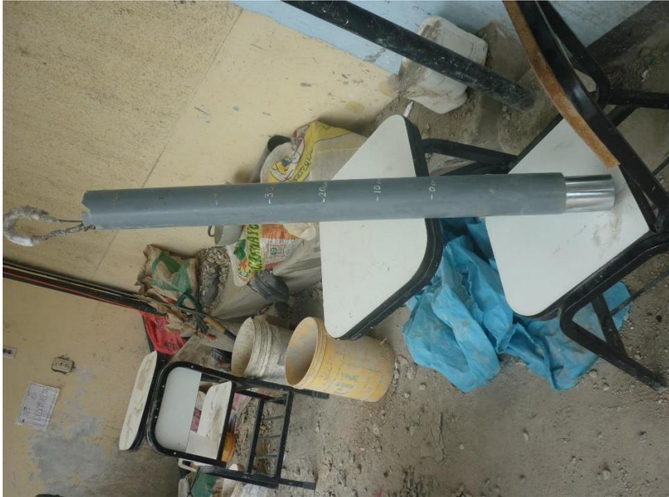
**Fotografía 23: Dispositivo de compactación graduado**
