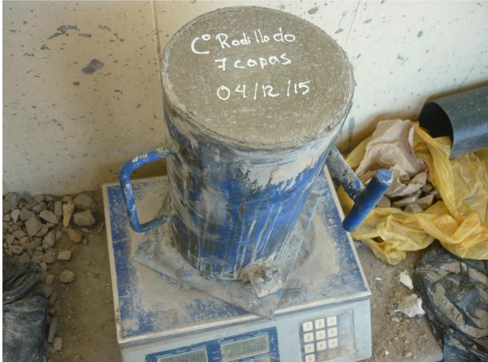
**Fotografía 17: Inicio de desencofrado de probetas de concreto rodillado**
