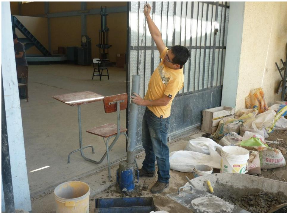
**Fotografía 12: Inicio de las probetas de concreto rodillado, utilizando la energía de compactación de rodillado.**
