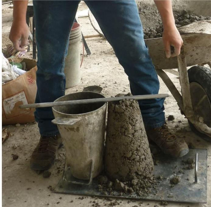
Fig 3.2 Asentamiento nulo para el concreto de diseño
