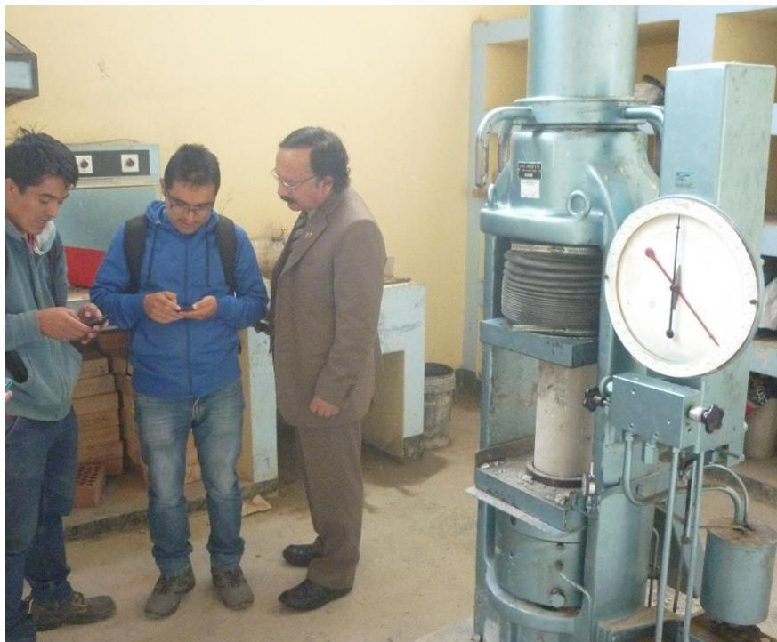
**Fotografía 38: Cálculo in situ de resistencia del concreto**
