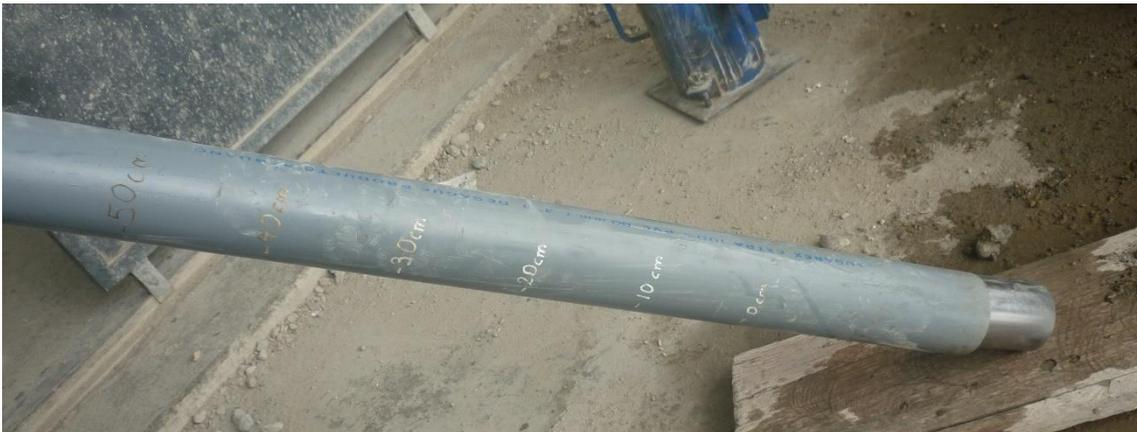
Fig 3.3 Martillo compactador con guía de PVC y base de acero
