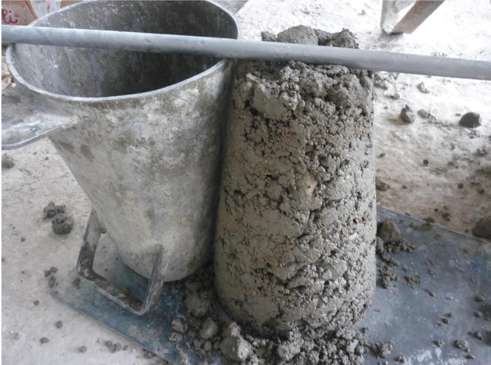
**Fotografía 7: Medición de la consistencia del concreto**
