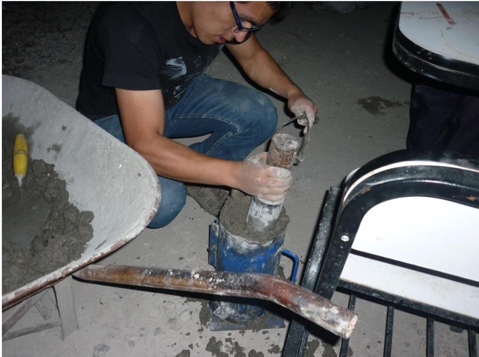
**Fotografía 22: Enrazado de la última capa del concreto rodillado**
