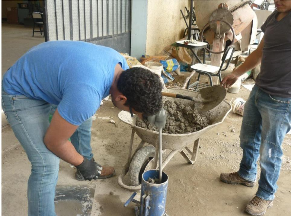
**Fotografía 09: Compactación manual para realización de probetas patrón (Concreto normal)**
