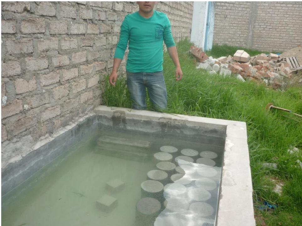
**Fotografía 24: Curado de las probetas de concreto rodillado**
