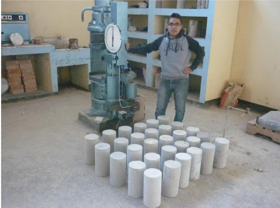
**Fotografía 33: Preparación de probetas para ruptura**
