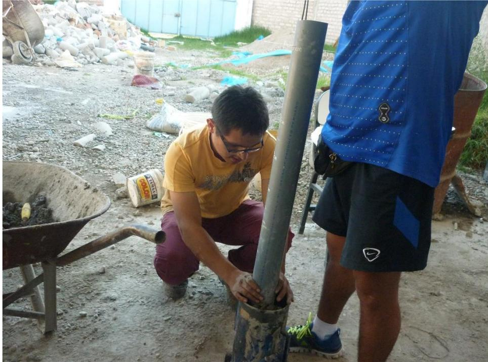
**Fotografía 19: Compactación de probetas para el concreto rodillado**
