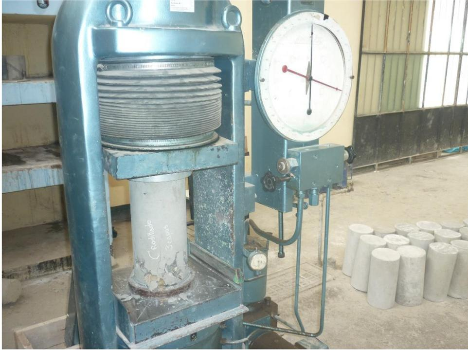
**Fotografía 27: Ruptura de las probetas a compresión**
