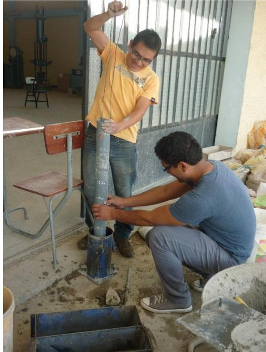
**Fotografía 13: Compactación con dispositivo compactador según número de golpes y altura especificada**
