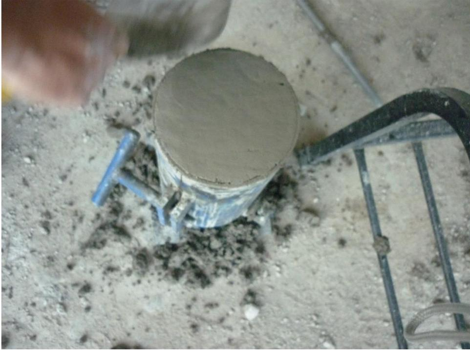
**Fotografía 21: Enrazado de las probetas de las concreto rodillado**
