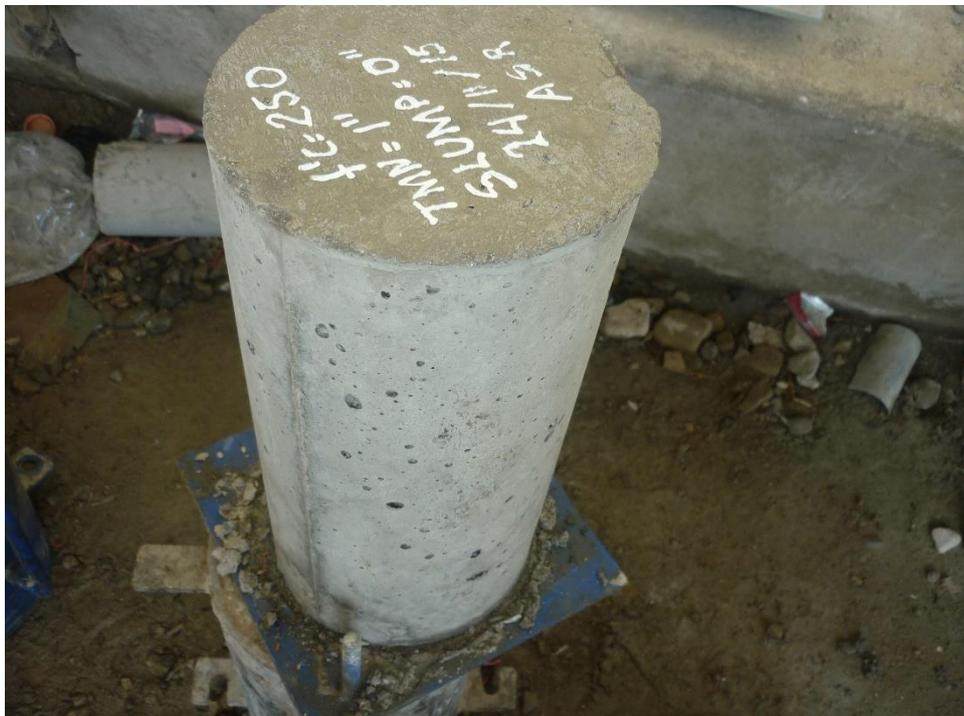
**Fotografía 10: Desencofrado de probeta patrón (Concreto normal)**
