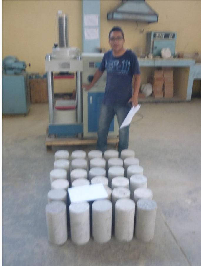
**Fotografía 31: Preparación de probetas para ruptura**
