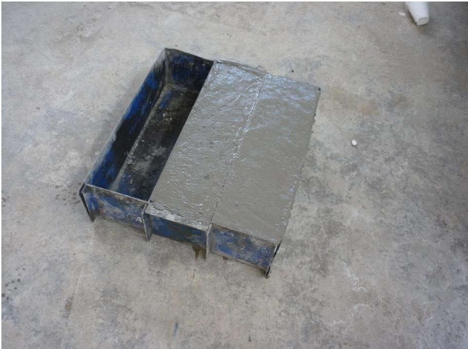
**Fotografía 16: Enrasado de las probetas prismáticas para pruebas a flexión.**
