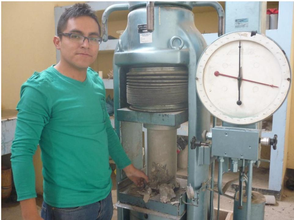
**Fotografía 30: Falla en la probeta en la ruptura**
