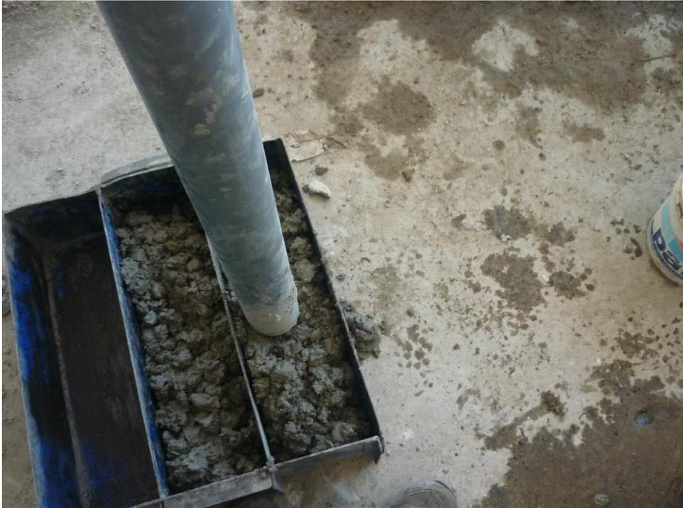
**Fotografía 15: Preparación de probetas prismáticas para pruebas a flexión**
