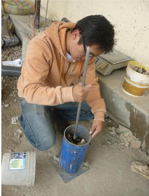
**Fotografía 3: Ensayo para obtener el peso compactado suelto del agregado grueso.**
