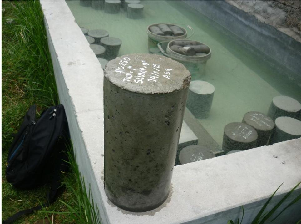
**Fotografía 11: Curado de las probetas patrón de concreto (Concreto normal)**
