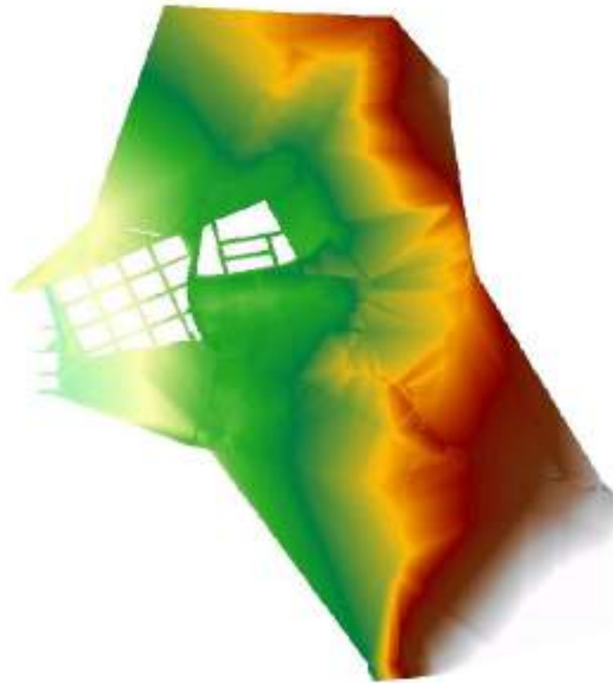
Figura 51.- Transformación de TIN a DEM. (Modelos Digital de Elevación), creada en QGis 3.40.2. Con formato(.tif)
