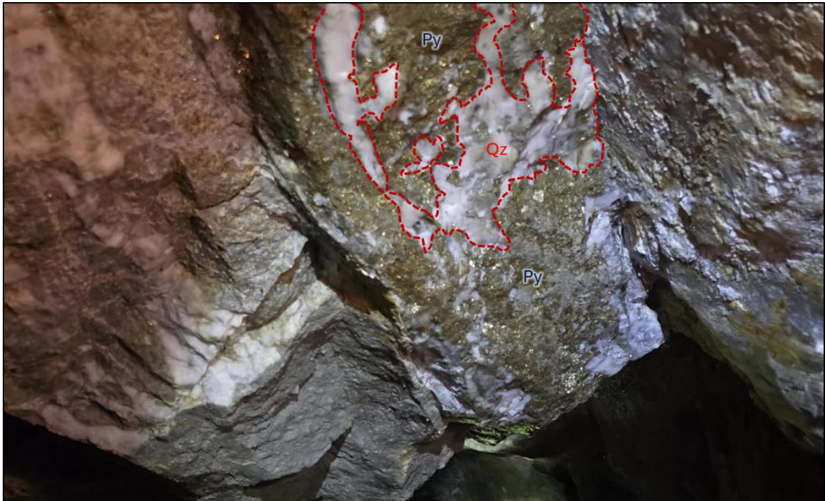
Fotografía 4. Control mineralógico de las vetas Victoria y Mercedes, emplazamiento de cuarzo y pirita.
