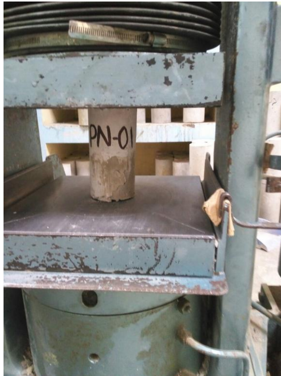
Imagen N° 14: Probetas sin adhesivo ensayadas a compresión
