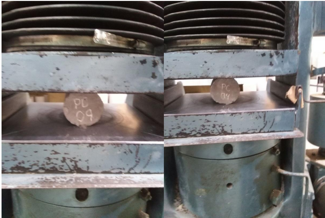
Imagen N° 28: Ensayos a tracción de probetas con Chema epox Adhesivo 32
