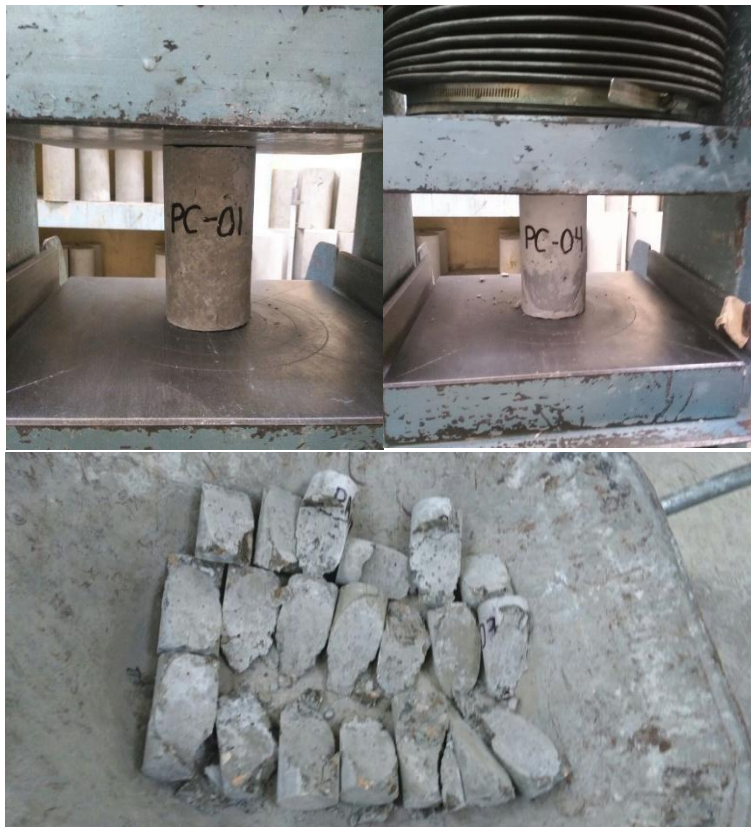
Imagen N° 25: Ensayos a compresión de probetas con Chema epox Adhesivo 32
