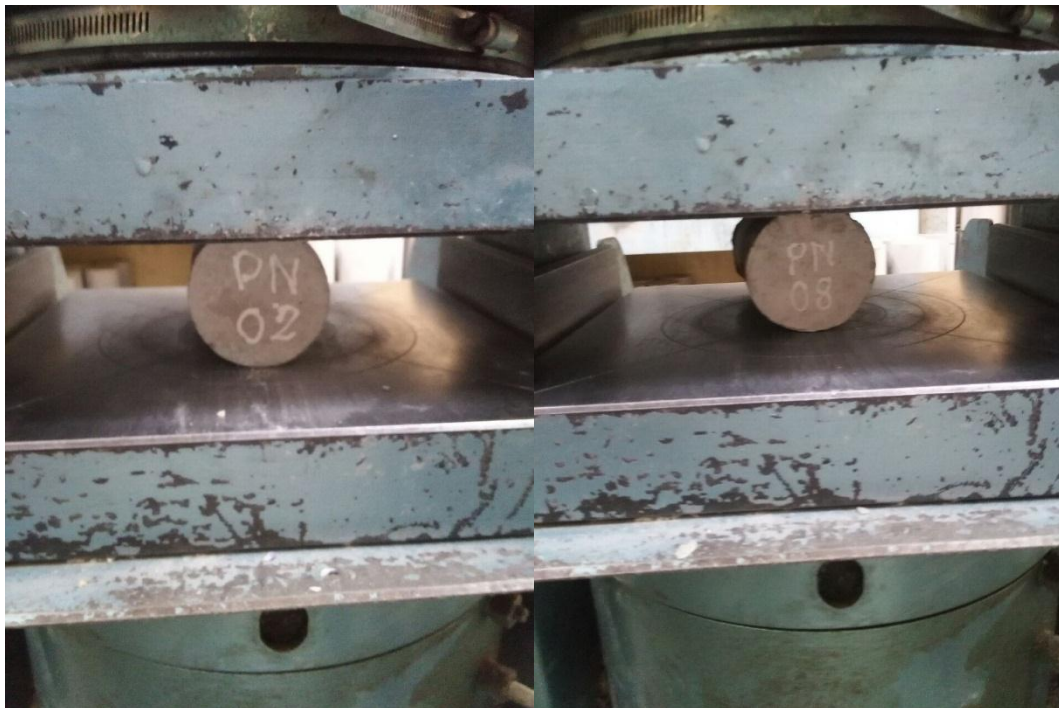
Imagen N° 27: Ensayos a Tracción de probetas sin adhesivo epóxico
