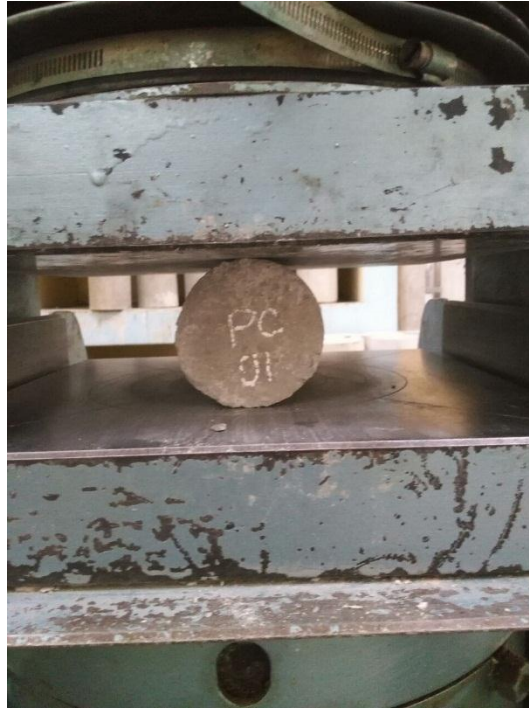
Imagen N° 18: Probetas con adhesivo Chema Epox Adhesivo 32 ensayadas a tracción
