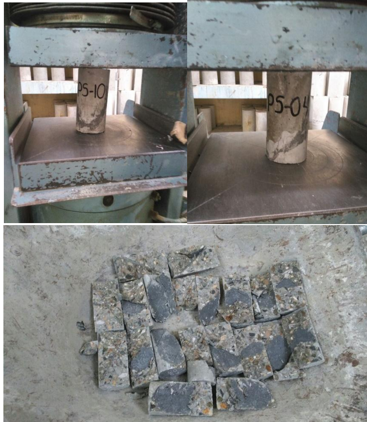
Imagen N° 26: Ensayos a compresión de probetas con Sikadur 32 Gel
