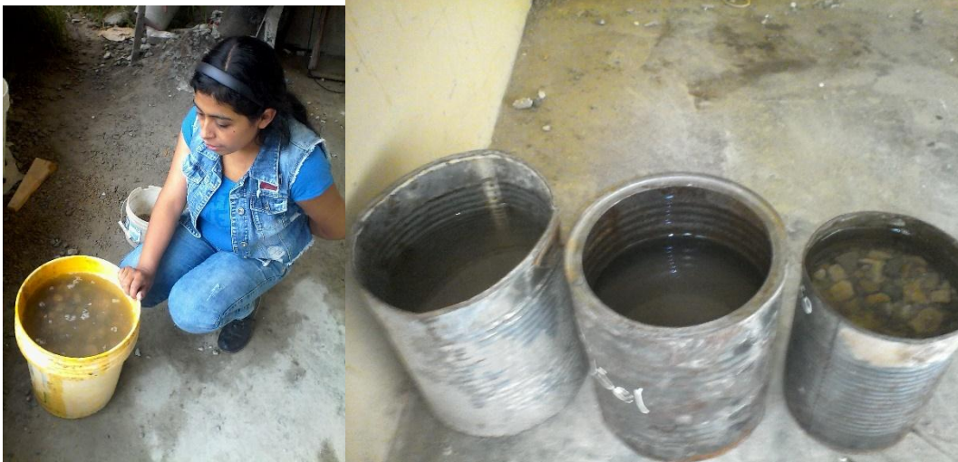
Imagen N° 22: Saturación de agregados para ensayos de densidad
