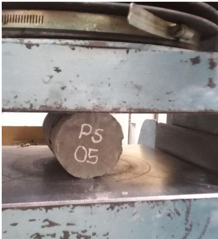
Imagen N° 19: Probetas con adhesivo Sikadur 32 Gel ensayadas a tracción
