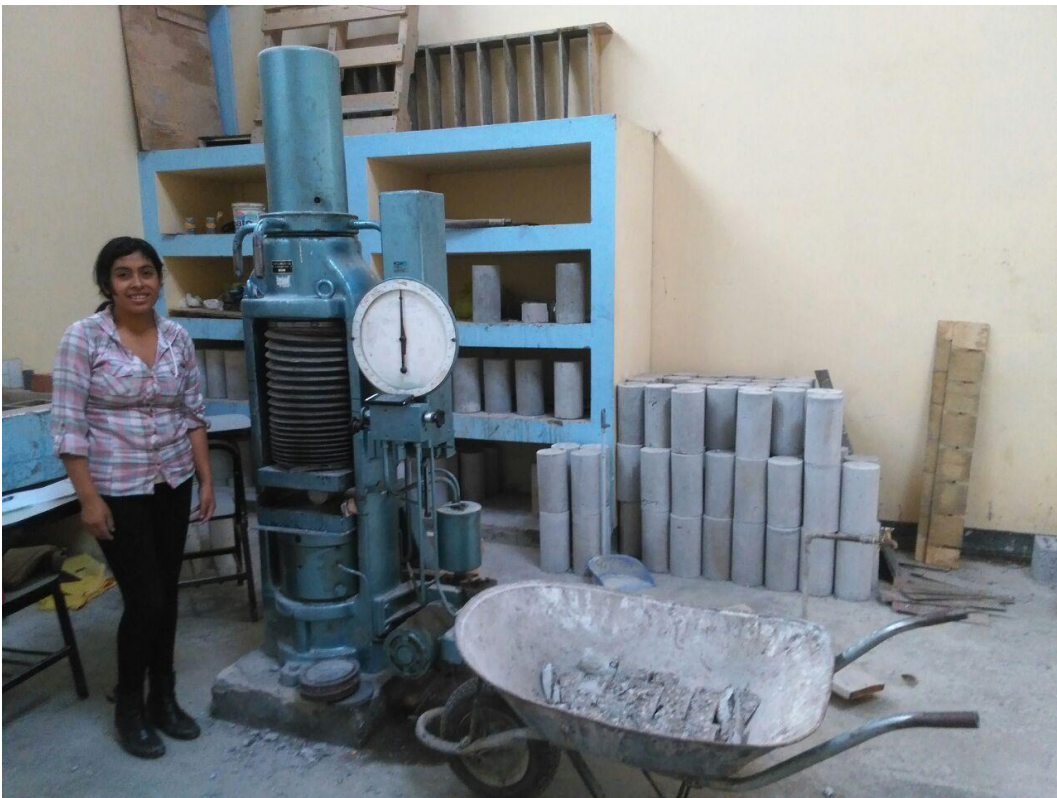
Imagen N° 23: Maquina para ensayos a compresión y tracción de probetas
