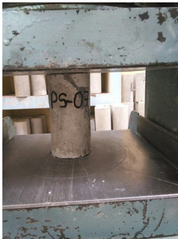
Imagen N° 16: Probetas con adhesivo Sikadur 32 Gel ensayadas a compresión
