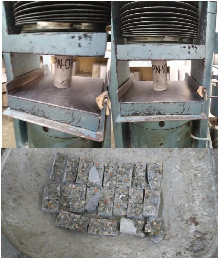
Imagen N° 24: Ensayos a compresión de probetas sin adhesivo epóxico
