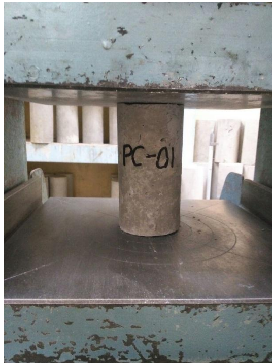
Imagen N° 15: Probetas con adhesivo Chema Epox Adhesivo 32 ensayadas a compresión
