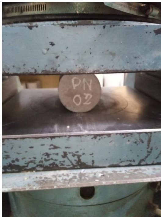
Imagen N° 17: Probetas sin adhesivo ensayadas a tracción
