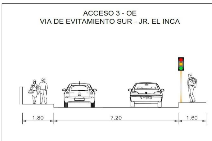
Figura 27. Sección de vía de acceso 3 – Intersección 4.
