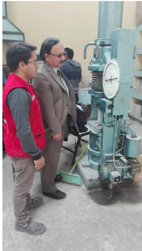
*Figura 59. Ensayo a compresión de las probetas de concreto.*
