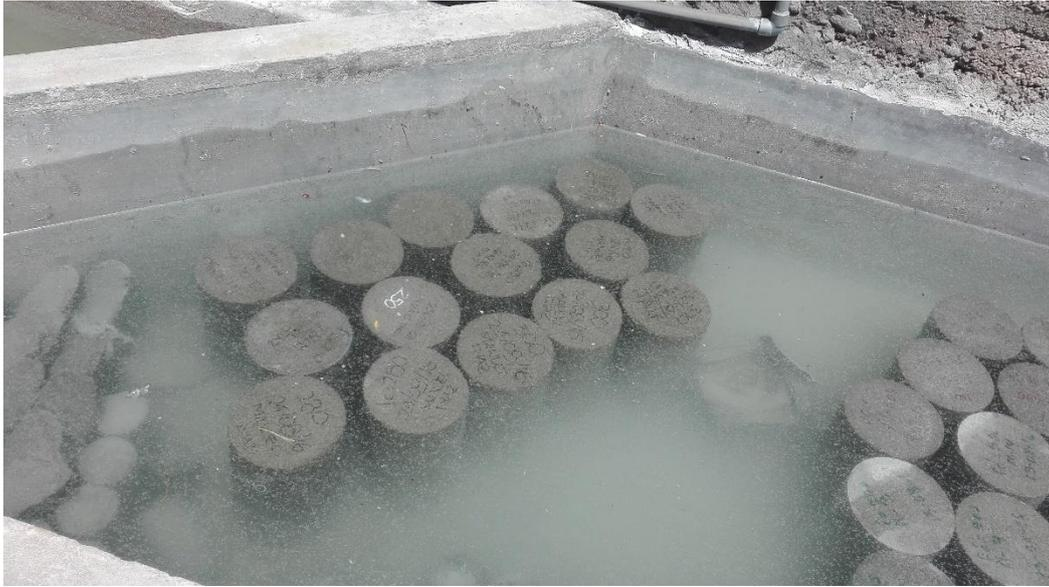
*Figura 58. Curado de las probetas.*
