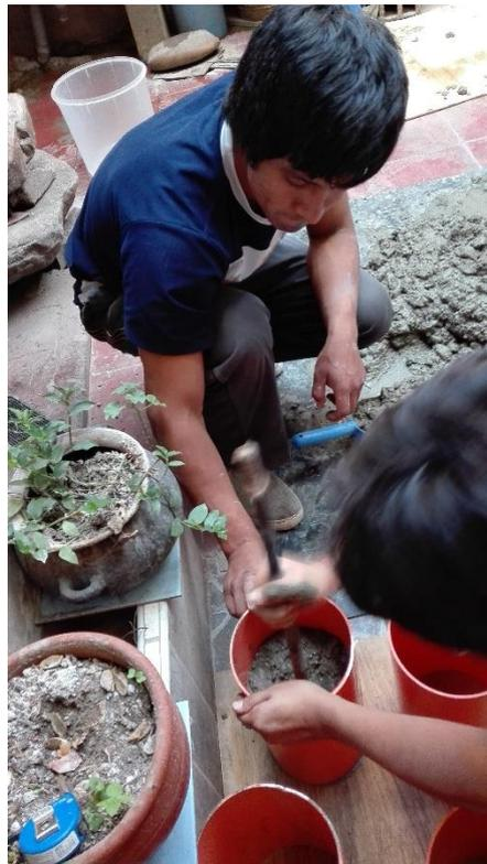
*Figura 55. Varillado de la mezcla para su colocación en los moldes.*
