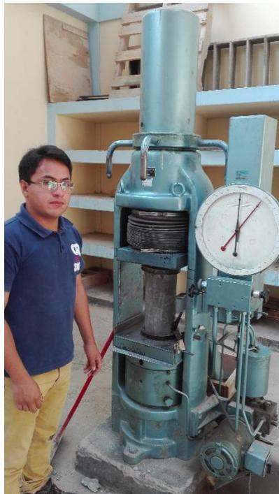
*Figura 21. Máquina Universal de Compresión.*
