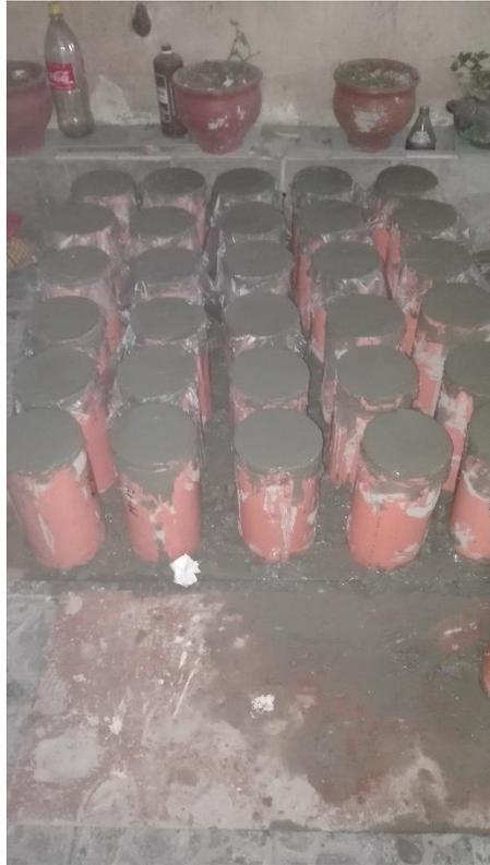
*Figura 56. Concreto fresco en moldes.*
