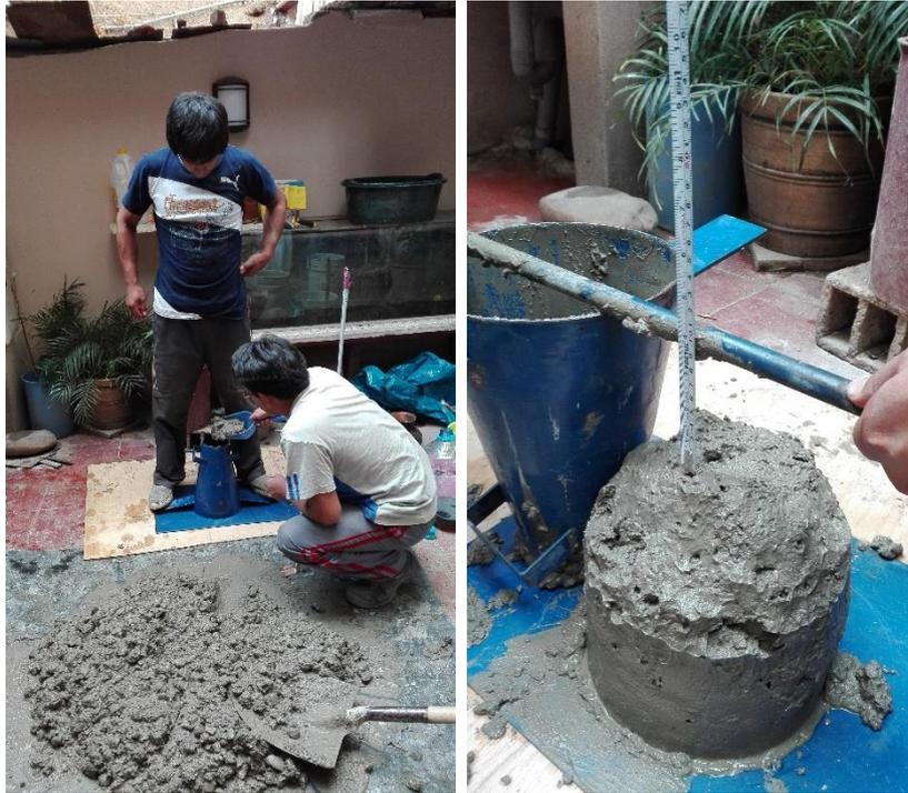
*Figura 54. Medición del Slump de la mezcla.*
