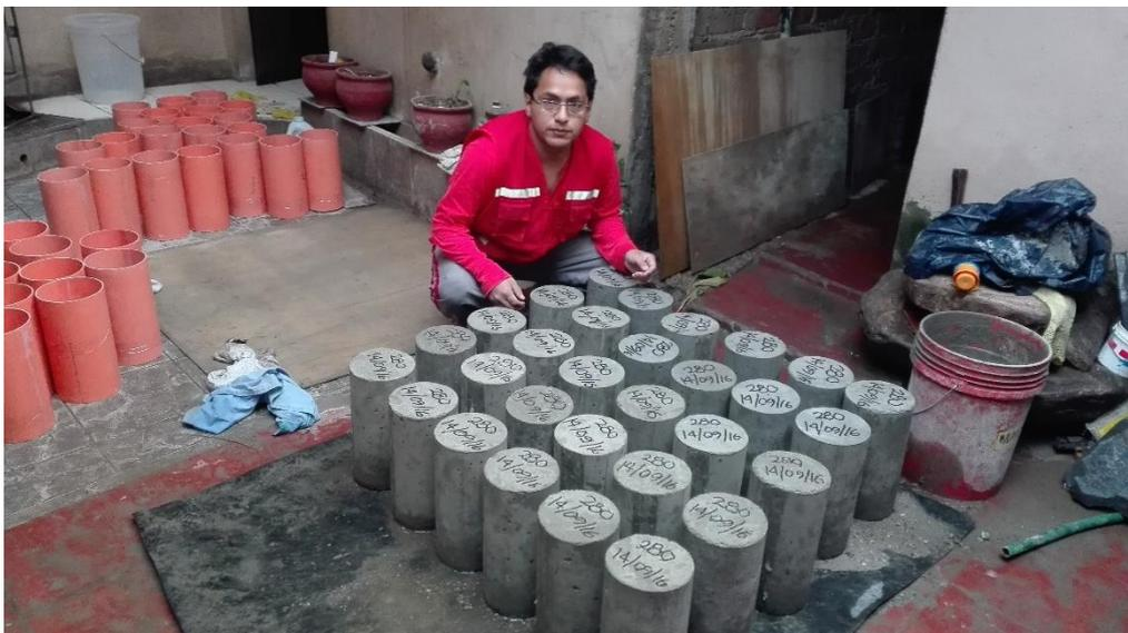
*Figura 57. Probetas cilíndricas de concreto 6" x 12".*
