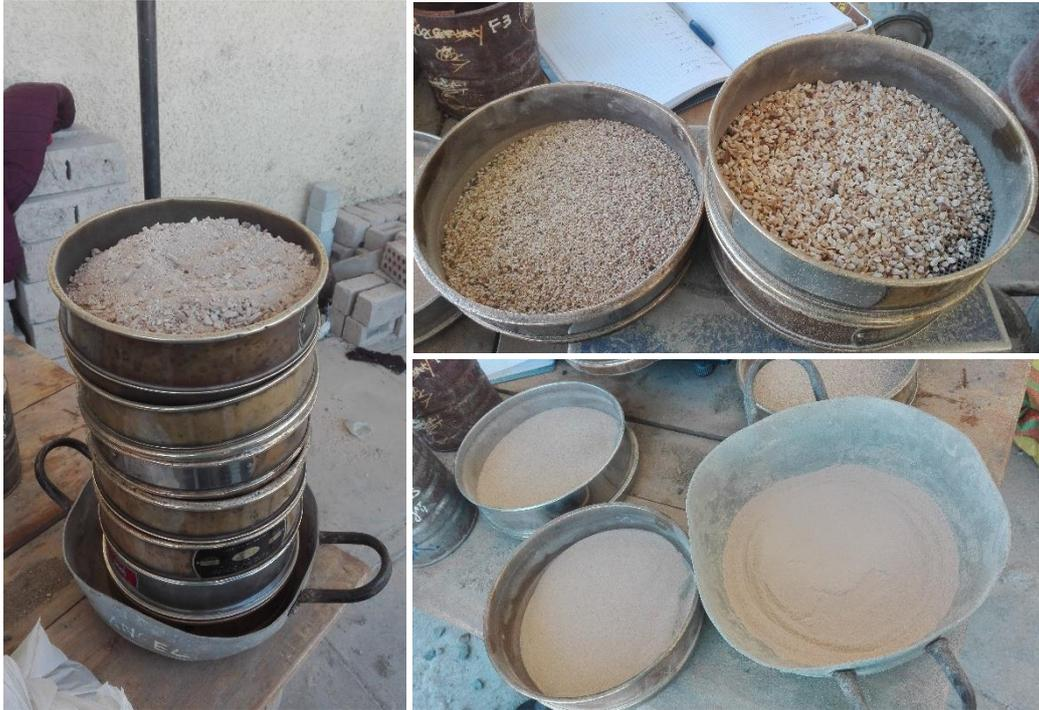
*Figura 52. Granulometría del Agregado Fino.*
