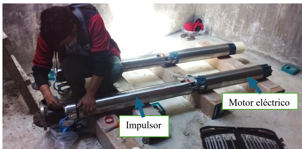
Figura 66 Componentes de bombas sumergibles
