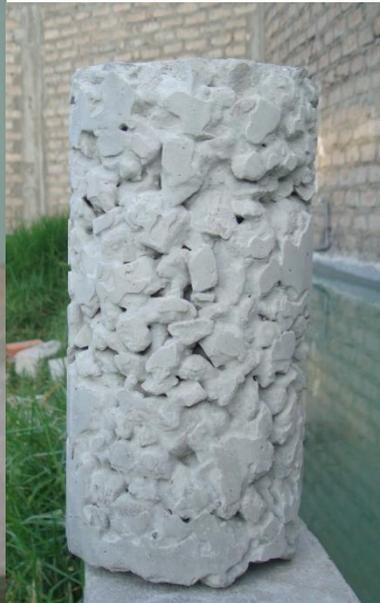
Imagen N° 23. Concreto permeable con aditivo plastificante Chemaplast.
