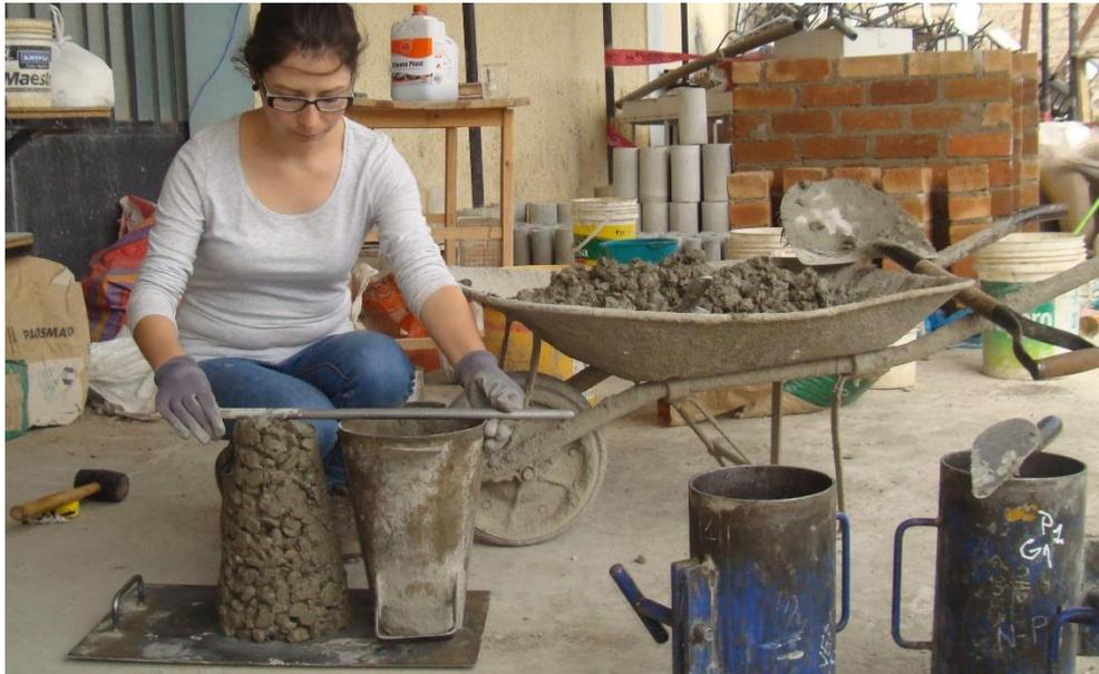
Imagen N° 11. Ensayo de asentamiento del concreto permeable.
