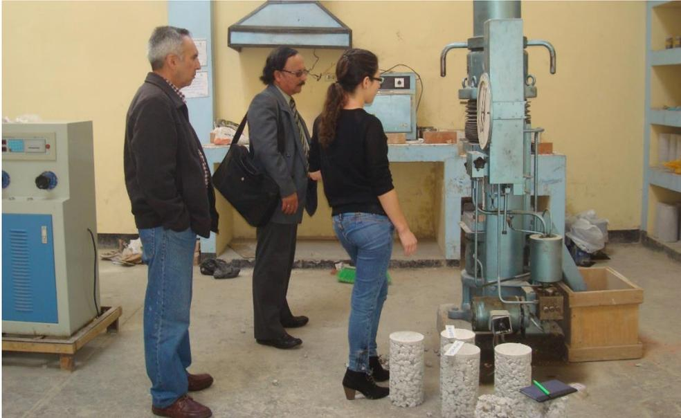
Imagen N° 26. Ensayo a compresión de especímenes que contienen “Chema fibra Ultrafina”.
