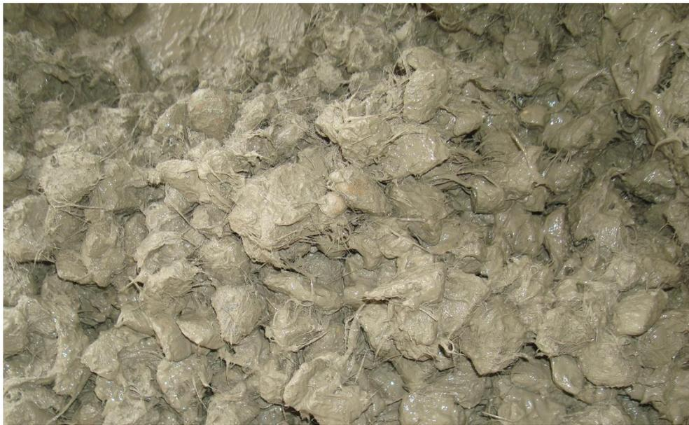
Imagen N° 24. Incorporación a la mezcla de “Chema fibra Ultrafina”.
