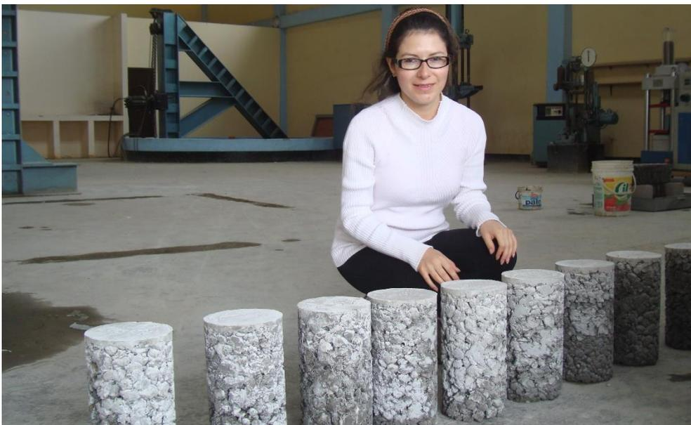
Imagen N° 25. Concreto endurecido con fibra y aditivo, curados 28 días.
