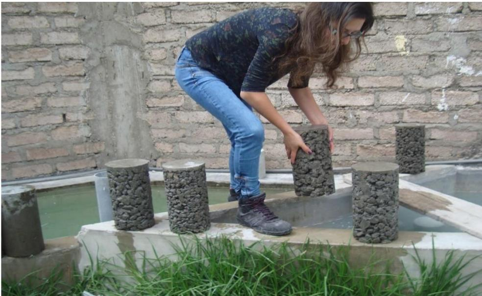
Imagen N° 10. Curado estándar del concreto permeable
