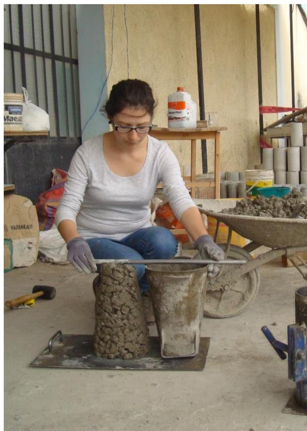
Imagen N° 22. Consistencia seca del concreto permeable.
