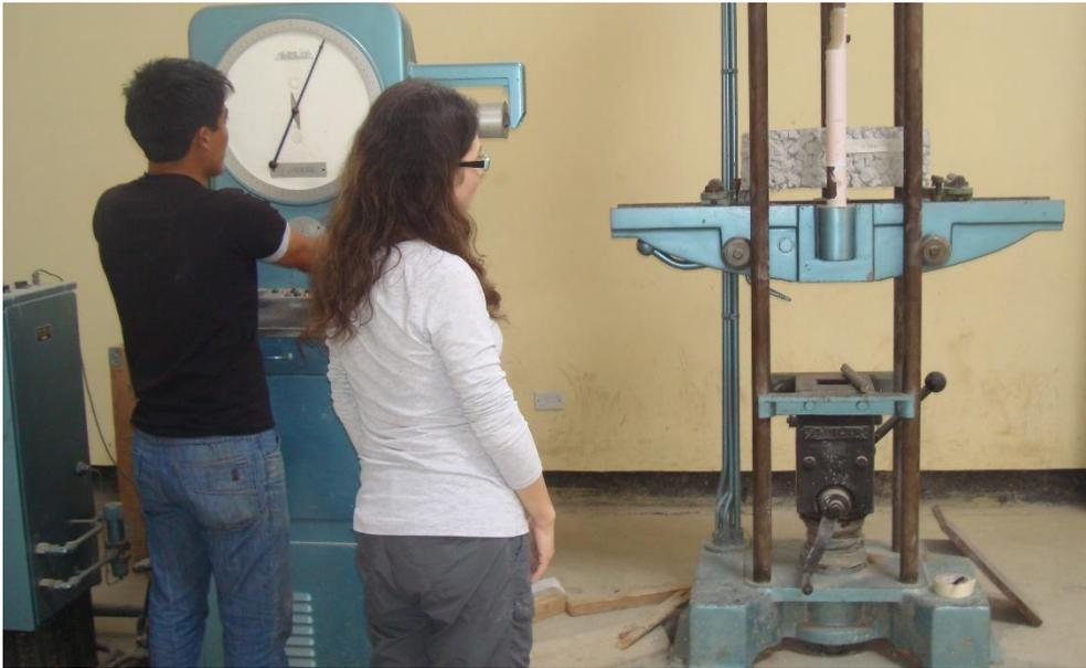
Imagen N° 29. Ensayo de flexión de especímenes de concreto permeable.
