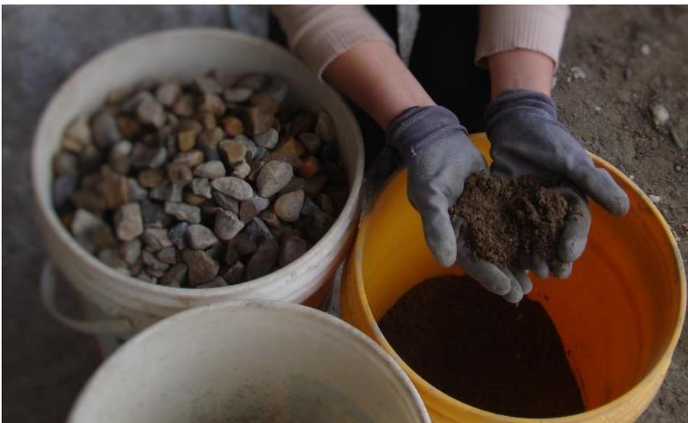
Imagen N° 3. Agregado fino utilizado en diseños de mezcla
