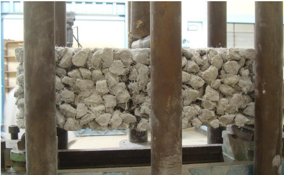
Imagen N° 30. Especimen después de ser sometido a esfuerzo de flexión.
