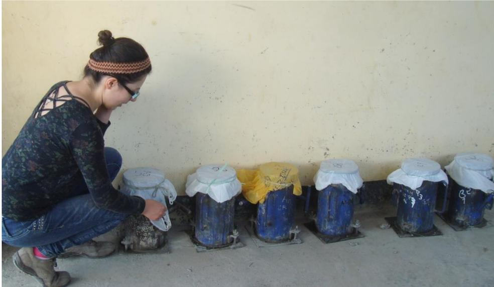
Imagen N° 9. Curado inicial del concreto permeable
