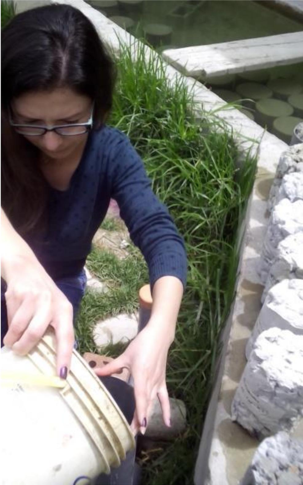
Imagen N° 18. Ejecución de ensayo de permeabilidad.
