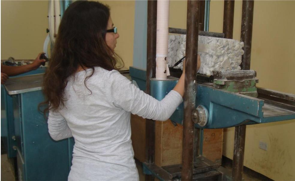
Imagen N° 15. Ensayo a flexión de especímenes de concreto permeable.
