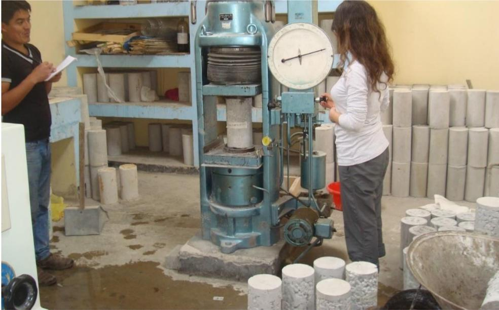
Imagen N° 14. Medición de las deformaciones de los especímenes de concreto permeable.
