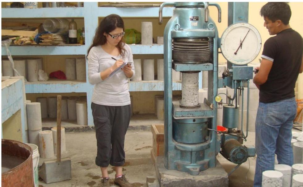
Imagen N° 27. Ensayo a compresión.
