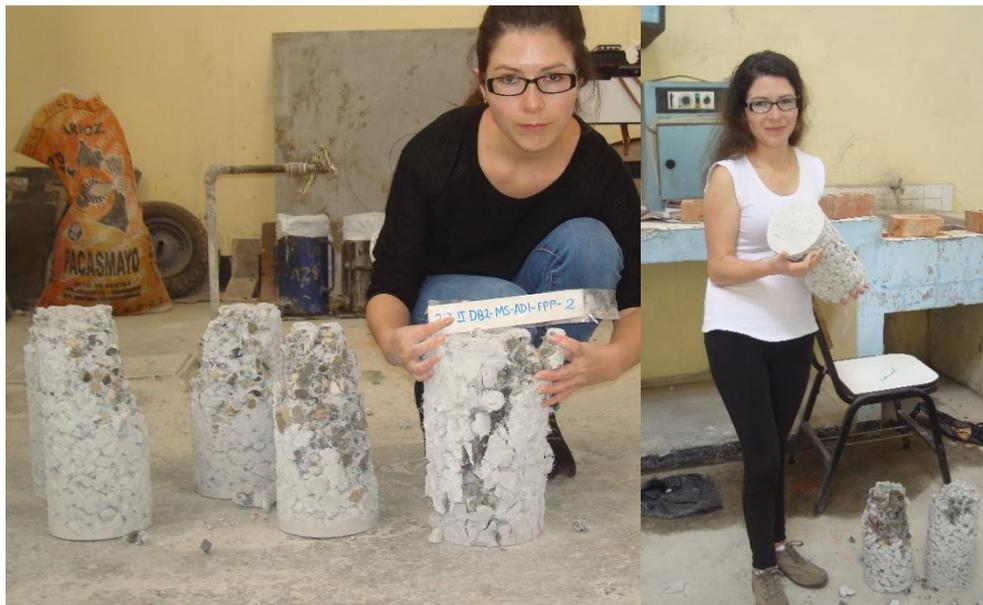
Imagen N° 13. Verificación del tipo de fractura en los especímenes de concreto permeable.
