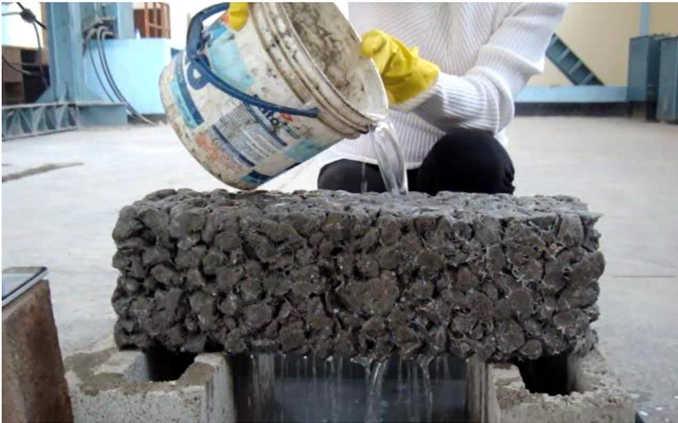
Imagen N° 31. Permeabilidad en especimen de concreto permeable.
