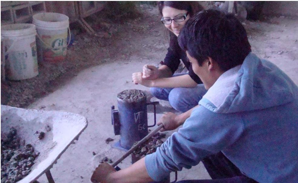
Imagen N° 7. Elaboración de especímenes cilíndricos de concreto permeable
