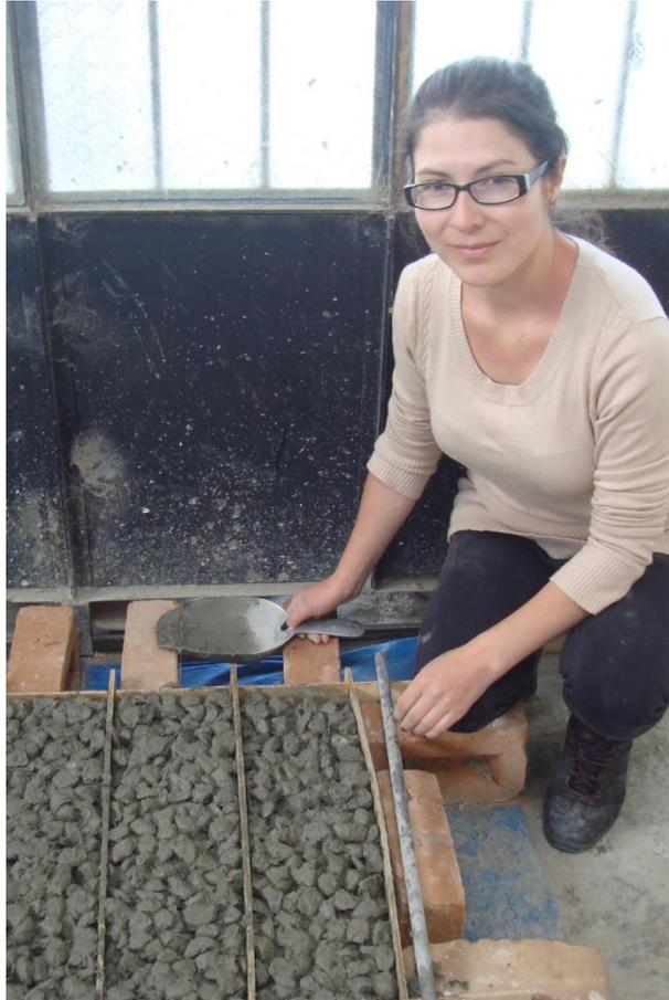
Imagen N° 8. Elaboración de especímenes prismáticos de concreto permeable
