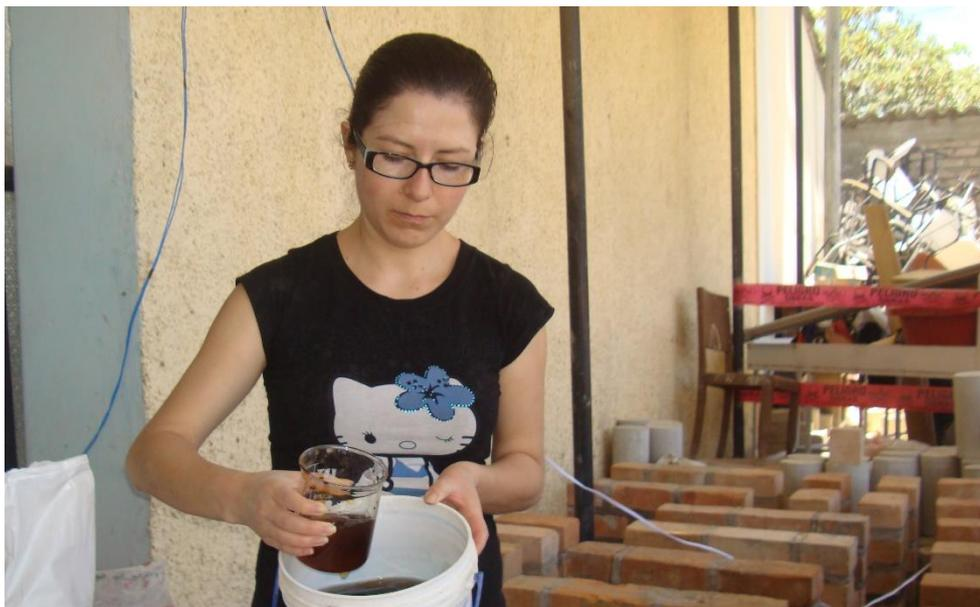
Imagen N° 21. Aditivo Chemaplast, incorporado en el agua a los diseños de mezcla.
