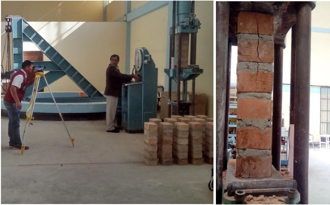
Fig. 46: Vista de los ensayos a compresión de las pilas de ladrillo artesanal de Bambamarca.
