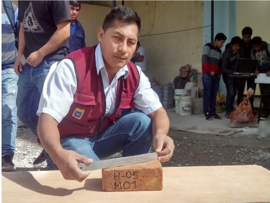
Fig. 35: Vista de los ensayos de variación dimensional y alabeo del ladrillo artesanal de Bambamarca
