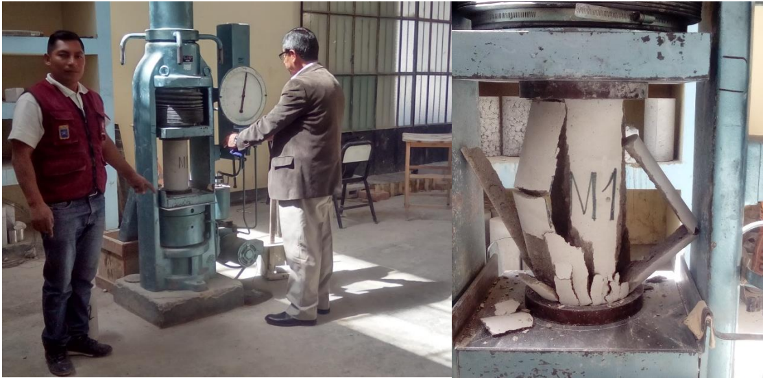
Fig. 42: Vista del ensayo a compresión simple de los especímenes de mortero
