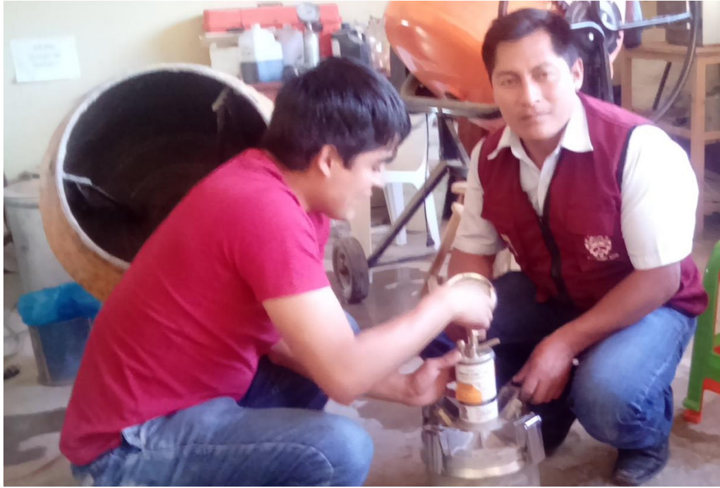
Fig. 40: Vista de la comprobación del aire atrapado en el mortero, en la olla de Washington
