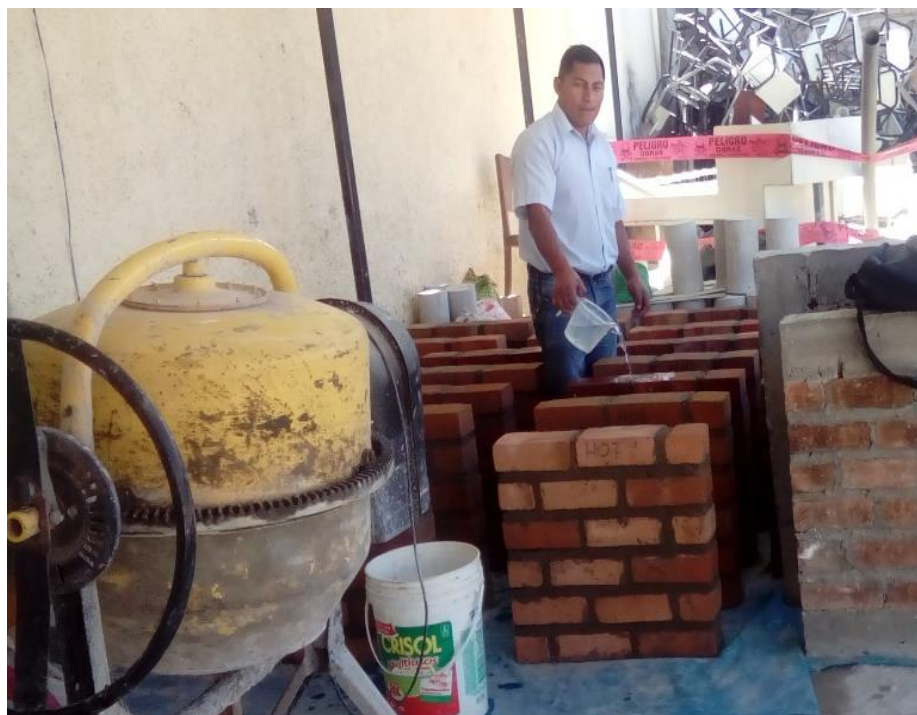
Fig. 44: Vista del curado de pilas y muretes de ladrillo artesanal de Bambamarca.
