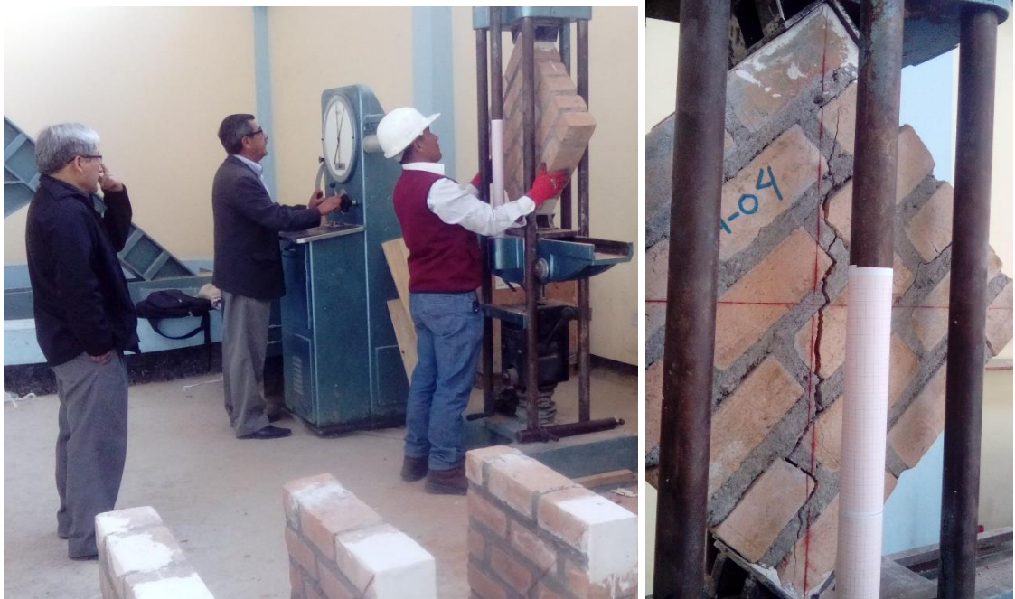
Fig. 48: Vista de los ensayos al corte de los muretes de ladrillo artesanal de Bambamarca
