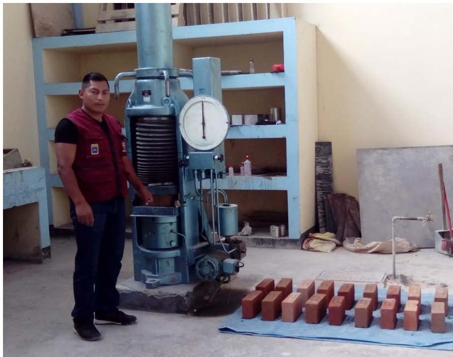
Fig. 36: Vista de los ensayos a compresión simple del ladrillo artesanal de Bambamarca
