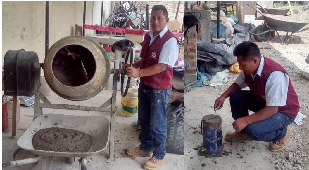
Fig. 41: Vista del mezclado de materiales y elaboración de los especímenes de mortero
