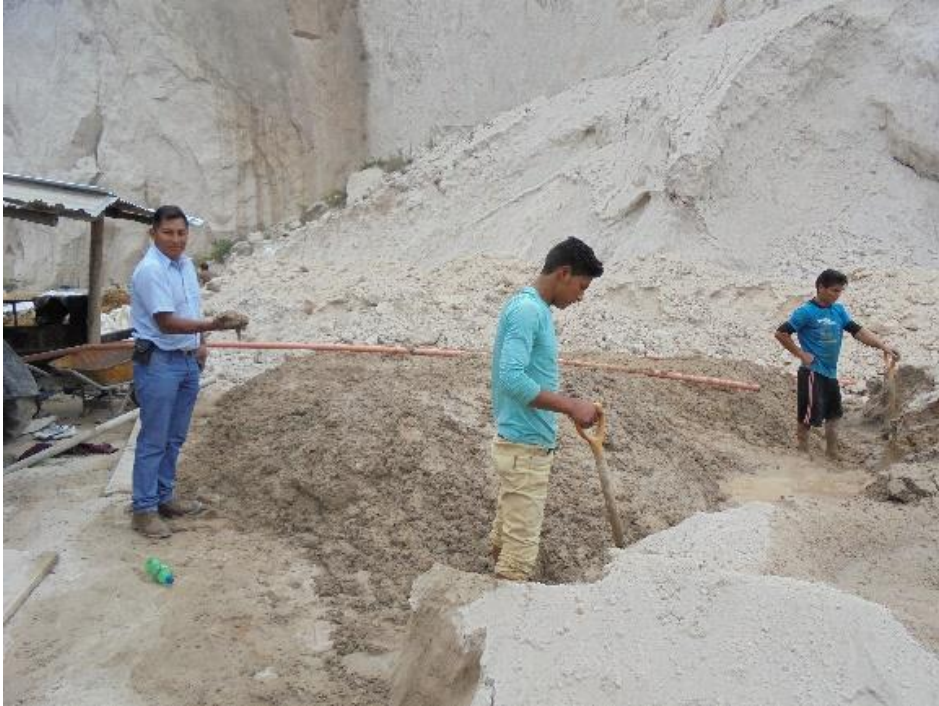
Fig. 30: Vista de la preparación del material para el ladrillo artesanal de Bambamarca
