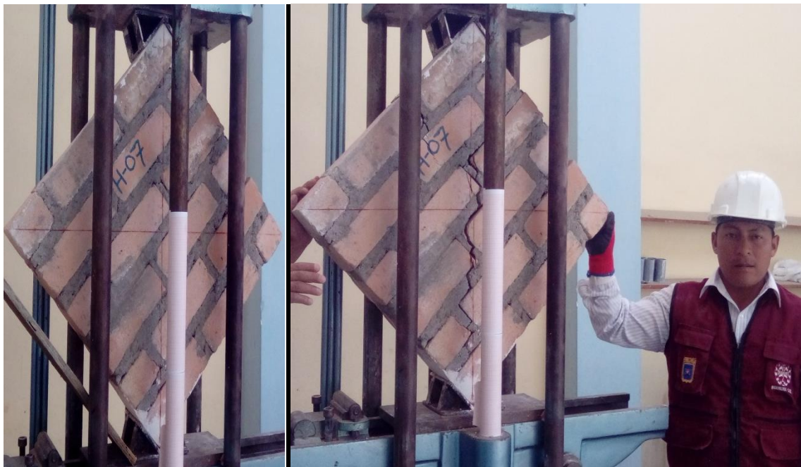
Fig. 47: Vista de los ensayos al corte de los muretes de ladrillo artesanal de Bambamarca
