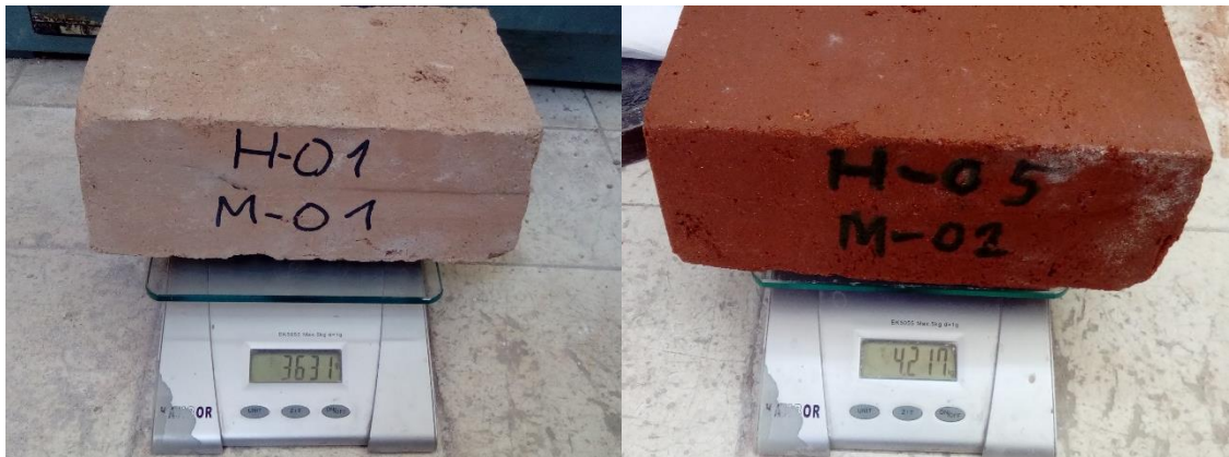
Fig. 37: Vista de los ensayos de absorción del ladrillo artesanal de Bambamarca
