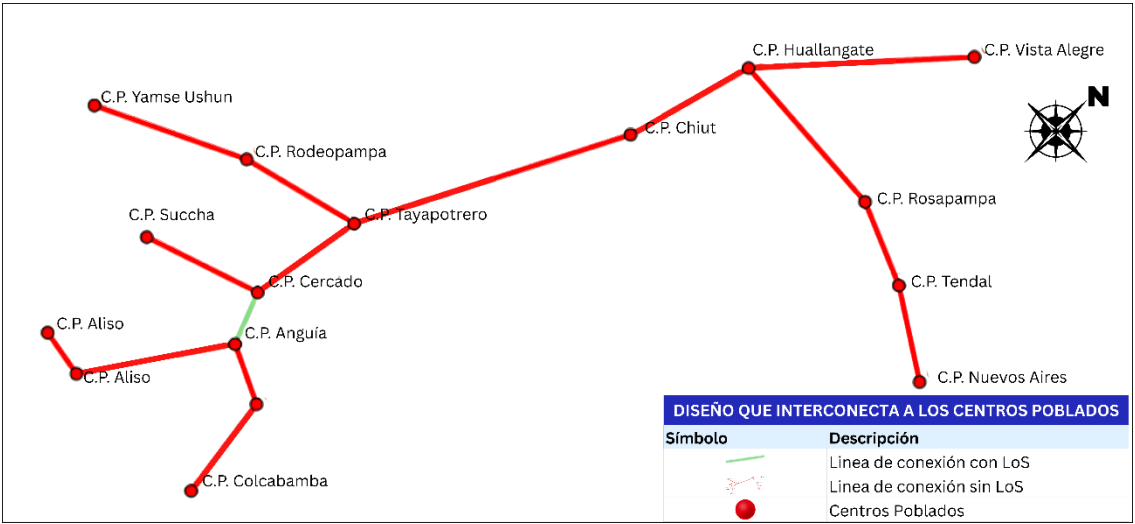
Fig. 9. Diseño que interconecta los centros poblados sin línea de vista.
