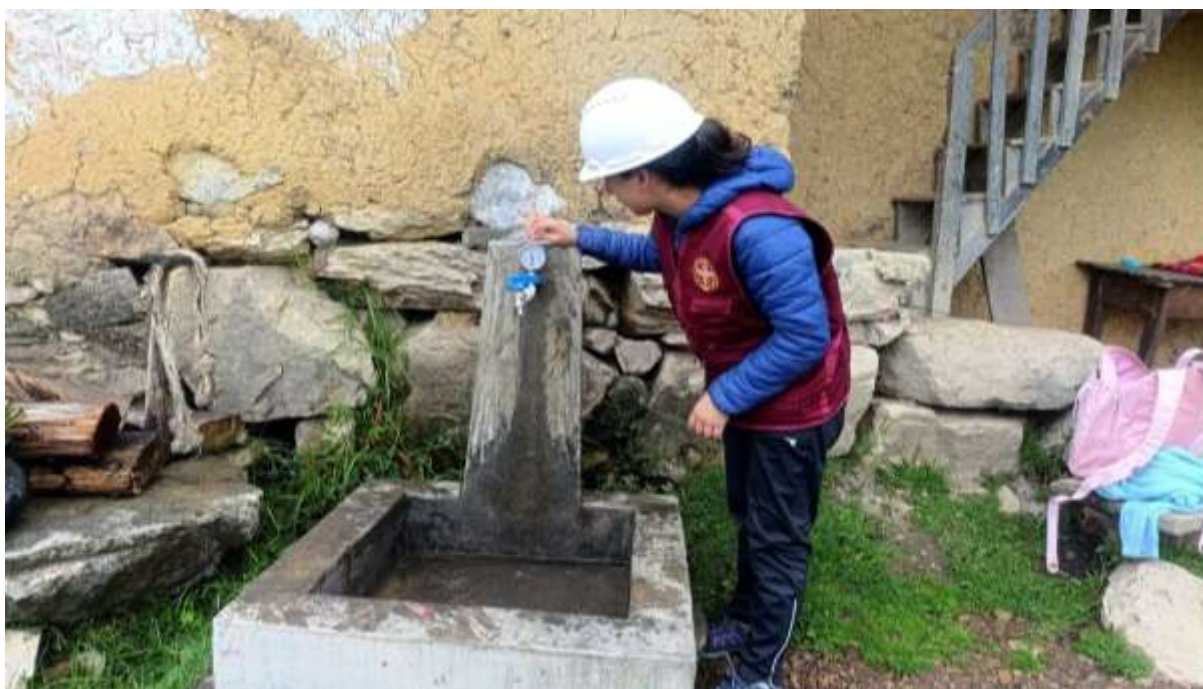
Fotografía 8. Aforo de agua en la captación del manantial Alto Pingullo
