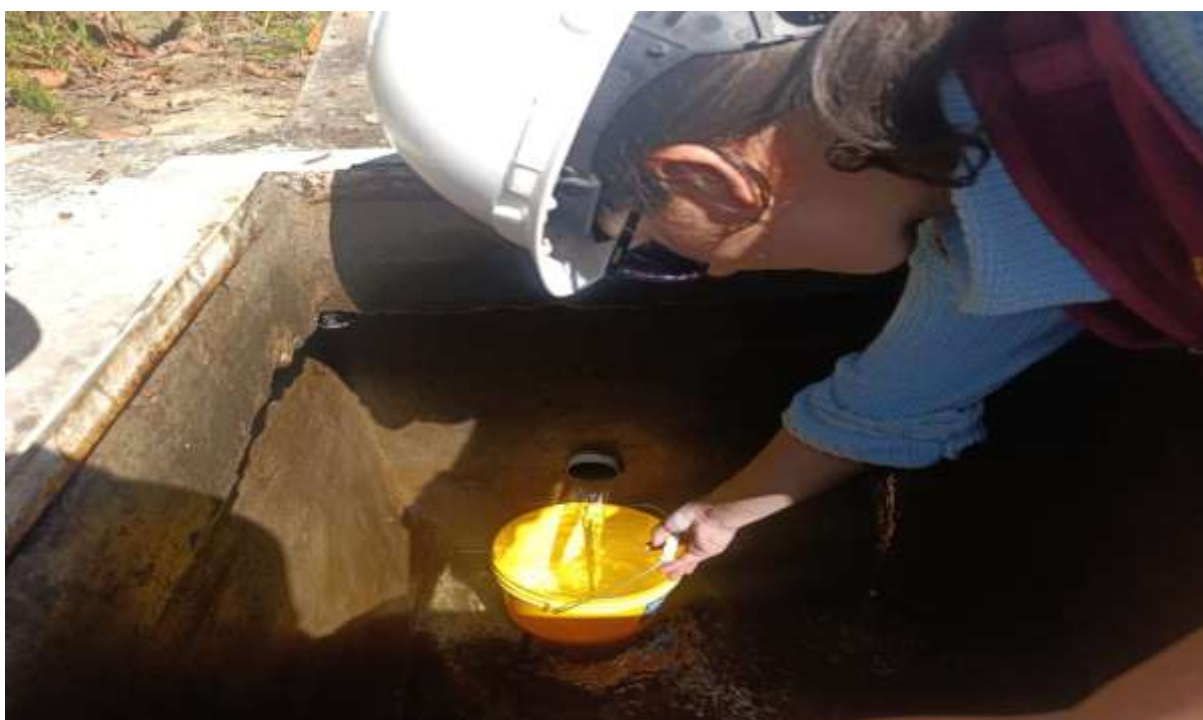
Fotografía 8. Aforo de agua en la captación del manantial Alto Pingullo
