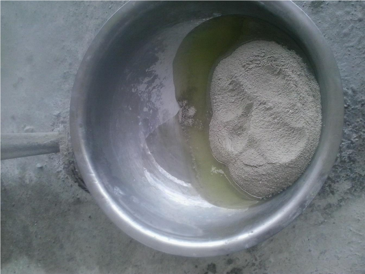
Imagen N° 23: Mezcla de los tres componentes para obtener el mortero epóxico
