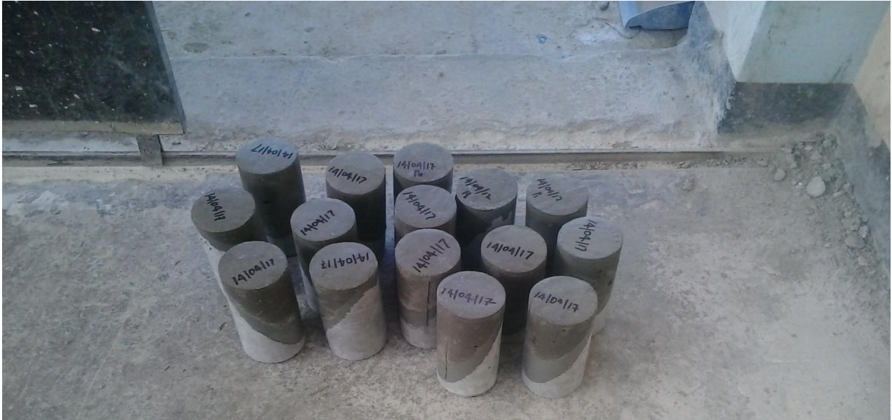
Imagen N° 25: Obtención del concreto en estado endurecido con unión de mortero epóxico en diferentes edades.
