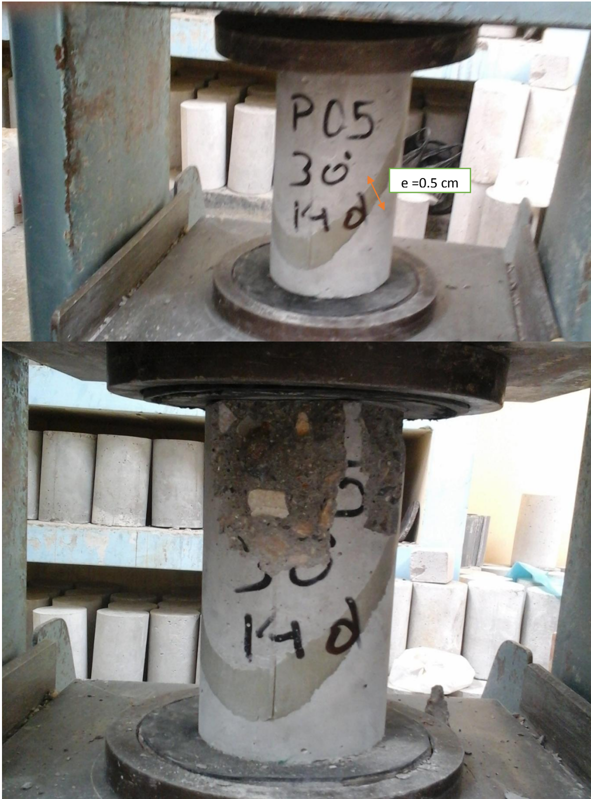
Imagen N°27: Rotura de los especímenes de 30° unidos con mortero epóxico
