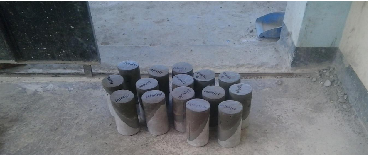
Imagen N° 24: Obtención del concreto en estado endurecido con unión de mortero epóxico
