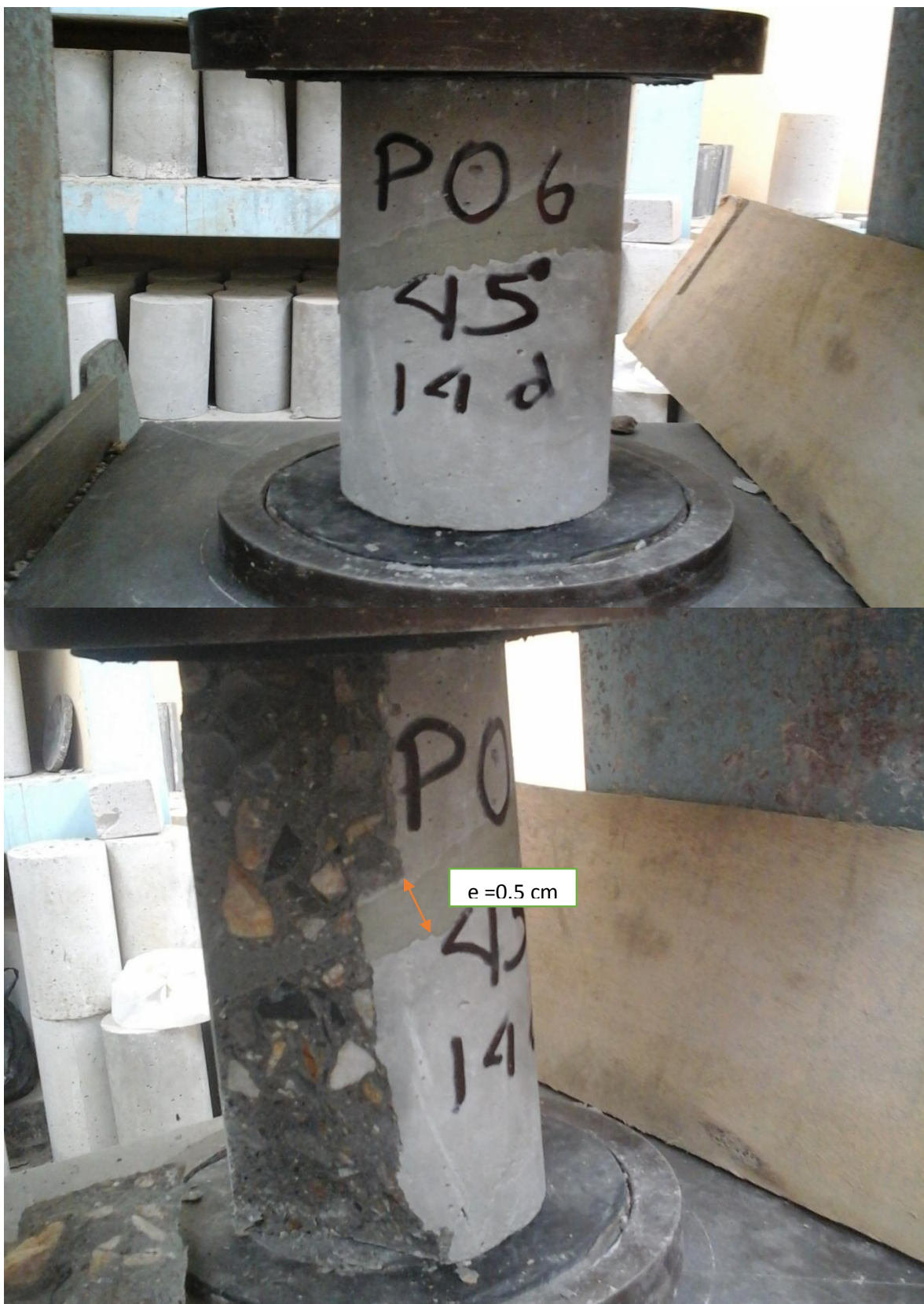
Imagen N° 28: rotura de los especimenes de 45° unidos con mortero epóxico
