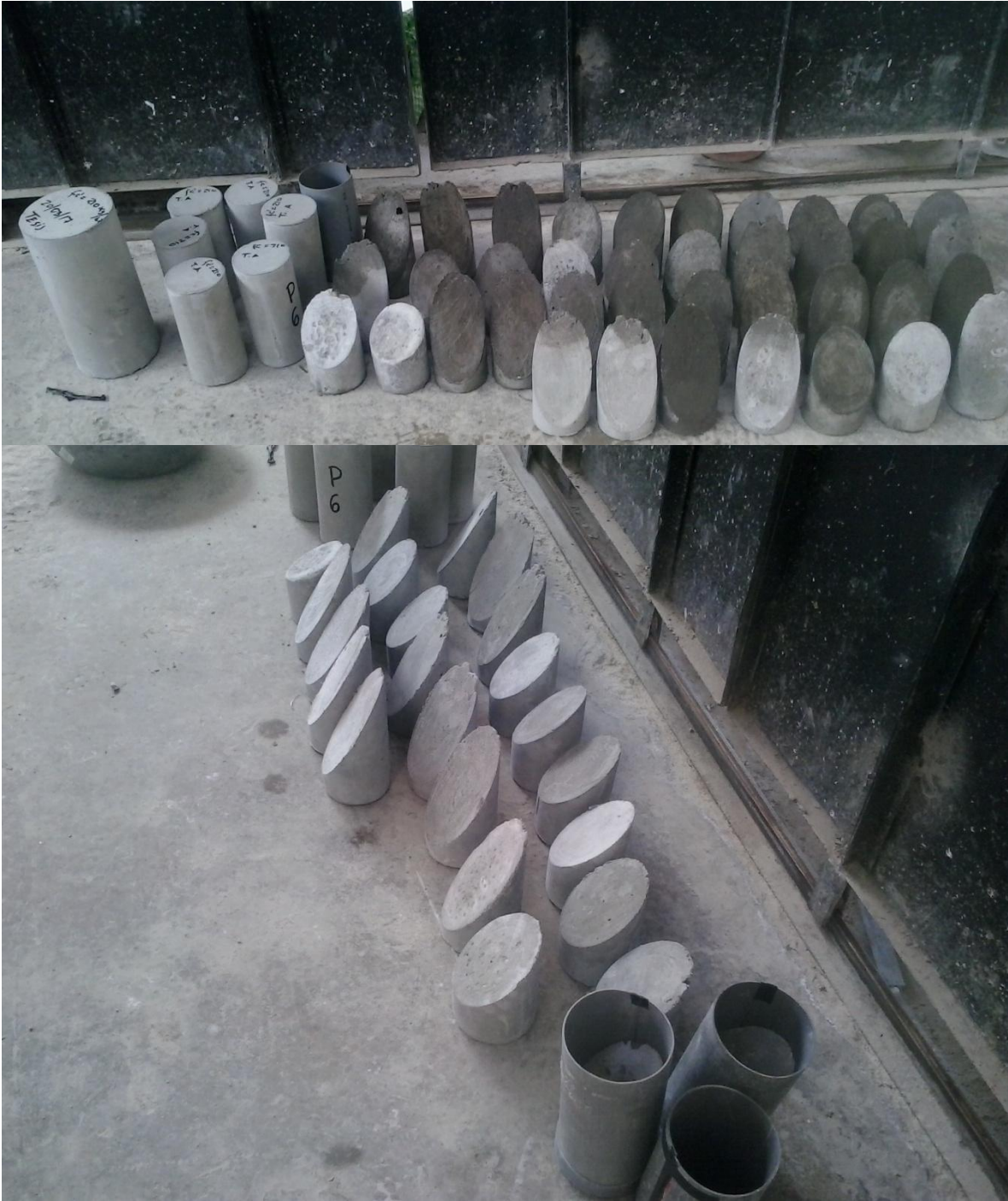
Imagen N° 18: Concreto en estado endurecido con ángulos de 30° y 45°
