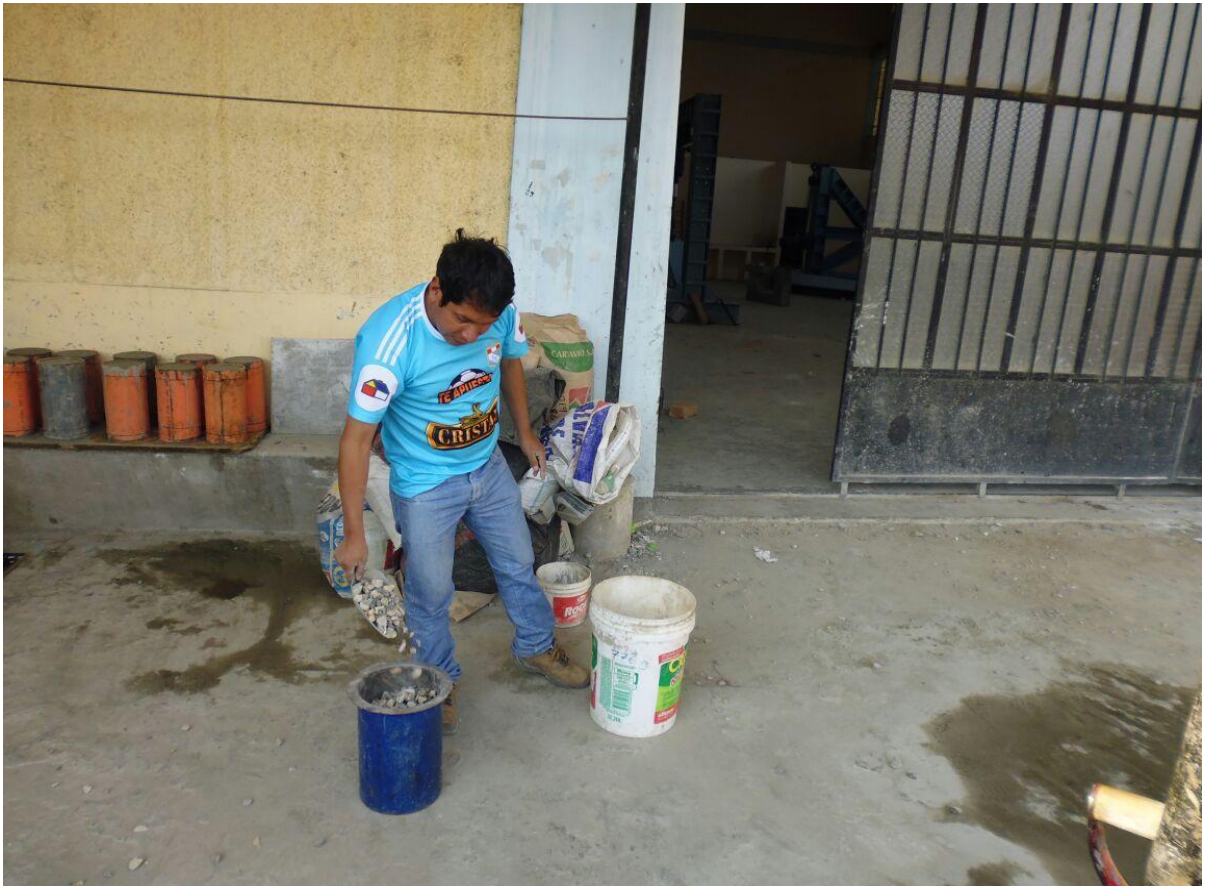
Imagen N° 11: Peso Unitario Seco Suelto del agregado
