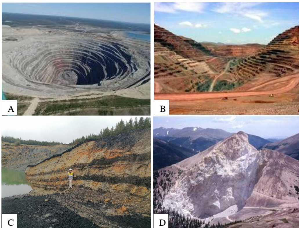
Figura 2.2. A. Tajo abierto, B. Fosa abierta, C. Explotación en tiras y D. explotación combinada.
