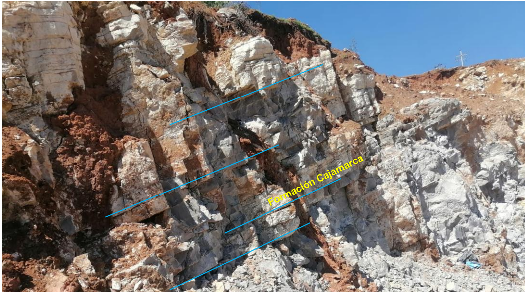
Figura 3.11. Estratos subhorizontales de roca de la Formación Cajamarca, cubiertos por Depósitos Deluviales de espesor 1.50 m.
