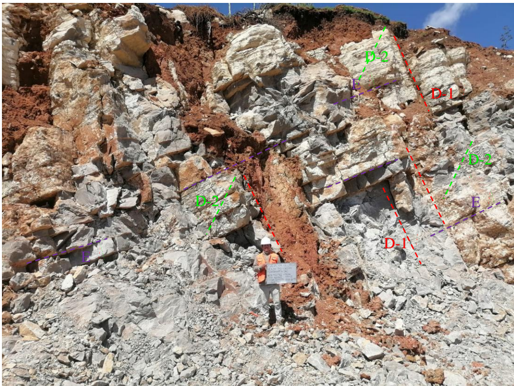
Figura 3.13. Estación geomecánica EG-01 compuesto de roca caliza de calidad regular, con \sigma_{ci} = 150 MPa., ubicado en la segunda banqueta del flanco izquierdo del tajo producción.
