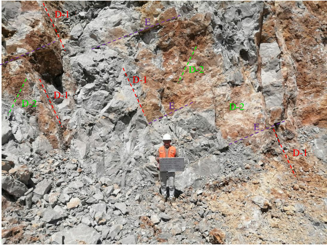
Figura 3.14. Estación geomecánica EG-02 compuesto de roca caliza de calidad buena, con \sigma_{ci} = 175 MPa., ubicado en la segunda banqueta del centro del tajo producción.
