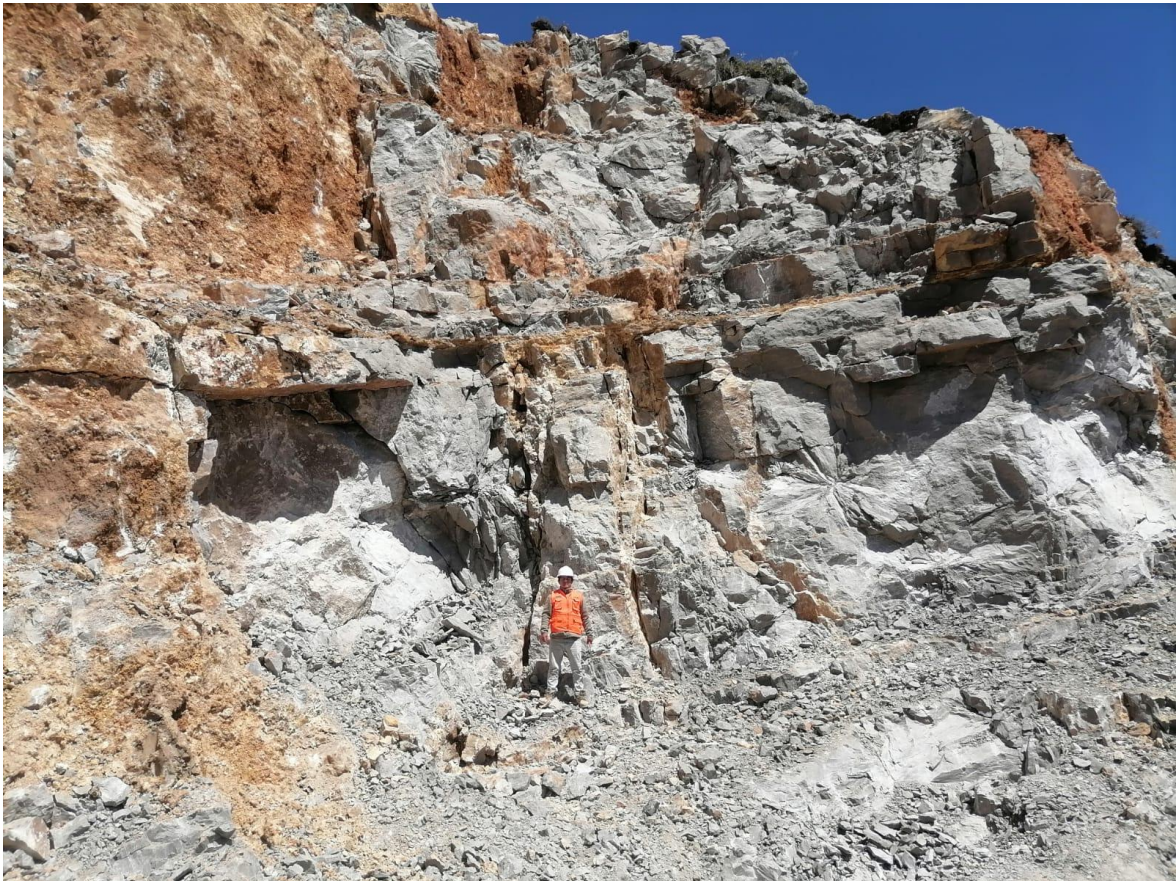
Figura 3.9. Cantera de la calera Bambamarca S.A.C., constituido por estratos de caliza de la Formación Cajamarca, con patinas de óxidos en la superficie de la roca.
