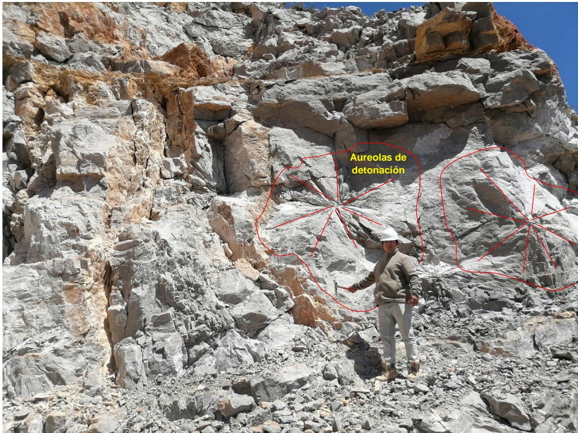
Figura 3.10. Visualización de las aureolas radiales desde: 0.50 m. a 0.65 m. por la detonación de explosivos, para la fragmentación de la roca caliza.
