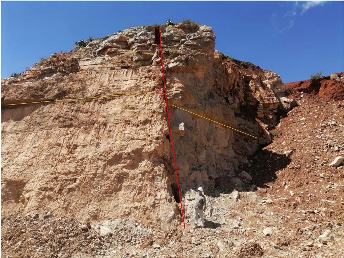
Figura 3.7. Falla normal sinistral de apertura 0.20 m. a 0.40 m., con Az/Bz = N224°/74°NW, ubicada al sur del tajo.
