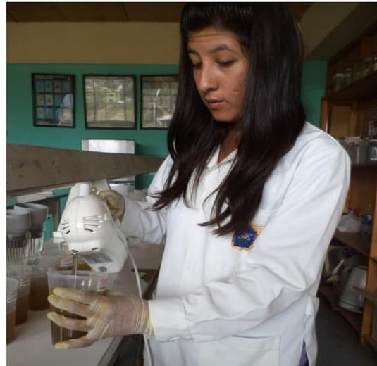
Figura 21. Homogenizar la muestra con batidora eléctrica aproximadamente 10 segundos.
