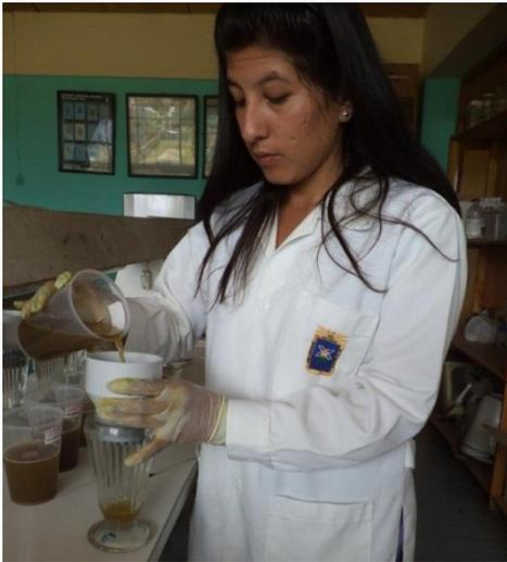
Figura 22. Pasar por un embudo con malla metálica de 80 hilos por pulgada hacia otro vaso de vidrio de forma cónica de 260 ml de capacidad, agregar agua hasta llenar a 1 cm del borde del vaso.
