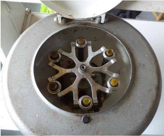
Figura 14. Centrifugar a 1500 rpm por 5 minutos.
