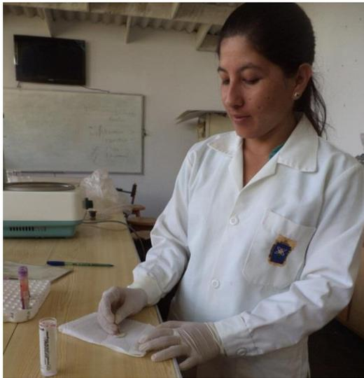
Figura 7. Sellado del tubo capilar heparinizado con plastilina
