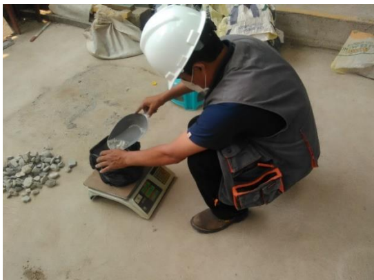
Figura 42 Peso del cemento para el espécimen sin aditivo
