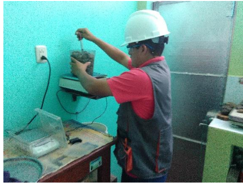
Figura 13 Peso de la muestra con superficie seca
