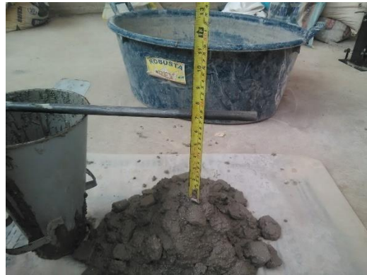
Figura 47 Slump del concreto con aditivo.
