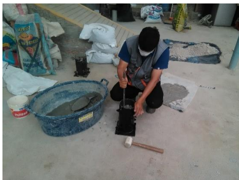
Figura 48 Chuseado del concreto con aditivo por cada capa.
