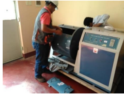
Figura 35 Colocando 5000g de Agregado Grueso en la máquina de los Ángeles para el ensayo de Abrasión.
