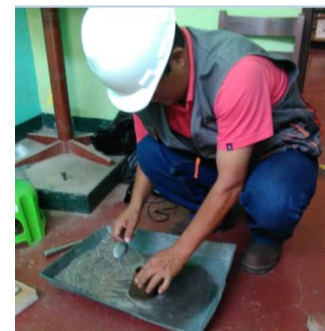
Figura 10 Arena con superficie seca
