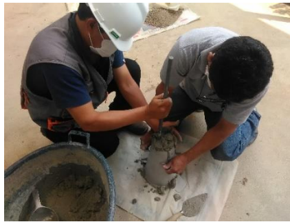
Figura 27 Preparación del espécimen Figura 28 Medición del asentamiento
