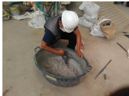
Figura 43 Mezclado de los agregados y el cemento espécimen sin aditivo
