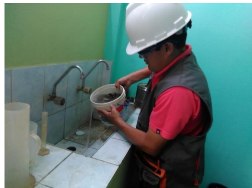
Figura 37 Muestra saturada de agregado grueso
