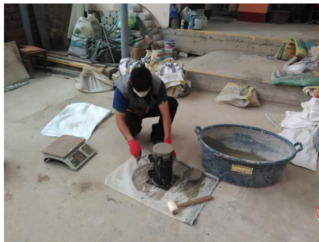
Figura 31 Retiro del exceso de mezcla
