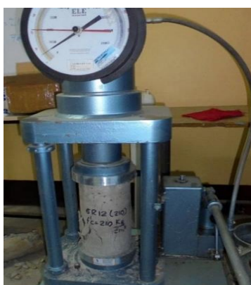
Figura 2 Rotura a carga axial de testigos de concreto
