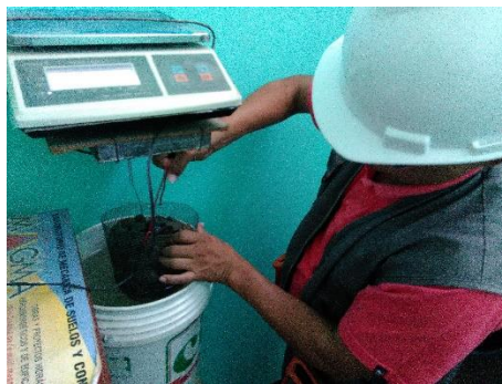
Figura 14 Peso de la muestra sumergida en agua
