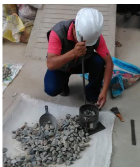
Figura 18 Compactado de muestra Piedra chancada
