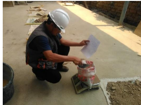
Figura 41 Peso del agregado fino para el espécimen sin aditivo
