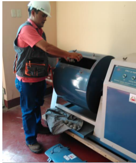
Figura 24 Colocando las esferas dentro de la tolva de la máquina.
