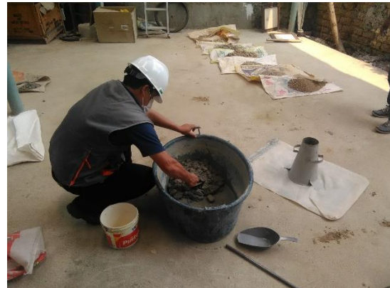
Figura 45 Mezcla de los agregados y el agua
