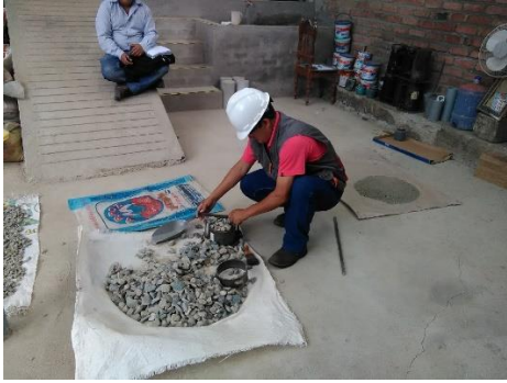
Figura 38 Peso unitario suelto del agregado grueso
