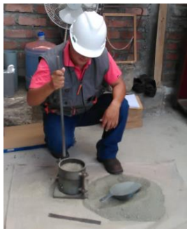
Figura 16 Compactado de muestra Arena
