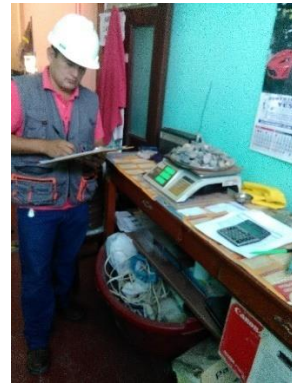
Figura 39 Peso del agregado grueso para el tamizado
