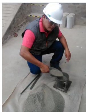
Figura 22 Compactado de muestra Arena
