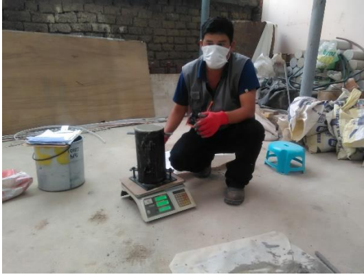
Figura 50 rasado del espécimen de concreto con aditivo
