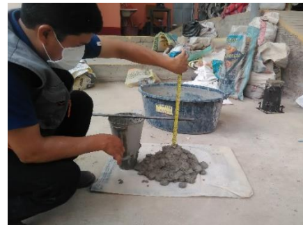
Figura 27 Preparación del espécimen Figura 28 Medición del asentamiento
