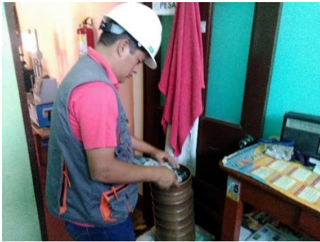
Figura 40 tamizado del agregado grueso.
