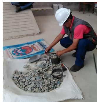
Figura 21 Enrasado de la superficie de la muestra
