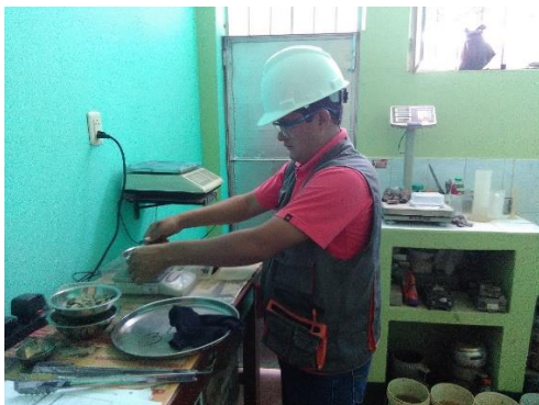
Figura 36 Pesado la muestra para el contenido de humedad.
