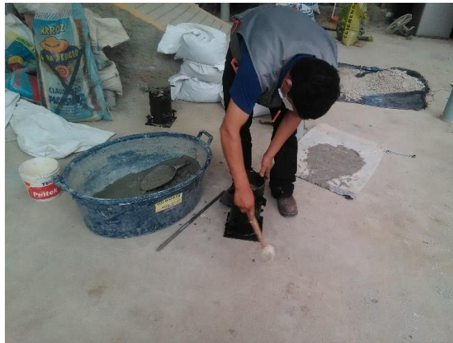
Figura 30 Eliminación de aire en el espécimen
