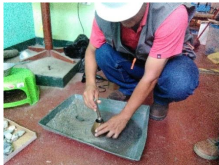
Figura 9 Prueba de absorción del agregado fino
