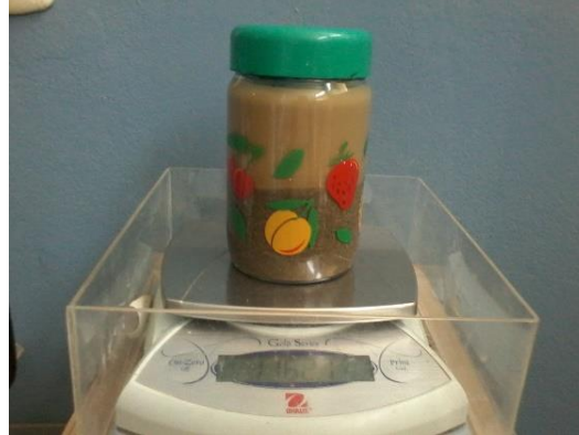
Figura 11 Peso del picnómetro + peso de la muestra + agua
