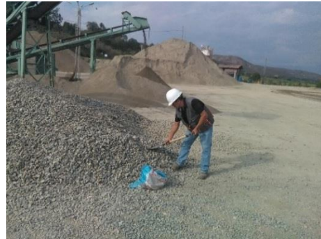
Figura 33 Extracción de muestras de Agregado grueso
