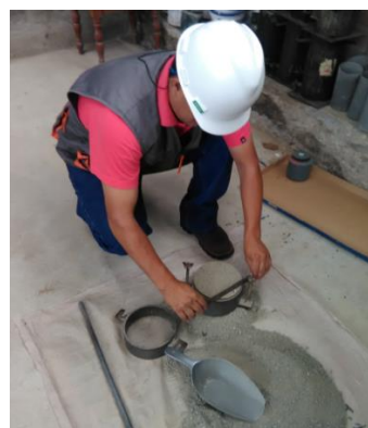
Figura 23 Enrasado de muestra
