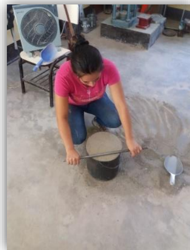
Imagen 13. ENRASADO DE LA SUPERFICIE DE LA MUESTRA
