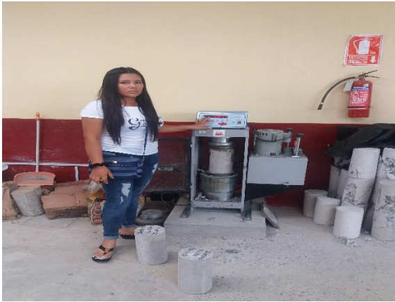
Imagen 45. RUPTURA DE LOS TESTIGOS DE COMPROBACION DE DISEÑO DE MEZCLA DE CONCRETO SOMETIDOS A CARGA AXIAL
