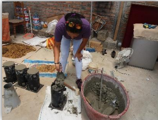
Imagen 21. COLOCAR EL CONCRETO EN LOS MOLDES
