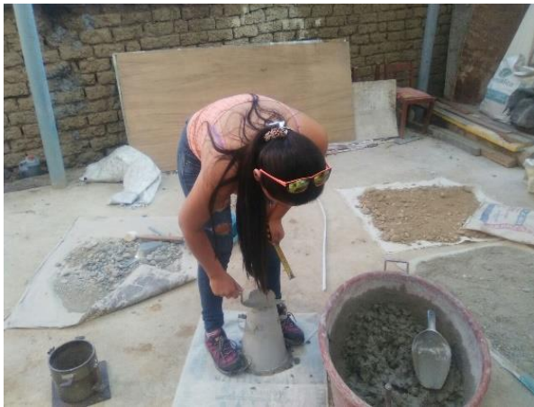
Imagen 36. ENRASADO DEL CONO DE ABRAMS
