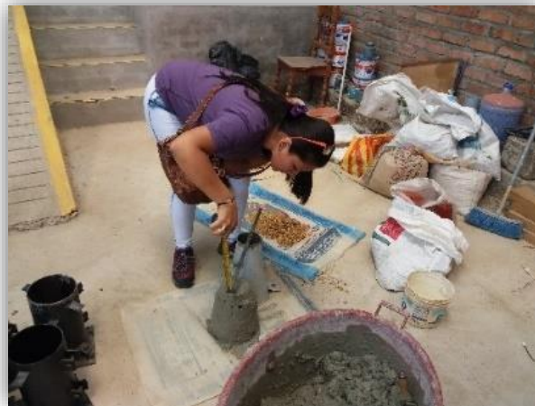
Imagen 20. MEDICION DEL ASENTAMIENTO
