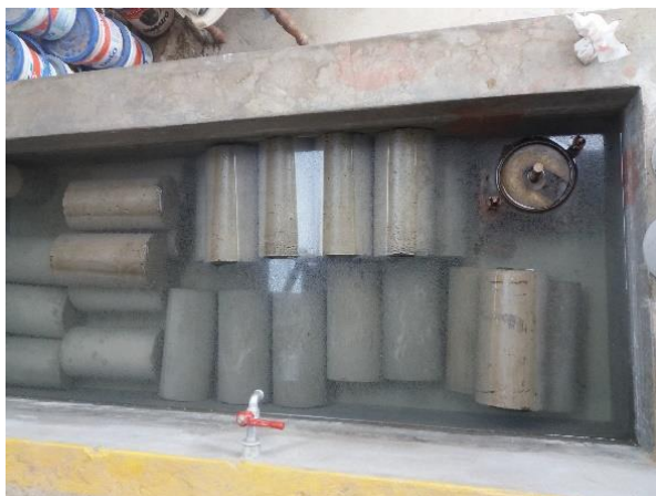
Imagen 42. CODIFICACION DE TESTIGOS ANTES DE SER LLEVADAS AL CURADO
