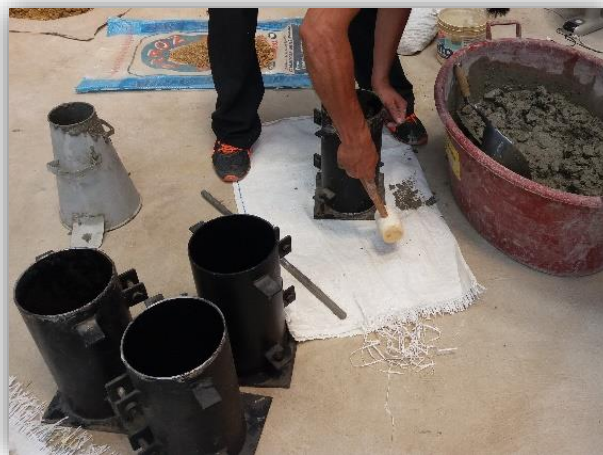
Imagen 23. ELIMINACION DE AIRE EN EL ESPECIMEN
