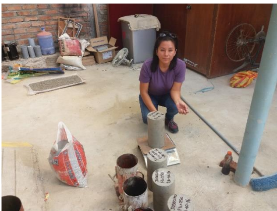
Imagen 49. PESO DEL CONCRETO ENDURECIDO
