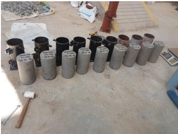
Imagen 42. CODIFICACION DE TESTIGOS ANTES DE SER LLEVADAS AL CURADO
