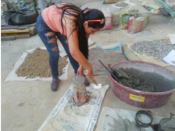
Imagen 40. ELIMINACION DE AIRE ATRAPADO UTILIZANDO LA COMBA DE GOMA
