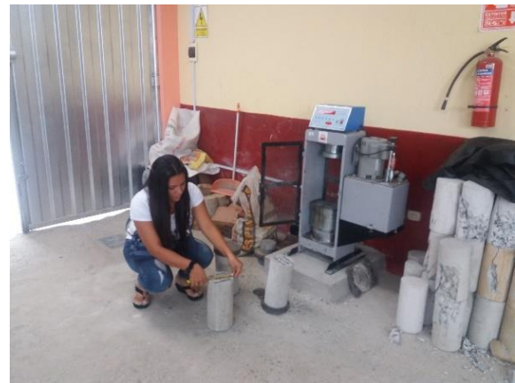
Imagen 41. MEDICION DEL DIAMETRO DE LAS PROBETAS ANTES DE SU RUPTURA
