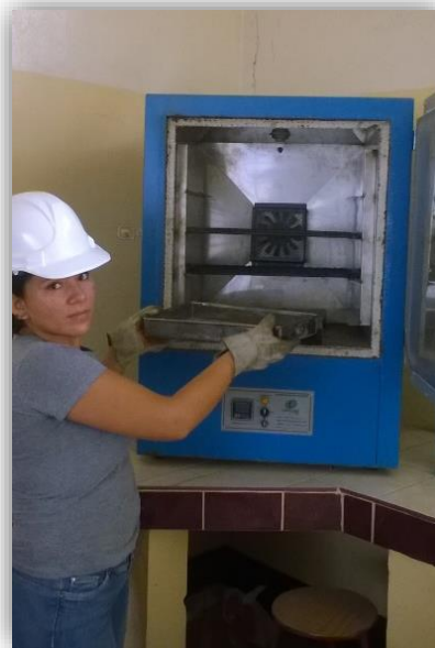
Imagen 16. SECADO DE LA MUESTRA EN HORNO
