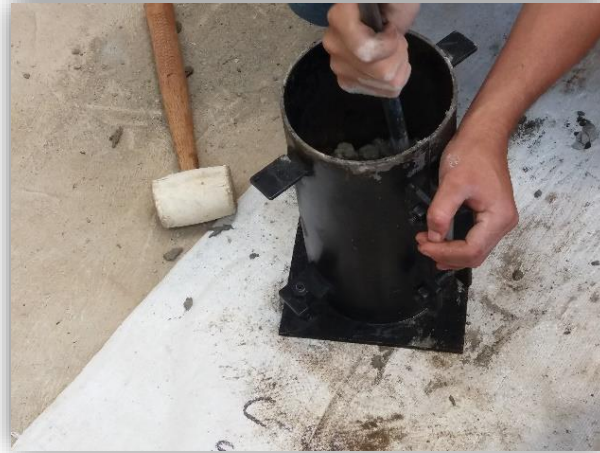
Imagen 22. COMPACTADO DE LOS ESPECIMENES DE CONCRETO
