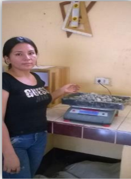
Imagen 14. PESO DE LA MUESTRA CON SUPERFICIE SECA
