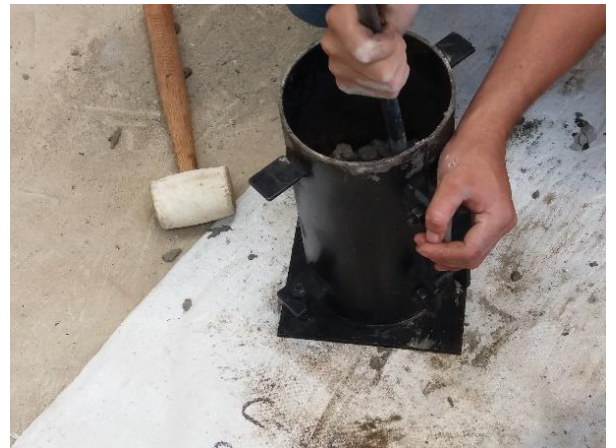
Imagen 38. COMPACTADO DE MEZCLA EN PROBETA
