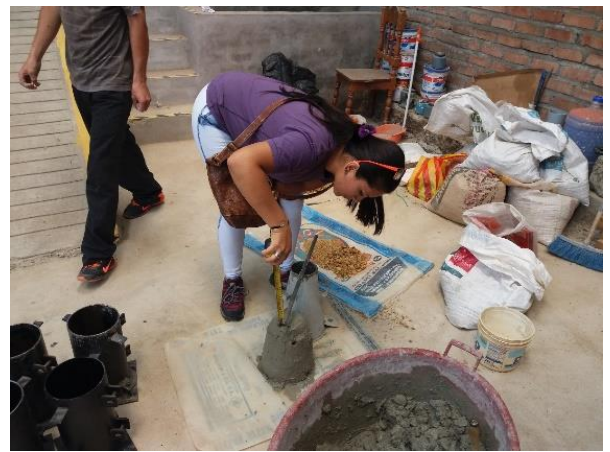
Imagen 35. MEDICION DEL ASENTAMIENTO
