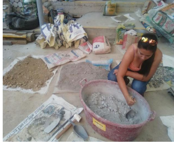
Imagen 31. MEZCLADO MANUAL (AMASADO)
