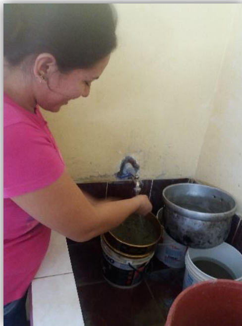
Imagen 19. LAVADO DEL AGREGADO EN EL TAMIZ N° 200
