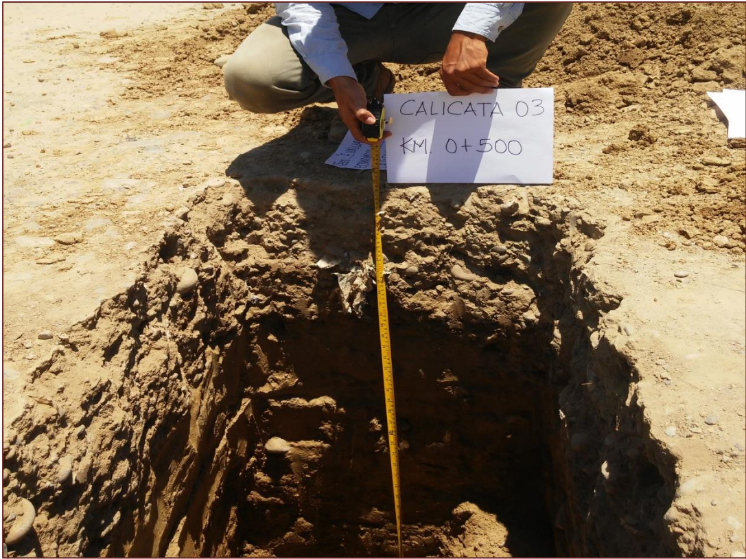
Fotografía 07: verificación de la profundidad de la calicata realizada.
