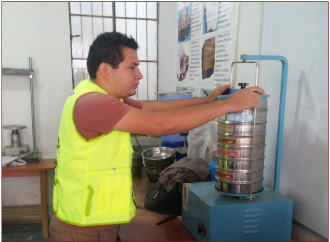
Fotografía 09. Realizando el ensayo de granulometría.
