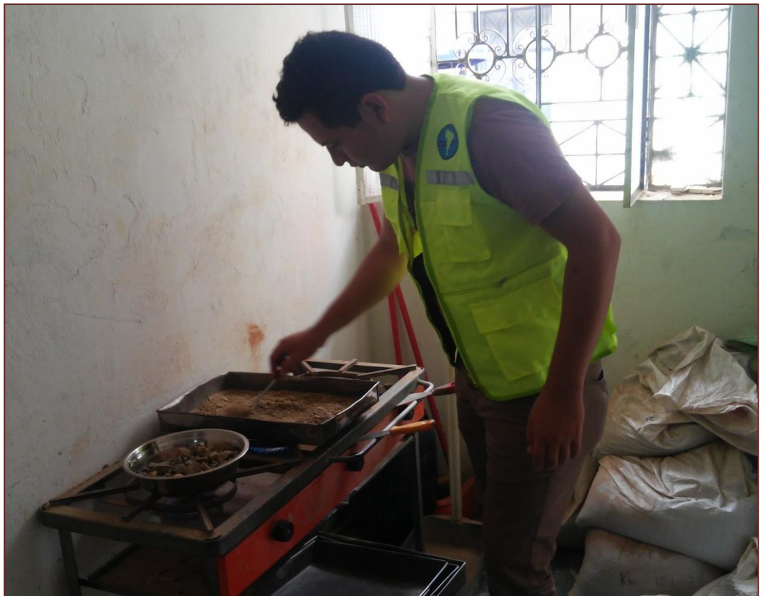
Fotografía 10. Realizando el ensayo para hallar el contenido de humedad
