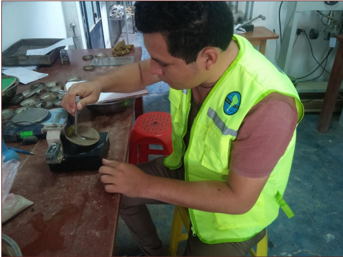
Fotografía 11: Realizando el ensayo para obtener el límite líquido
