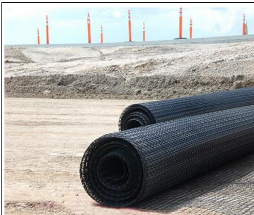
Figura 8. Geomalla biaxial (TENSAR, 2013).
