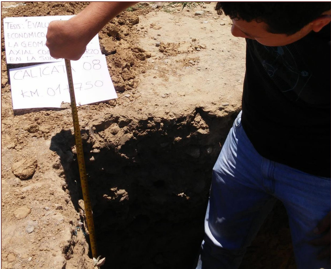
Fotografía 08: verificación de la profundidad de la calicata N° 08.
