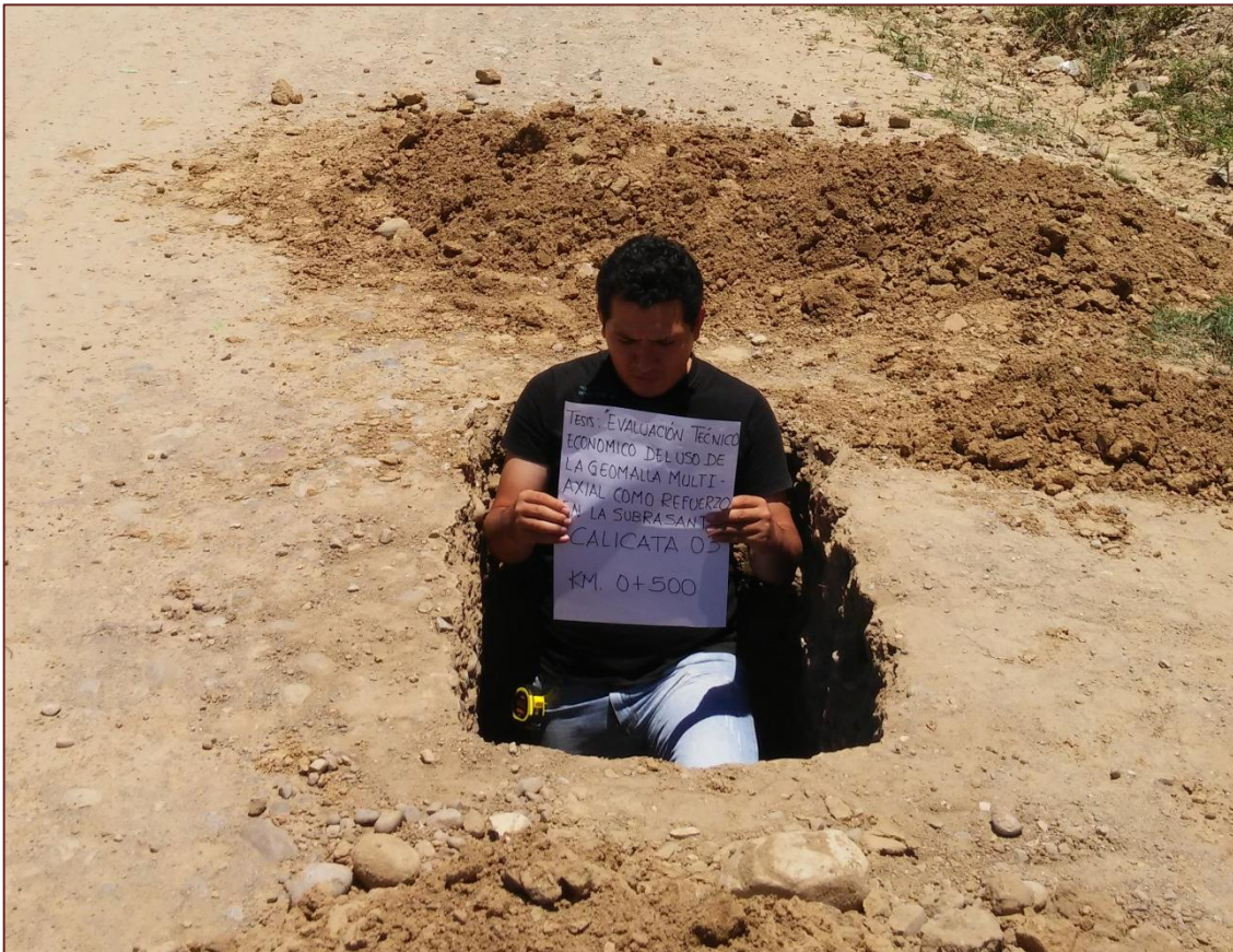
Fotografía 06: calicata realizada en el Km. 0+500, para la extracción de muestras.
