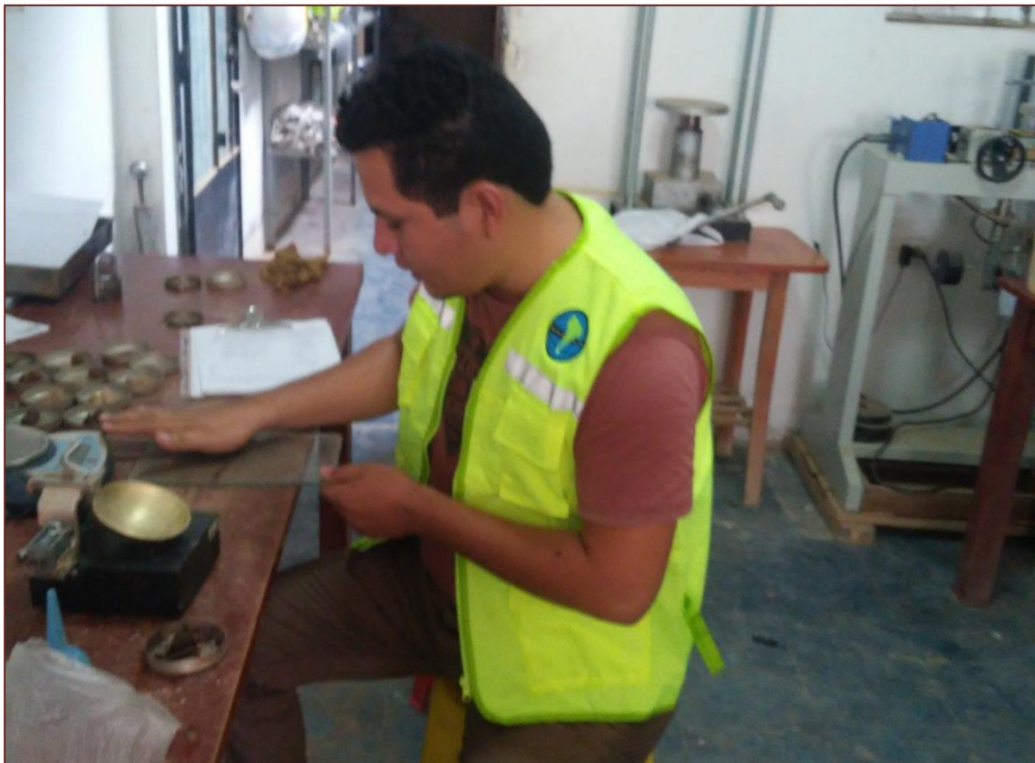
Fotografía 12: Realizando el ensayo para obtener el límite plástico
