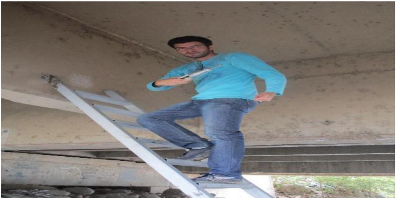
**Figura N° 08.** Realización del Ensayo de Esclerómetro en el Diafragma del Ampliación del puente margen derecho, aguas arriba.
