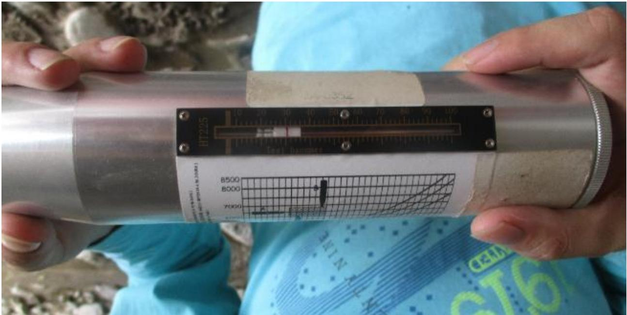
**Figura N° 12.** Lectura en el esclerómetro que verifica la realización del ensayo de esclerómetro.
