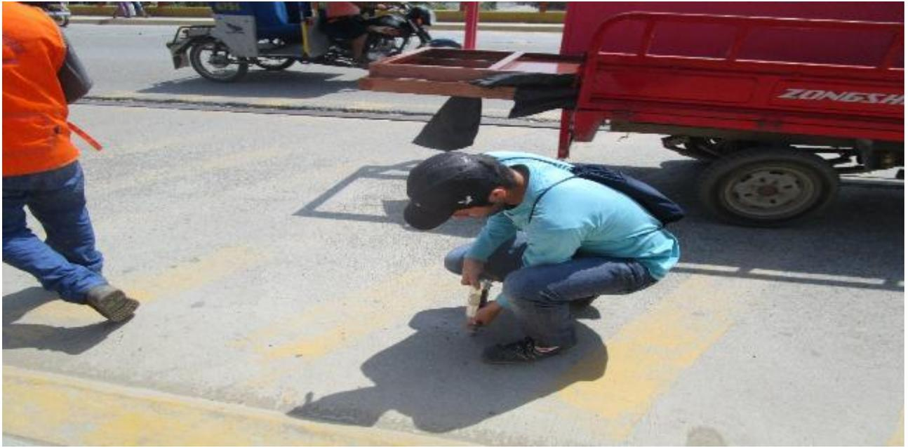
**Figura N° 11.** Toma de muestra con el esclerómetro en la losa del Ampliación de puente margen derecho, aguas arriba.
