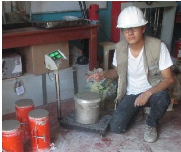
FOTO N° 27: Determinación del Peso Unitario del Concreto Fresco; del Concreto Fibroreforzado con Cascarilla de Arroz (30kg/m 3 )
