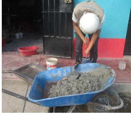
FOTO N° 26: Determinación de Slump del Concreto Fibroreforzado con Cascarilla de Arroz (30kg/m 3 )
