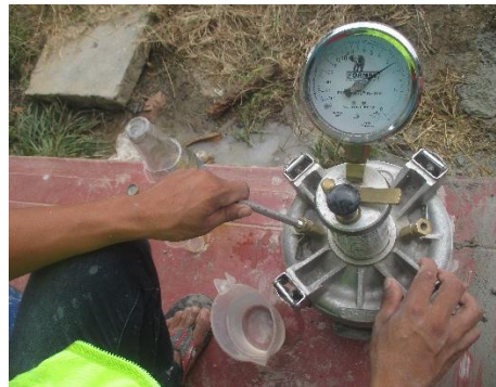
FOTO N° 16: Determinando el contenido de aire del concreto fresco, mediante la olla Washington, del Diseño Patrón (concreto convencional)
