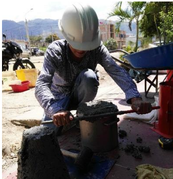
FOTO N° 20: Determinación del Peso Unitario del Concreto Fresco; del Concreto Fibroreforzado con Cascarilla de Arroz (10kg/m 3 )
