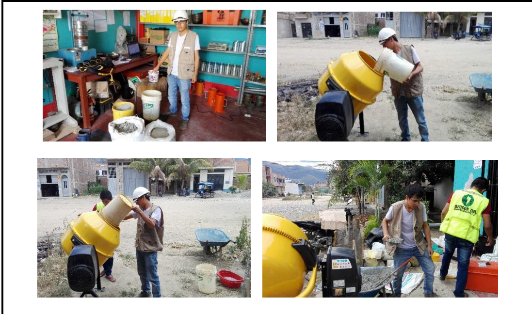
FOTO N° 13: Preparación de mezcla del Diseño Patrón (concreto convencional)
