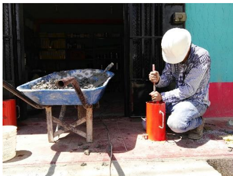
FOTO N° 21: Elaboración de los especímenes del Concreto Fibroreforzado con Cascarilla de Arroz (10kg/m 3 )
