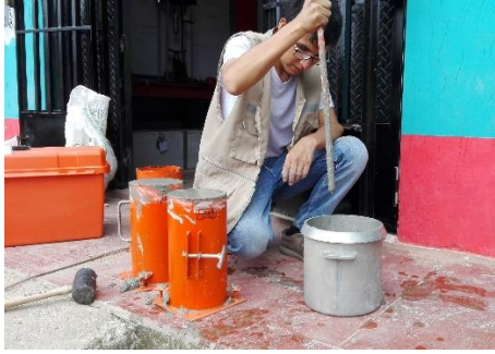
FOTO N° 15: Determinación del Peso Unitario del Concreto Fresco; Diseño Patrón (concreto convencional)
