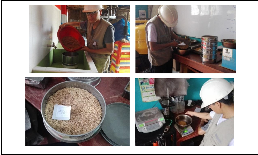
FOTO N° 09: Realizando ensayo de Granulometría de la Fibra Vegetal (Cascarilla de Arroz)
