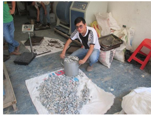
FOTO N° 07: Realizando ensayo para determinar pesos volumétricos secos, sueltos y compactados de los agregados
