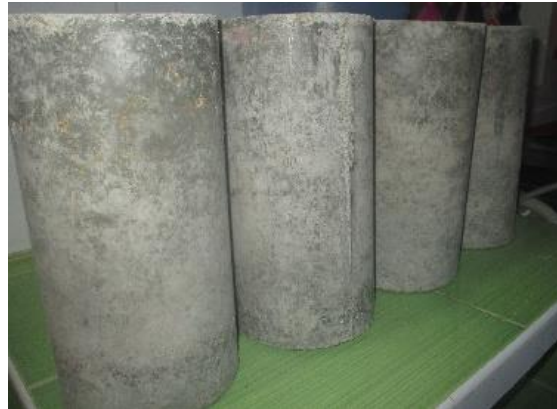
FOTO N° 28: Elaboración de los especímenes del Concreto Fibroreforzado con Cascarilla de Arroz (30kg/m 3 )
