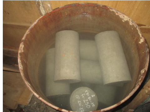
FOTO N° 29: Curado de los especímenes de concreto patrón y las diferentes adiciones
