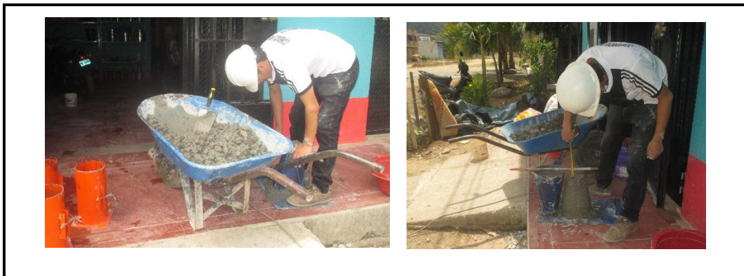
FOTO N° 23: Determinación de Slump del Concreto Fibroreforzado con Cascarilla de Arroz (20kg/m 3 )
