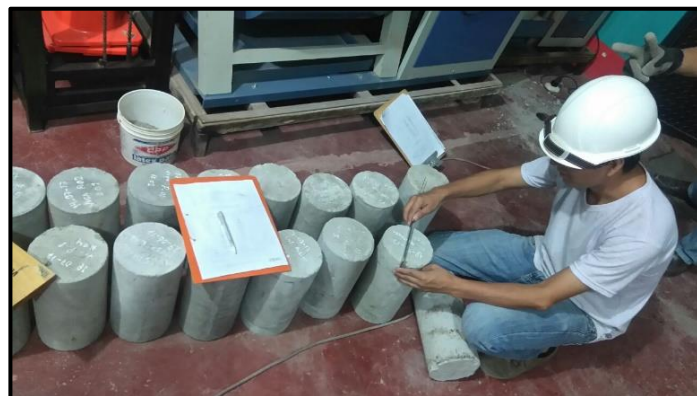
Figura 12: Toma de las Medidas de las Probetas Cilíndricas
