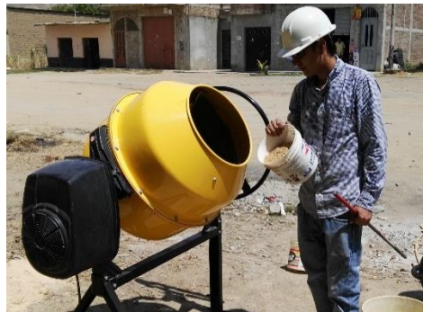
FOTO N° 18: Preparación de mezcla del Concreto Fibroreforzado con Cascarilla de Arroz (10kg/m 3 )
