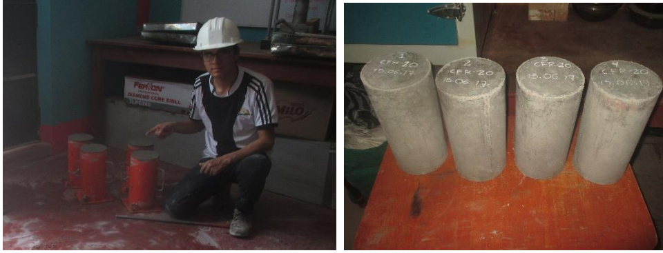
FOTO N° 24: Elaboración de los especímenes del Concreto Fibroreforzado con Cascarilla de Arroz (20kg/m3)
