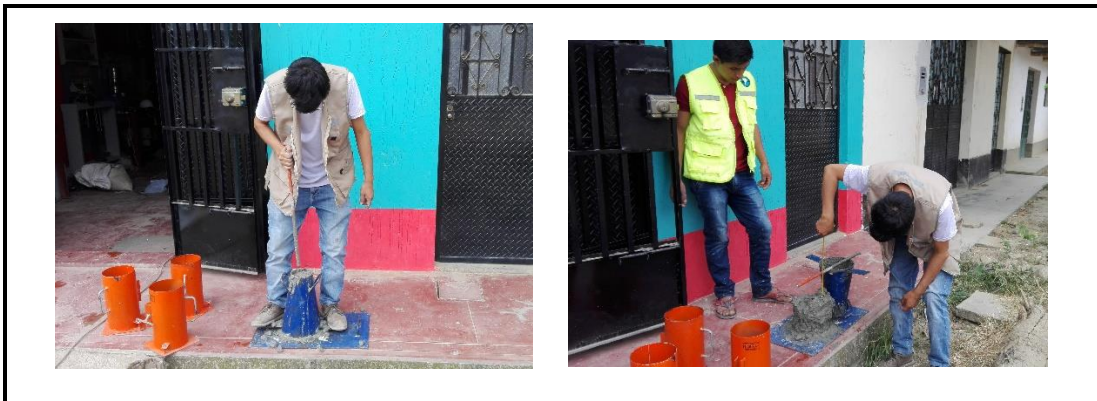
FOTO N° 14: Determinación de Slump del Diseño Patrón (concreto convencional)
