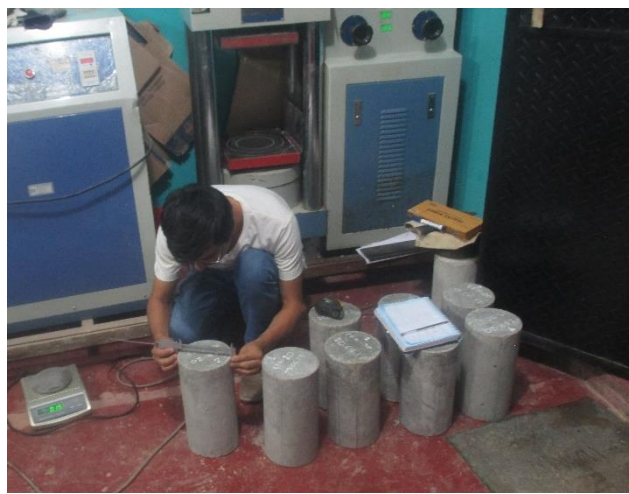
FOTO N° 30: Toma de medidas de los especímenes de concreto para su posterior ensayo.
