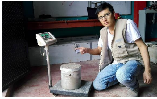
FOTO N° 15: Determinación del Peso Unitario del Concreto Fresco; Diseño Patrón (concreto convencional)
