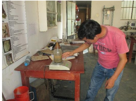
FOTO N° 06: Realizando ensayo de peso específico y porcentaje de absorción del agregado fino
