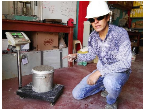
FOTO N° 20: Determinación del Peso Unitario del Concreto Fresco; del Concreto Fibroreforzado con Cascarilla de Arroz (10kg/m 3 )
