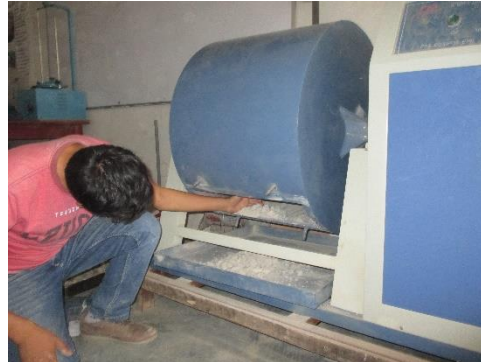
FOTO N° 08: Realizando ensayo de Abrasión por la máquina de los ángeles del agregado grueso
