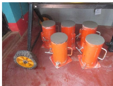
FOTO N° 21: Elaboración de los especímenes del Concreto Fibroreforzado con Cascarilla de Arroz (10kg/m 3 )
