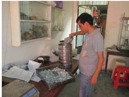
FOTO N° 04: Realizando ensayos de granulometría del agregado fino y agregado grueso
