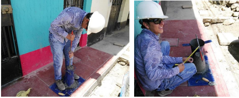
FOTO N° 19: Determinación de Slump del Concreto Fibroreforzado con Cascarilla de Arroz (10kg/m 3 )
