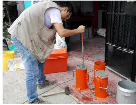
FOTO N° 17: Elaboración de los especímenes del Diseño Patrón (concreto convencional)
