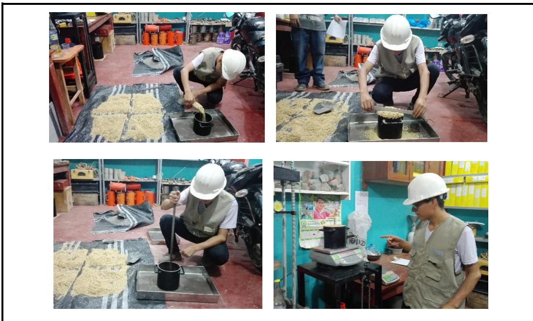
FOTO N° 10: Realizando ensayo para determinar pesos volumétricos secos, sueltos y compactados de la fibra vegetal (cascarilla de arroz)
