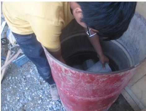
FOTO N° 29: Curado de los especímenes de concreto patrón y las diferentes adiciones
