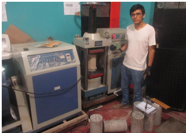
FOTO N° 32: Ensayo a Compresión de los especímenes de concreto cilíndricos, con presencia del Ing. José Antonio Coronel Delgado (Coordinador de EAPIC en Universidad Nacional de Cajamarca - Sede Jaén)
