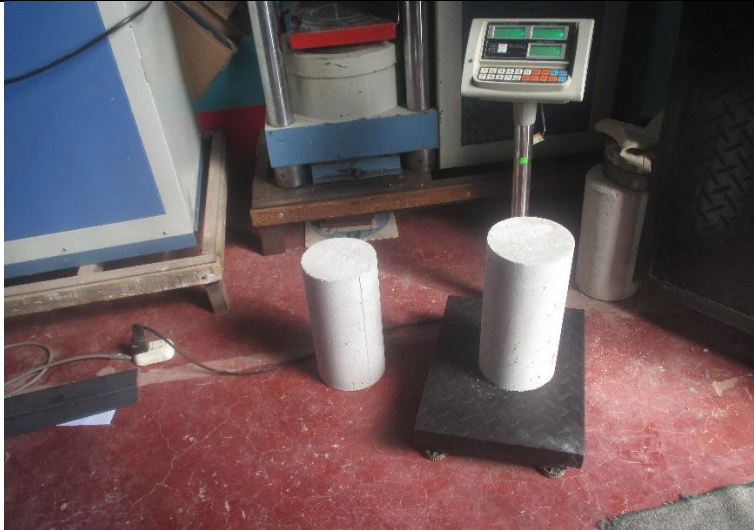
FOTO N° 31: Toma de pesos de los especímenes de concreto para calcular su peso unitario en estado endurecido
