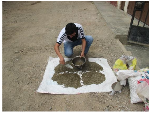
FOTO N° 03: Realizando cuarteo de los agregados para la reducción a tamaño de muestra para los ensayos a realizar
