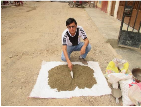
FOTO N° 03: Realizando cuarteo de los agregados para la reducción a tamaño de muestra para los ensayos a realizar
