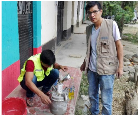
FOTO N° 16: Determinando el contenido de aire del concreto fresco, mediante la olla Washington, del Diseño Patrón (concreto convencional)
