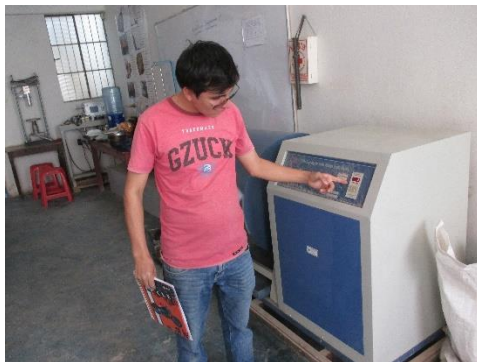
FOTO N° 08: Realizando ensayo de Abrasión por la máquina de los ángeles del agregado grueso
