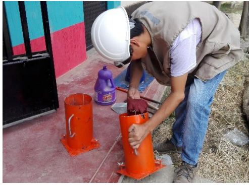
FOTO N° 17: Elaboración de los especímenes del Diseño Patrón (concreto convencional)
