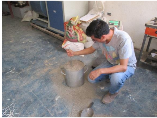
FOTO N° 07: Realizando ensayo para determinar pesos volumétricos secos, sueltos y compactados de los agregados
