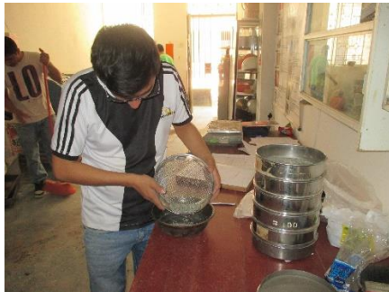
FOTO N° 04: Realizando ensayos de granulometría del agregado fino y agregado grueso
