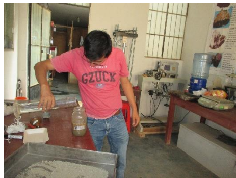
FOTO N° 06: Realizando ensayo de peso específico y porcentaje de absorción del agregado fino
