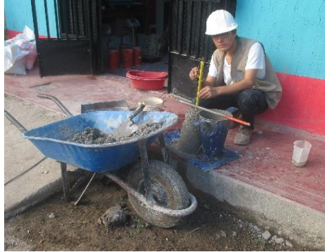
FOTO N° 26: Determinación de Slump del Concreto Fibroreforzado con Cascarilla de Arroz (30kg/m 3 )
