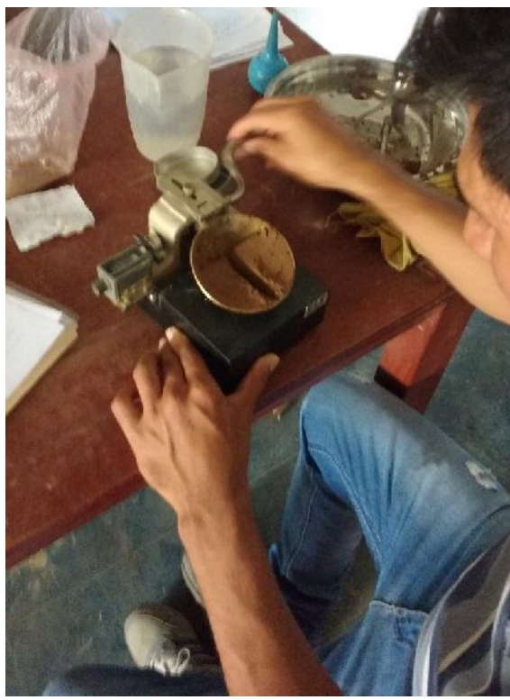
Fotografía 14: Se aprecia ensayo para cálculo de límite plástico, para clasificación del suelo de San Isidro.
