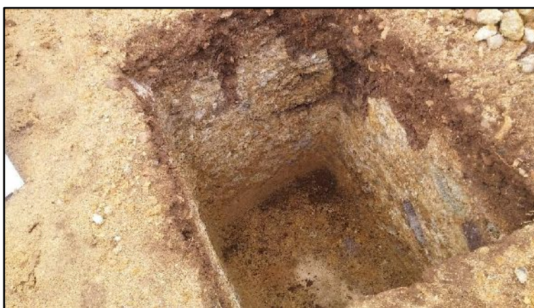
Figura 24. Suelo del sector de San Isidro, profundidad de calicata 1.70m
