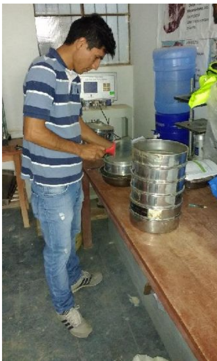
Fotografía 12: Se aprecia selección de suelo retenido en cada tamiz, para pesar y determinar la granulometría del suelo de San Isidro.
