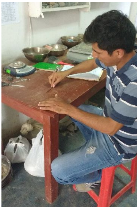
Fotografía 13: Se aprecia elaboración de rollitos para cálculo de límite plástico para clasificación del suelo de San Isidro.
