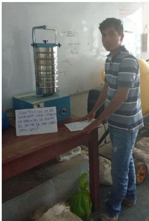
Fotografía 11: Se aprecia tamizado de muestra para determinar la granulometría del suelo de San Isidro.
