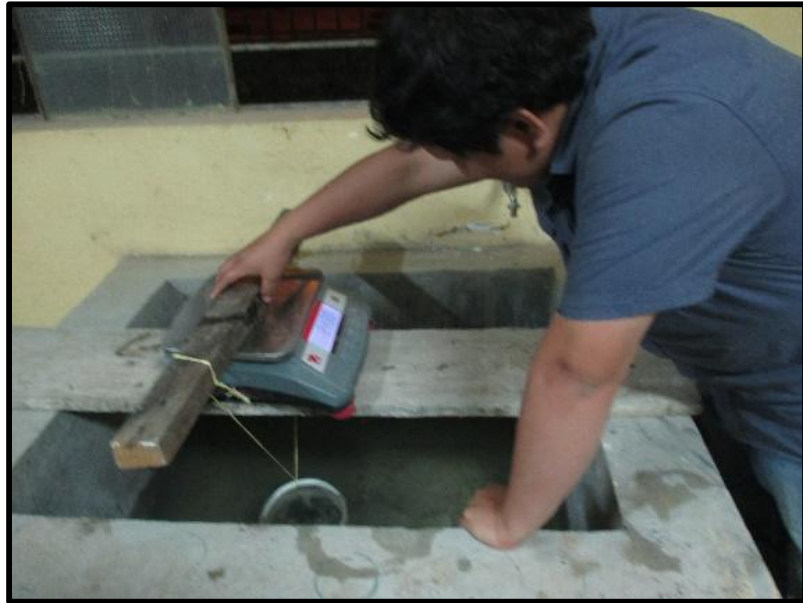
Fig. 21 Peso de la muestra sumergida en agua.
