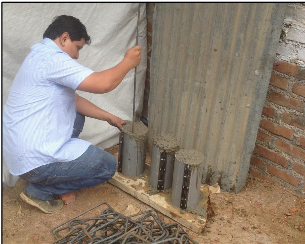
Foto N° 20 Moldeo de especímenes de concreto elaborados al pie de obra (02).
