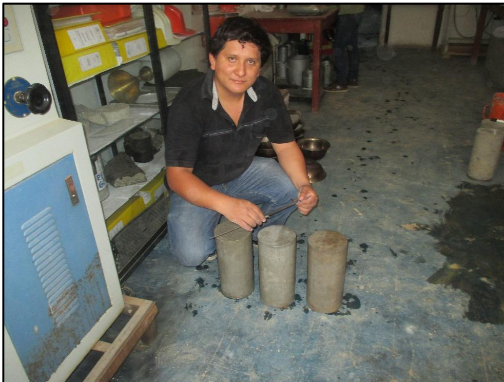
Foto N° 22 Medida del diámetro del testigo
