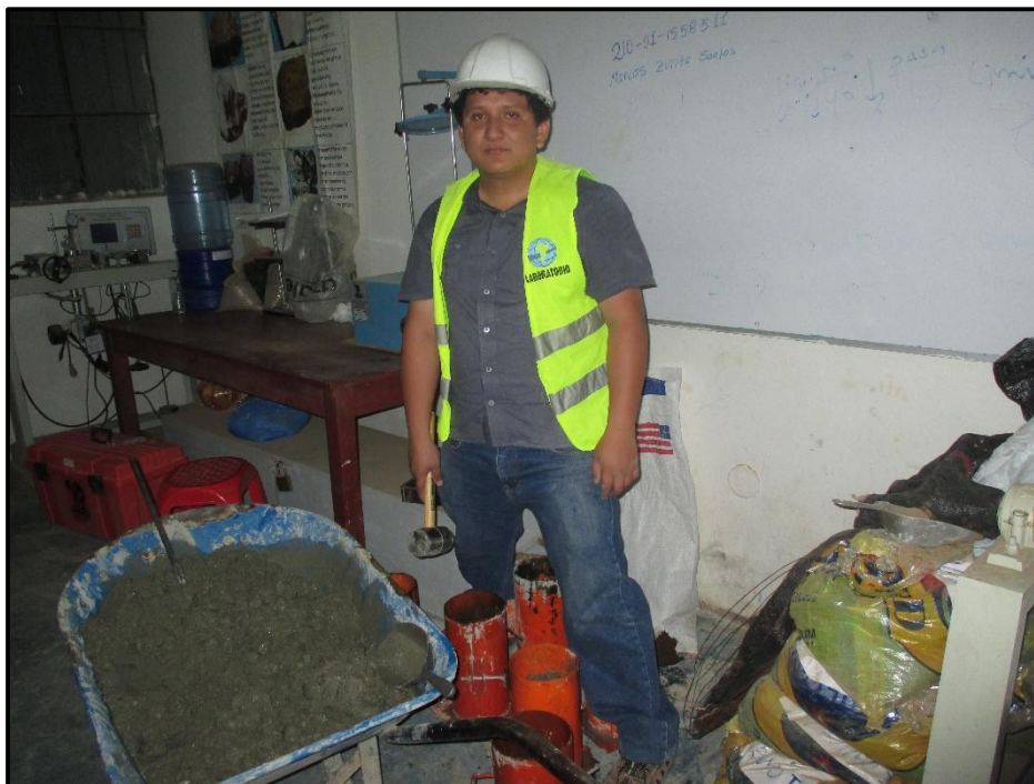
Foto N° 11 Eliminación de aire atrapado con uso de la comba de goma
