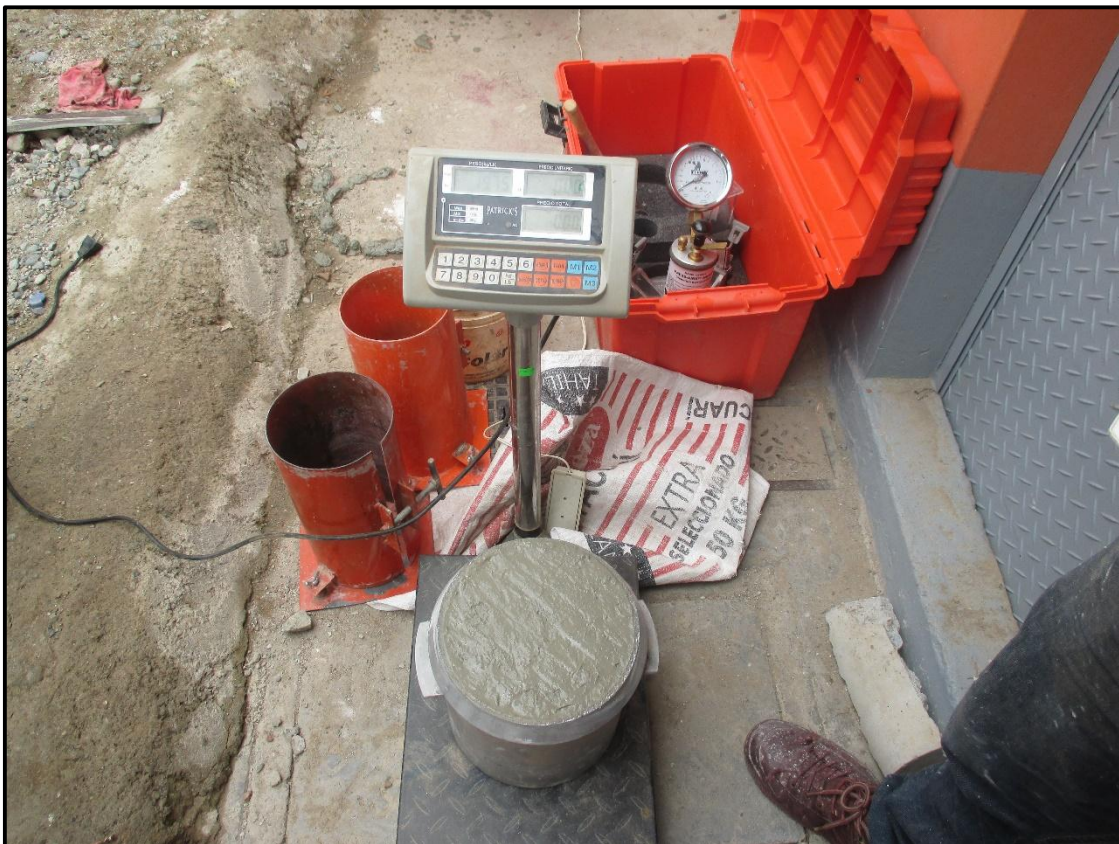
Foto N° 9 Peso unitario del concreto fresco
