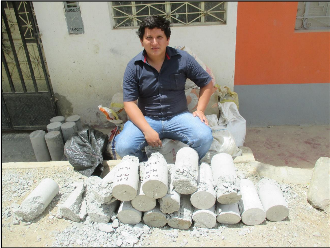
Foto N° 25 Testigos de concreto sometidos a carga axial.
