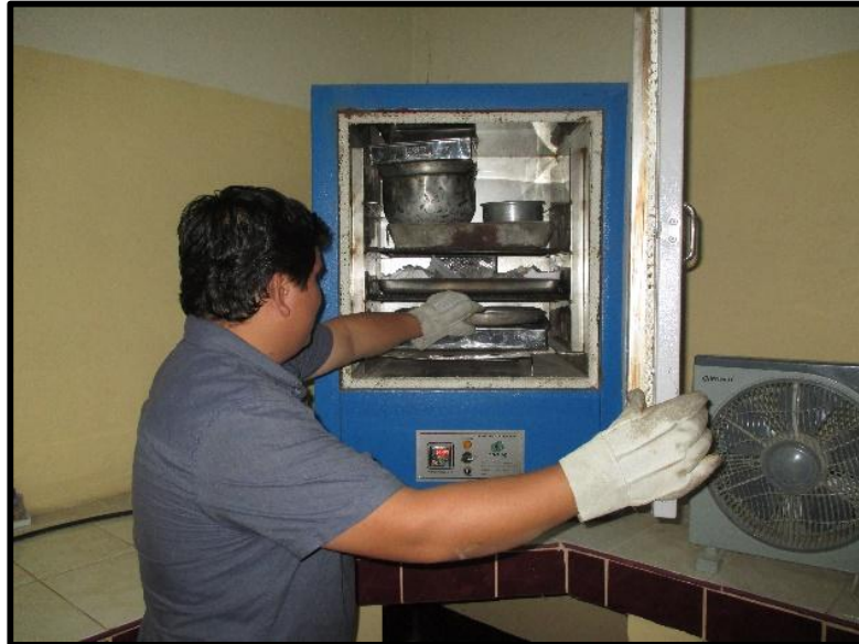
Fig. 22 Secado de la muestra en horno
