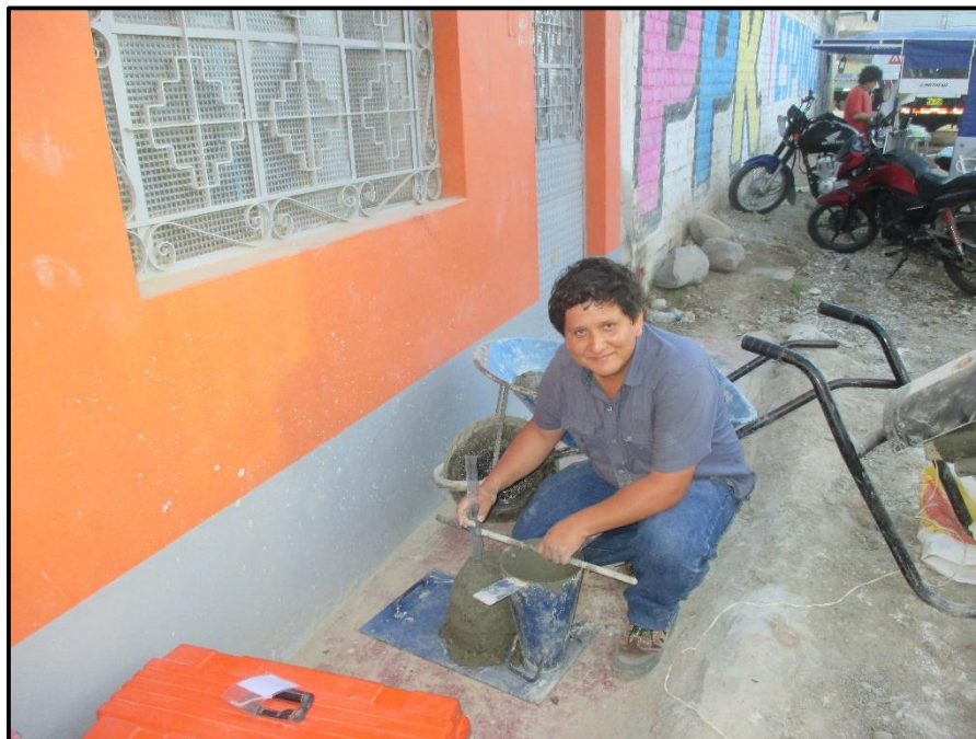
Foto N° 7 Medición del asentamiento de la mezcla de concreto
