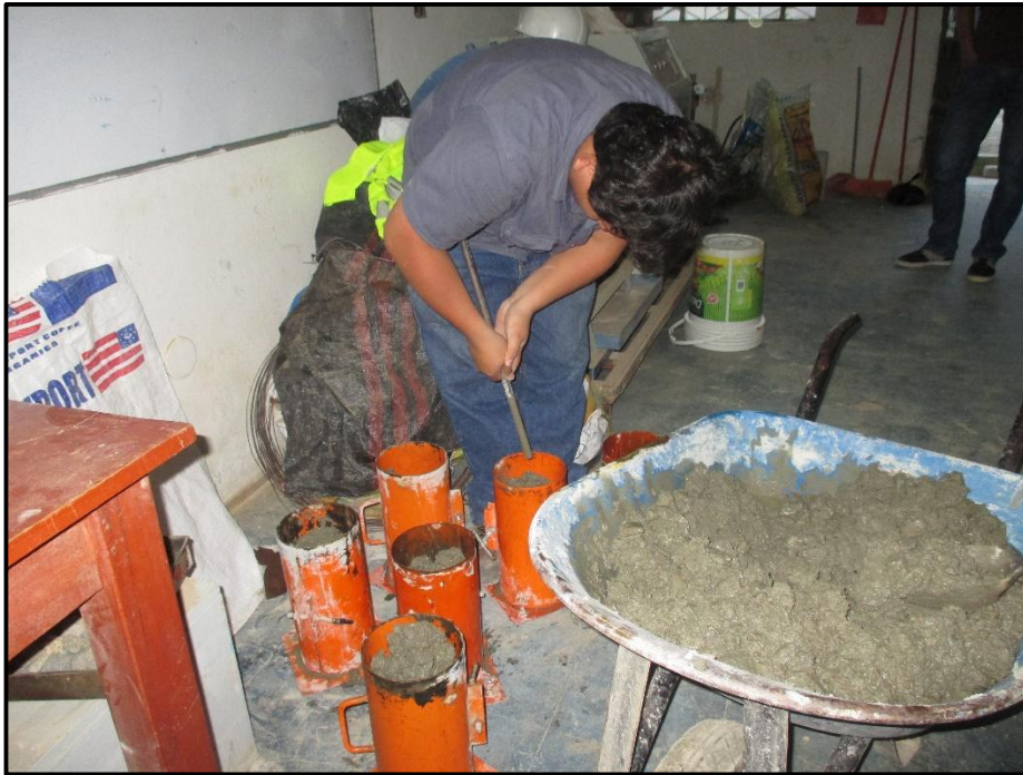
Foto N° 10 Moldeo de especímenes en laboratorio
