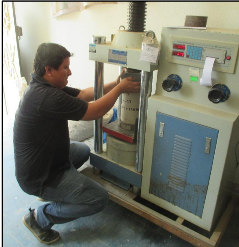
Foto N° 23 Ubicación de testigo en maquina compresora
