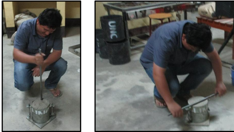
Fig. 17 Compactado muestra y Fig. 18 Enrasado de muestra
