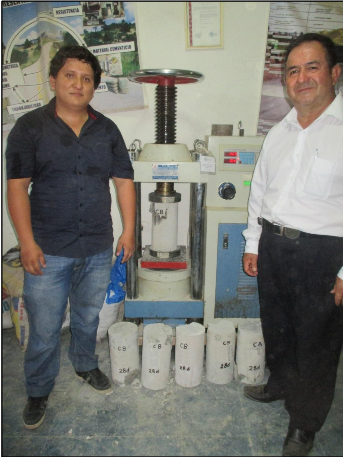
Foto N° 12 Rotura de especímenes de concreto de mezcla patrón.
