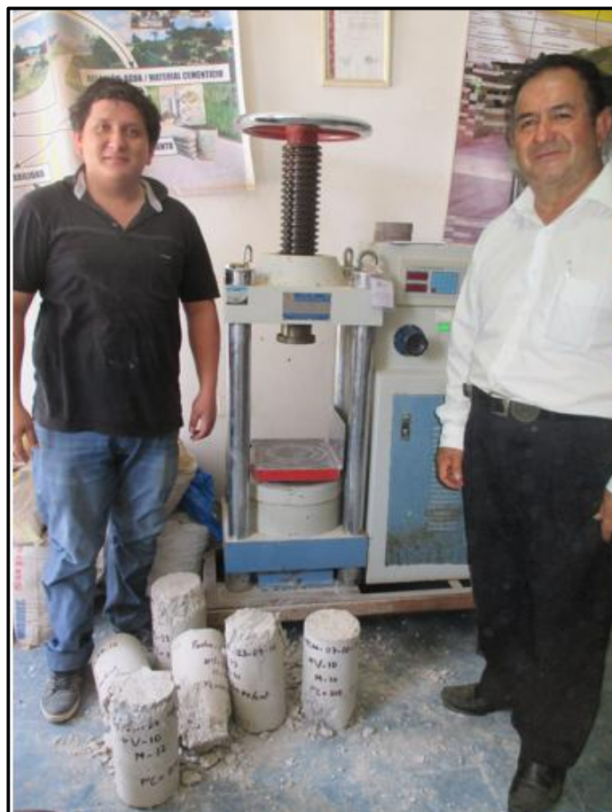
Foto N° 24 Rotura de especímenes elaborados al pie de obra.
