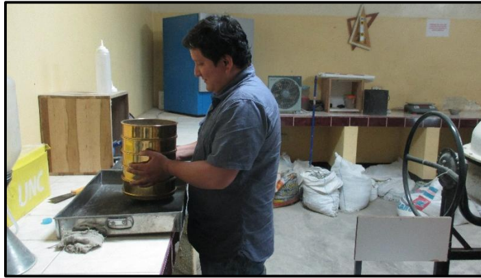
Fig. 16 Tamizado de agregado.
