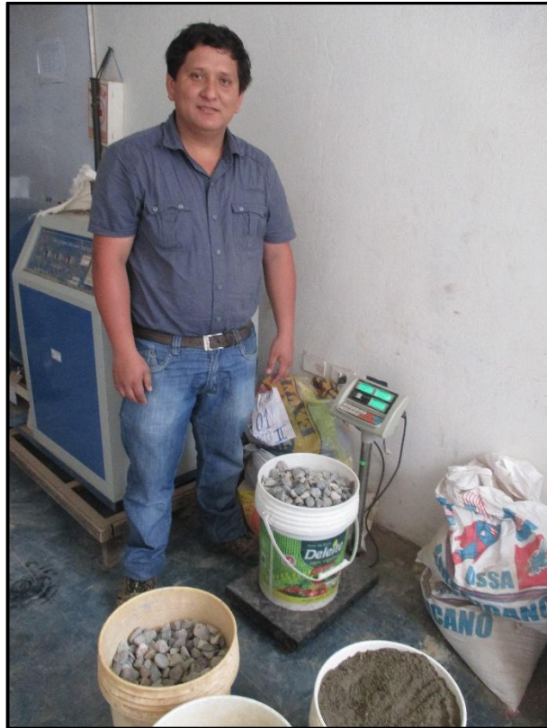
Foto N° 3 Pesado de los agregados
