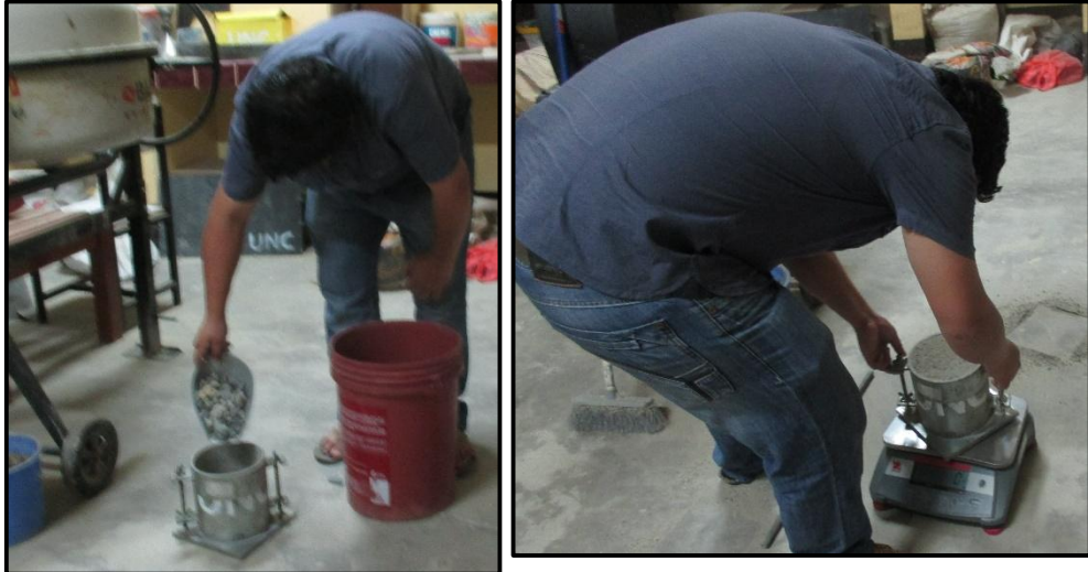
Fig. 19 Vaciado del agregado en el molde y Fig. 20 Enrasado de la superficie de la muestra
