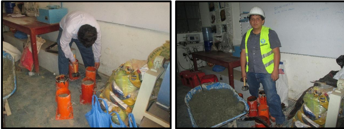
Fig. 26 Eliminación de aire en el espécimen
