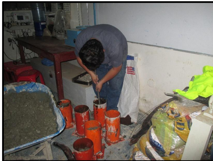
Fig. 25 Compactado de los especímenes de concreto.
