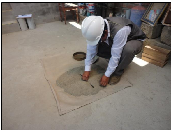
Figura 9. Cuarteo de muestra de arena fina.
