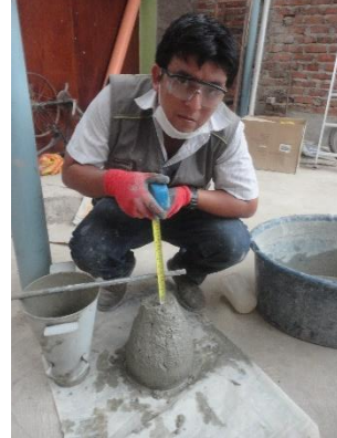
Figura 72. Medida del slump.
