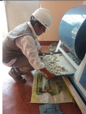
Figura 62. Agregado grueso después de la carga abrasiva.
