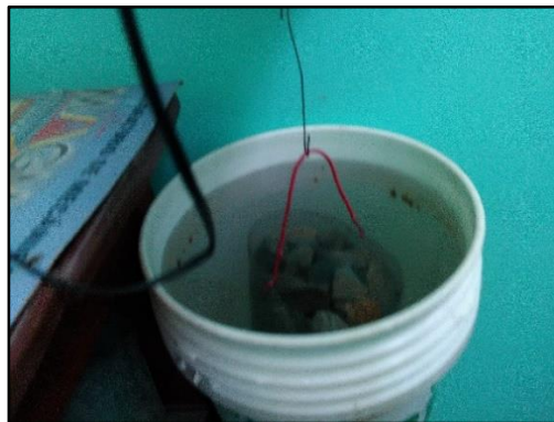
Figura 20. Peso del agregado grueso sumergido en agua.
