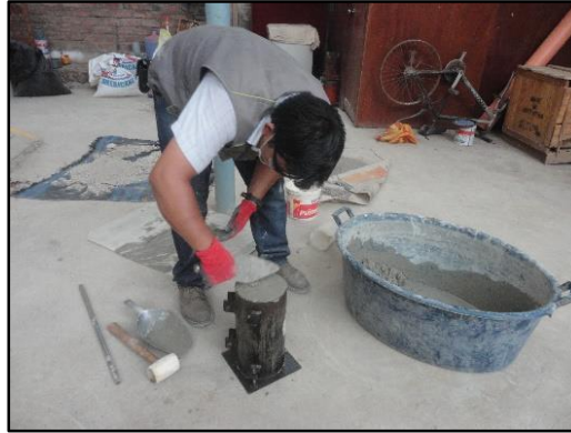
Figura 28. Retiro del exceso de mezcla
