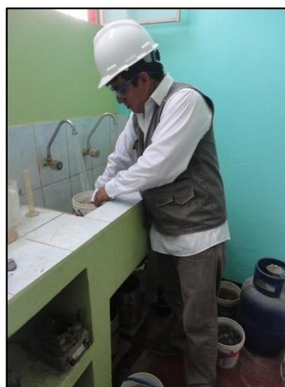
Figura 11. Lavado del agregado fino
