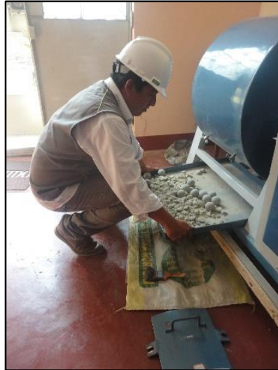
Figura 24. Agregado grueso después del ensayo a la Abrasión.
