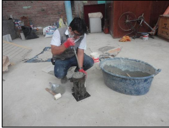
Figura 26. Compactado de los especímenes de concreto
