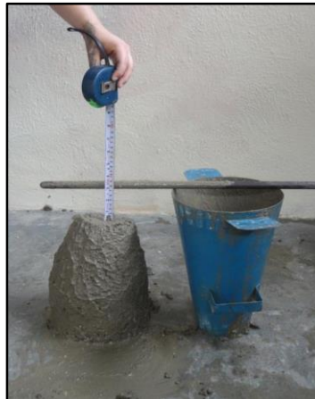
Figura 3. Ensayo de Asentamiento (Slump)
