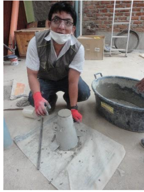
Figura 71. Ensayo del slump.
