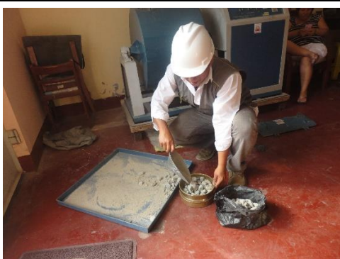
Figura 63. Utilizando el tamiz N° 12.
