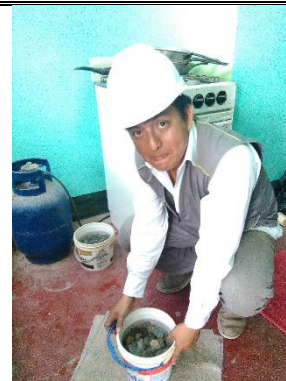
Figura 56. Agregado sumergido en agua
