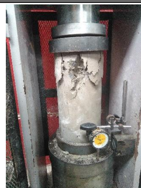
Figura 82. Falla a compresión.
