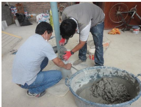
Figura 69. Varillado en la prueba slump.
