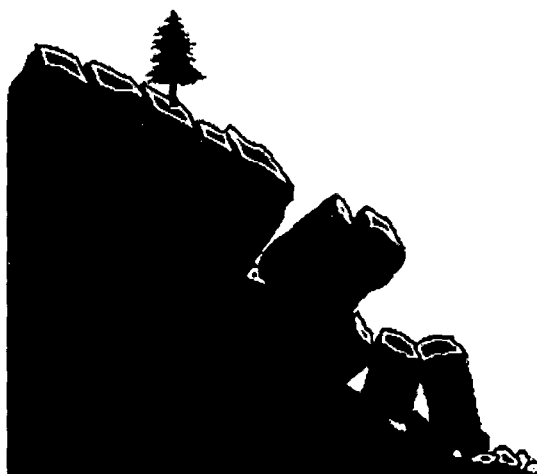
Figura N° 07. Derrumbe de bloques característico de la microcuenca.
