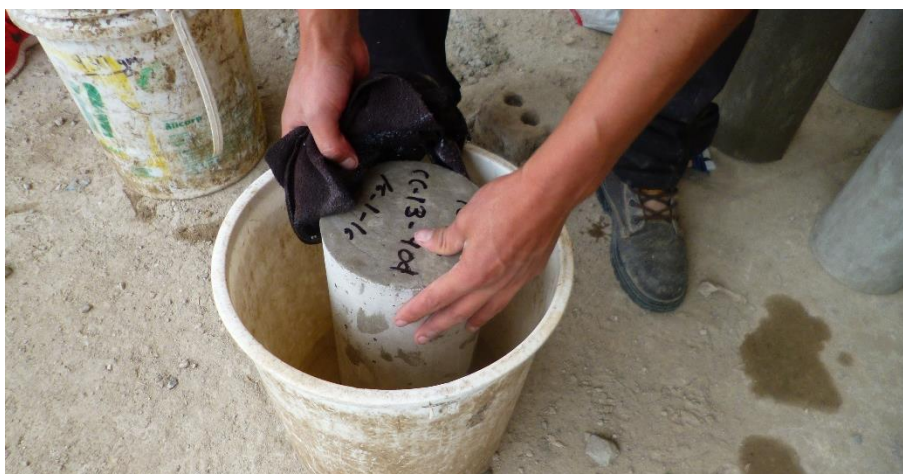
Imagen N°6. Fotografía de tratamiento de curado con aditivo membranal
