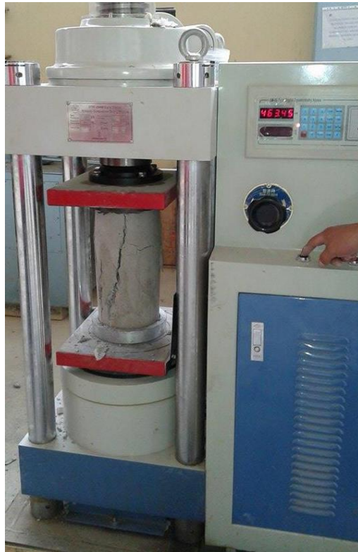
Imagen N°11. Fotografía de ensayo de resistencia a la compresión a la edad de 28 días.
