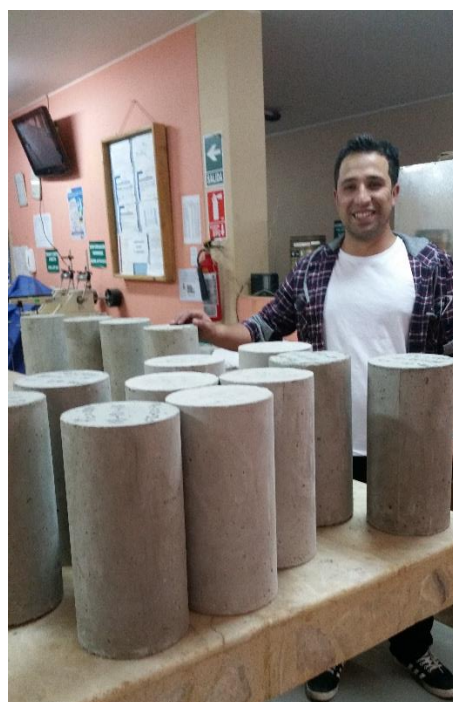
Imagen N°15. Fotografía de especímenes cilíndricos de concreto a ser ensayados a compresión a los 90 días.
