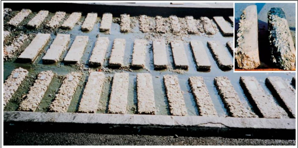
Figura N°9: Vigas de concreto después de muchos años de exposición a un suelo con alta concentración de sulfatos en Sacramento, California, terreno de ensayo. Las vigas en mejores condiciones tienen bajas relaciones agua-materiales cementantes y muchas de ellas tienen cemento resistente a sulfatos. La foto menor, a la derecha en la parte superior, enseña dos vigas inclinadas sobre sus laterales para mostrar niveles decrecientes de deterioro con la profundidad y el nivel de humedad. (Kosmatka, y otros, 2004)
