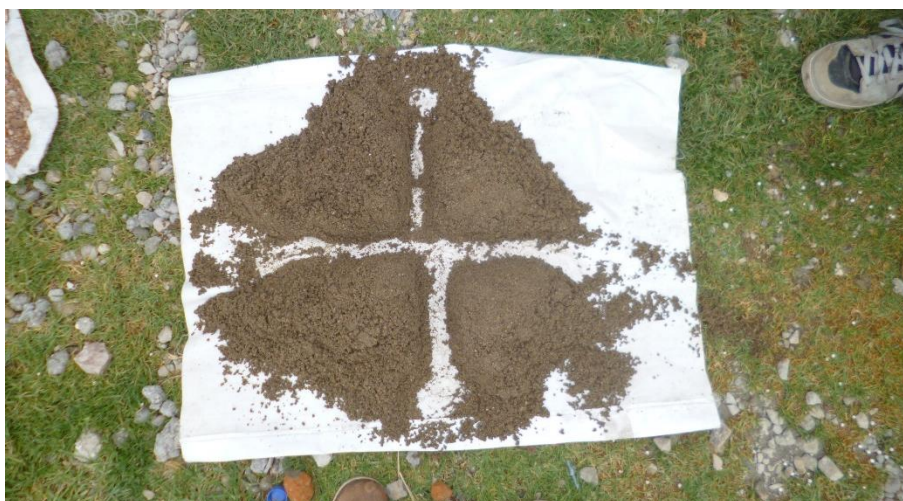
Imagen N°2. Fotografía de muestreo de agregados por método del cuarteo
