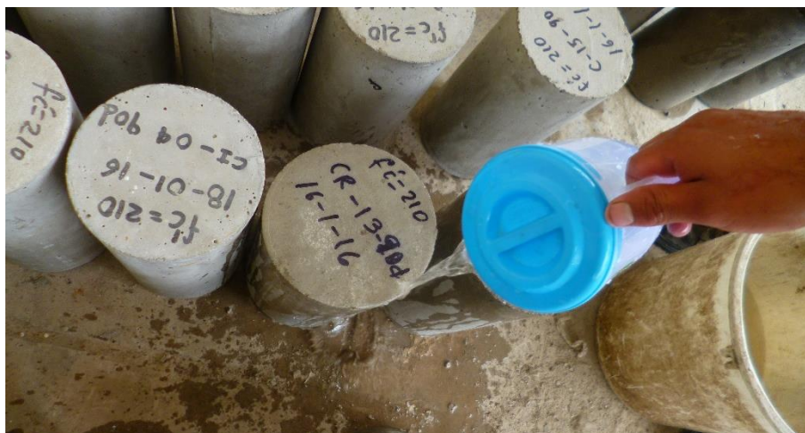
Imagen N°7. Fotografía de tratamiento de curado con rociado de agua
