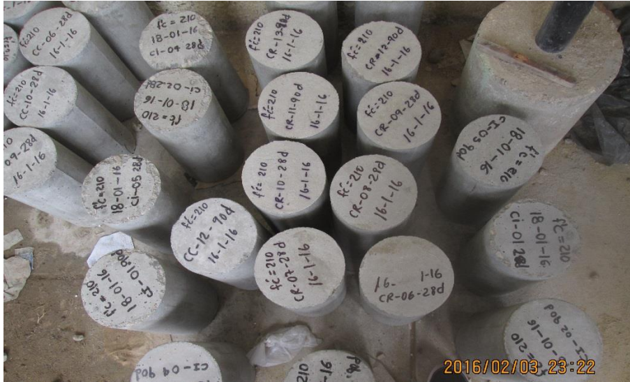
Imagen N°10. Fotografía de almacenamiento de especímenes en intemperie.
