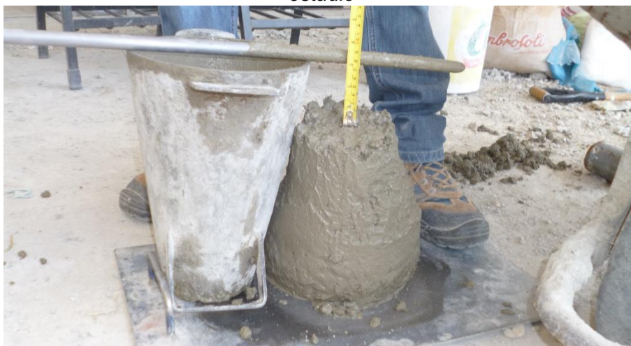
Imagen N°5. Fotografía de prueba de cono de Abrams para el concreto fresco
