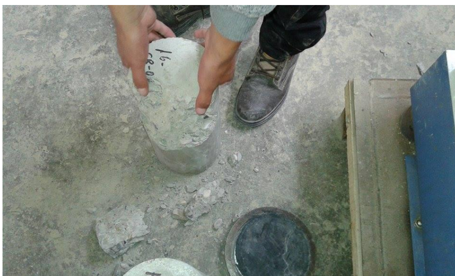
Imagen N°13. Fotografía de muestra de espécimen para ensayo de contenido de humedad de los tratamientos.
