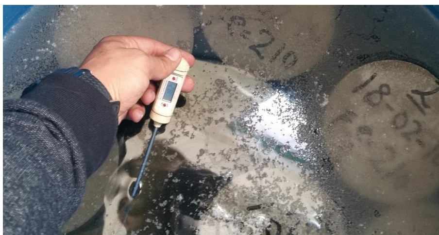
Imagen N°9. Fotografía de control de temperatura en tratamiento de curado estándar sumergido en agua
