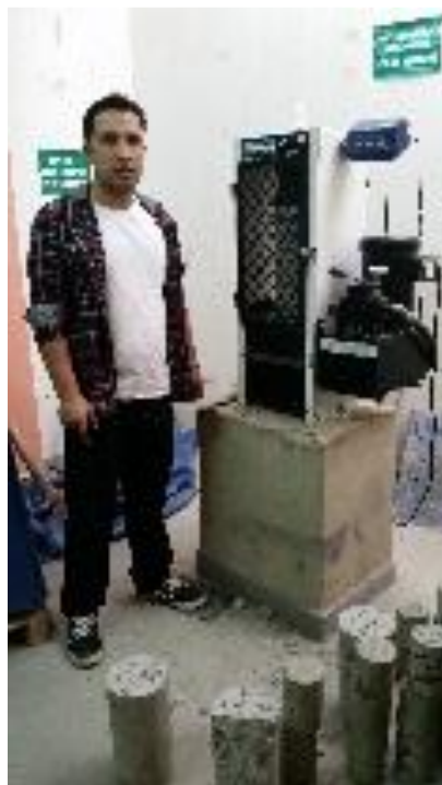
Imagen N°14. Ensayo de rotura de especímenes cilíndricos de concreto
