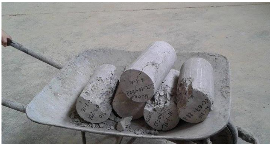
Imagen N°12. Fotografía de especímenes ensayados a compresión, para obtener contenido de humedad de los tratamientos.
