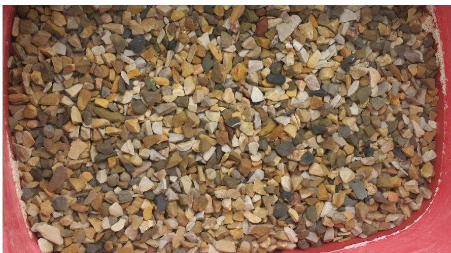
Imagen N°3. Fotografía de saturación de agregado grueso para elaboración de tratamiento de concreto con curado interno
