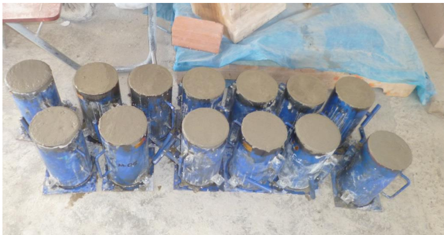
Imagen N°4. Fotografía de elaboración de especímenes cilíndricos de concreto de estudio
