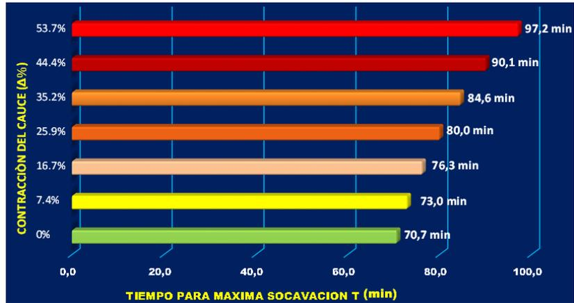
Figura N° 39. Variación del tiempo de socavación para diferentes porcentajes de contracción del cauce.
