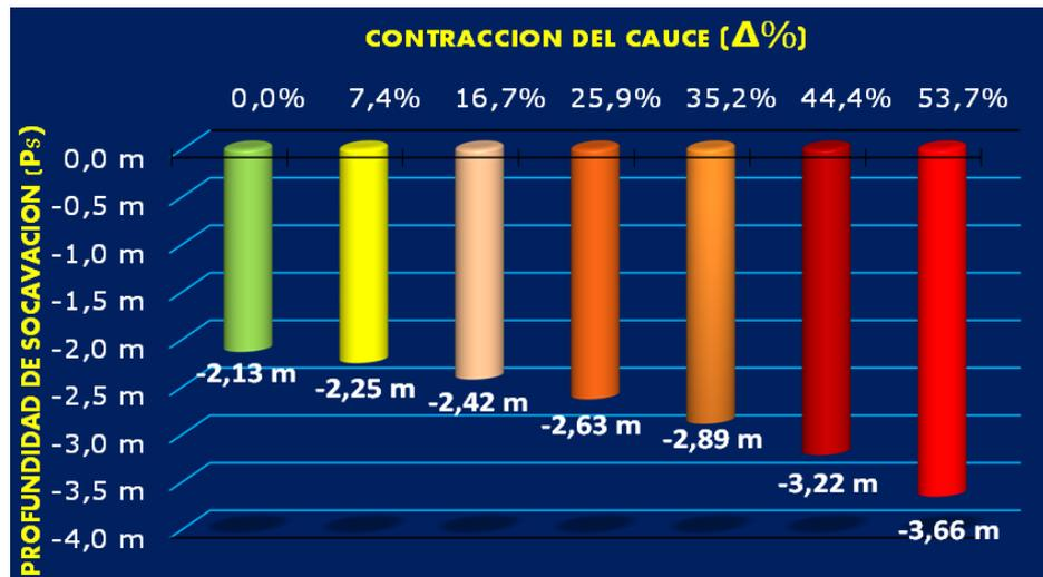
Figura N° 37. Variación de la profundidad de socavación para diferentes porcentajes de contracción del cauce.
