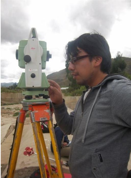
Para comprobar los resultados obtenidos después del modelar físicamente la estructura, es necesario tener la nueva morfología del río realizando un levantamiento topográfico.
