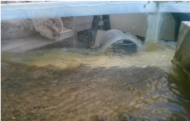
Figura 28. Funcionamiento del bocal en el mes de marzo con un caudal escala en el río de 1,09 \text{ L s}^{-1} y en el bocal 0,34 \text{ L s}^{-1} que en el prototipo equivalen a 3,41 \text{ m}^3 \text{ s}^{-1} y 1062,5 \text{ L s}^{-1} , respectivamente.
