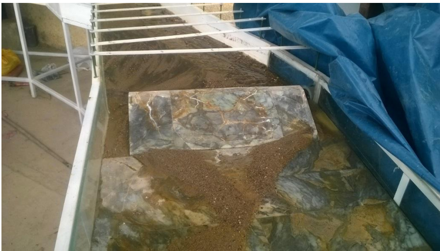
Figura 22. Morfología del río Grande al inicio de la descolmatación inducida en enero de 2015, después de aperturar los extremos del barrage, con un caudal escala de 0,39 \text{ L s}^{-1} en el río, equivalente a 1,23 \text{ m}^3 \text{ s}^{-1} en el prototipo, con 26 horas de duración en el mes de enero de 2105.
