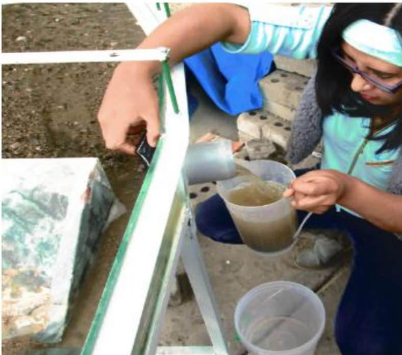
Figura 26. Medida del caudal en el bocal, con el método volumétrico, durante la descolmatación.
