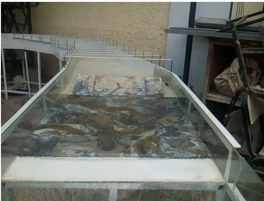
Figura 12. Vista frontal de la captación a escala 1/25 durante el ensayo sin sedimentos, con el barrage abierto en los extremos
