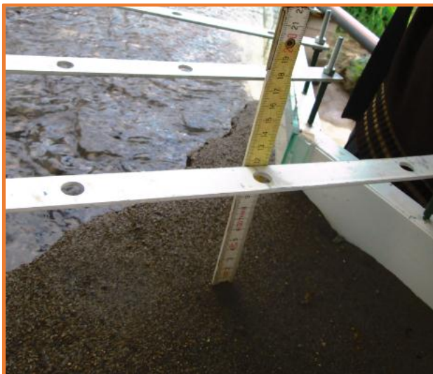
Figura 14. Medida de profundidades en el modelo durante la descolmatación
