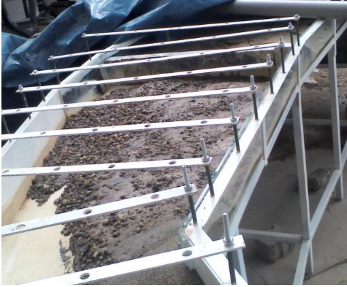
Figura 29. Morfología del río Grande desde el barrage hasta donde se extienden los muros de protección, debido a la descolmatación desde enero hasta marzo de 2015 (duración escala: 273,6 horas).
