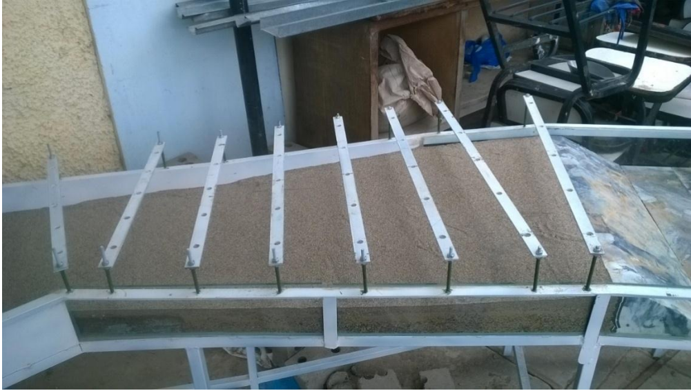
Figura 21. Captación Tres Molinos colmatada en el río Grande, con el barrage sin aperturar, a escala 1/25.
