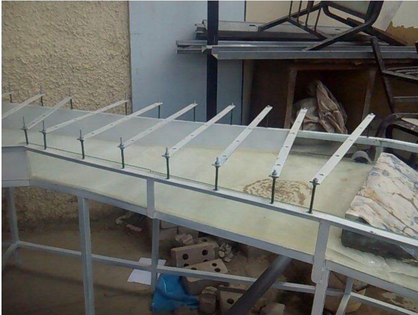
Figura 11. Vista del modelo a escala 1/25 instalado en el Laboratorio de Ensayo de Materiales de la UNC
