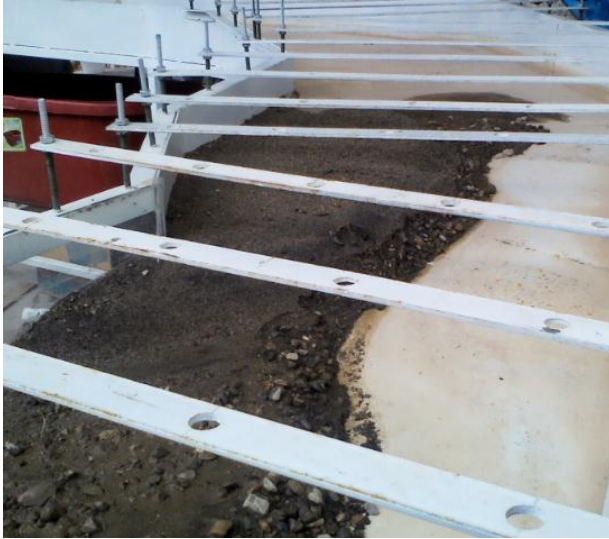
Figura 17. Modelo hidráulico donde se observa la morfología del río Grande por efecto de la descolmatación inducida de enero a marzo de 2015
