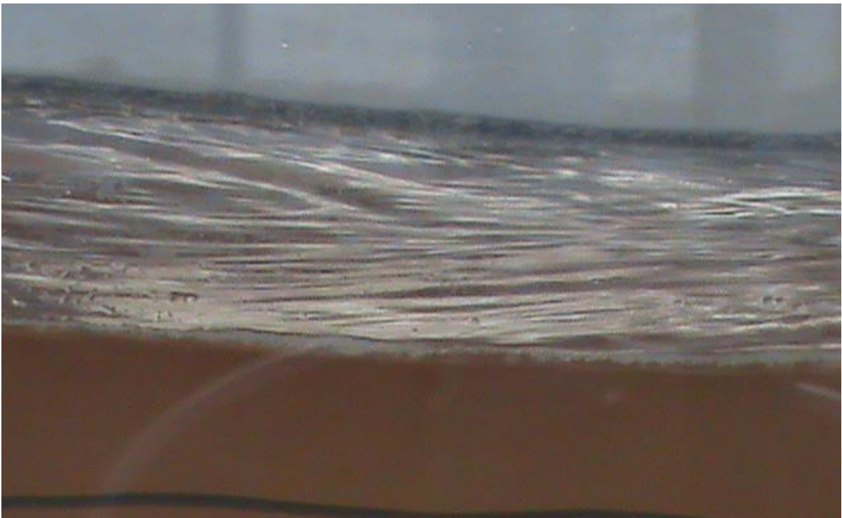
Figura 11: Característica del flujo sobre el cauce modelado (flujo laminar)
