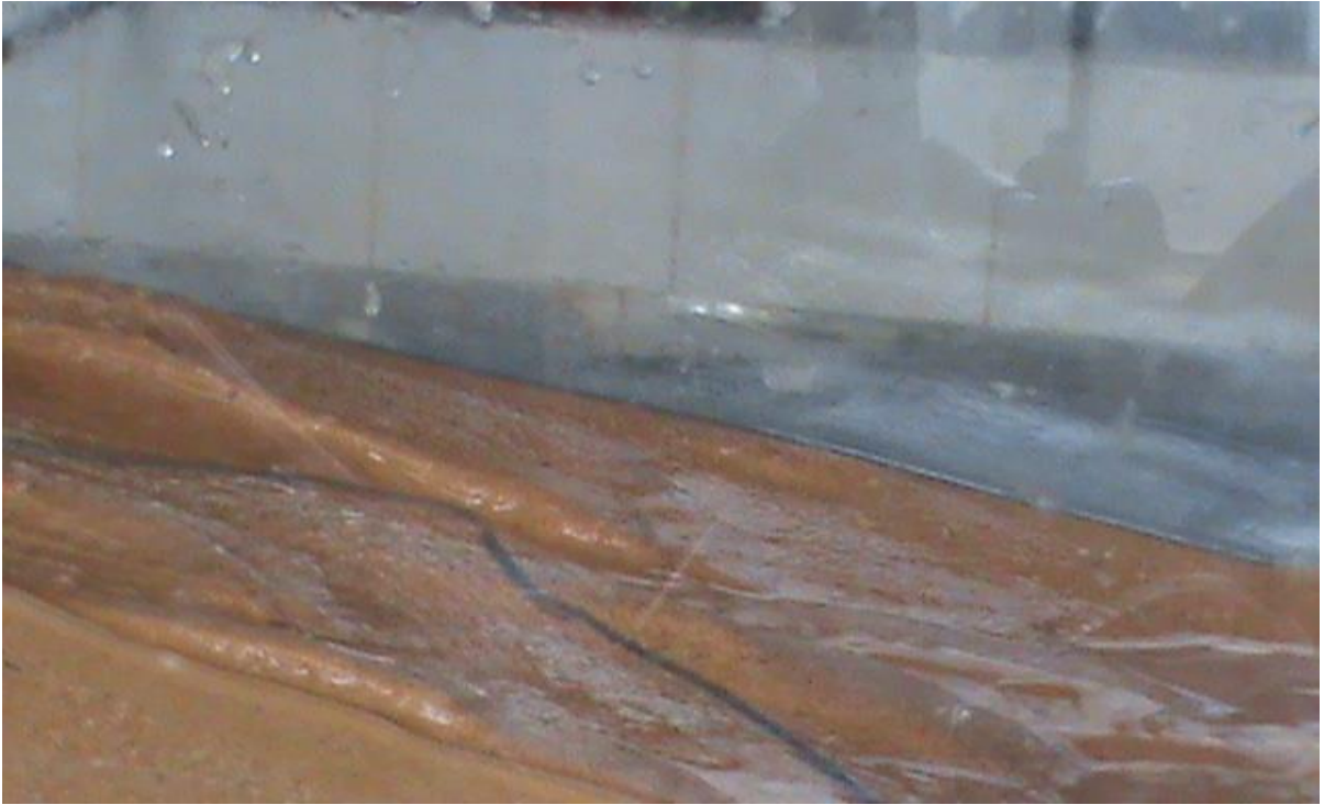
Figura 14: Arrastre del cauce en el modelo, por acción del flujo
