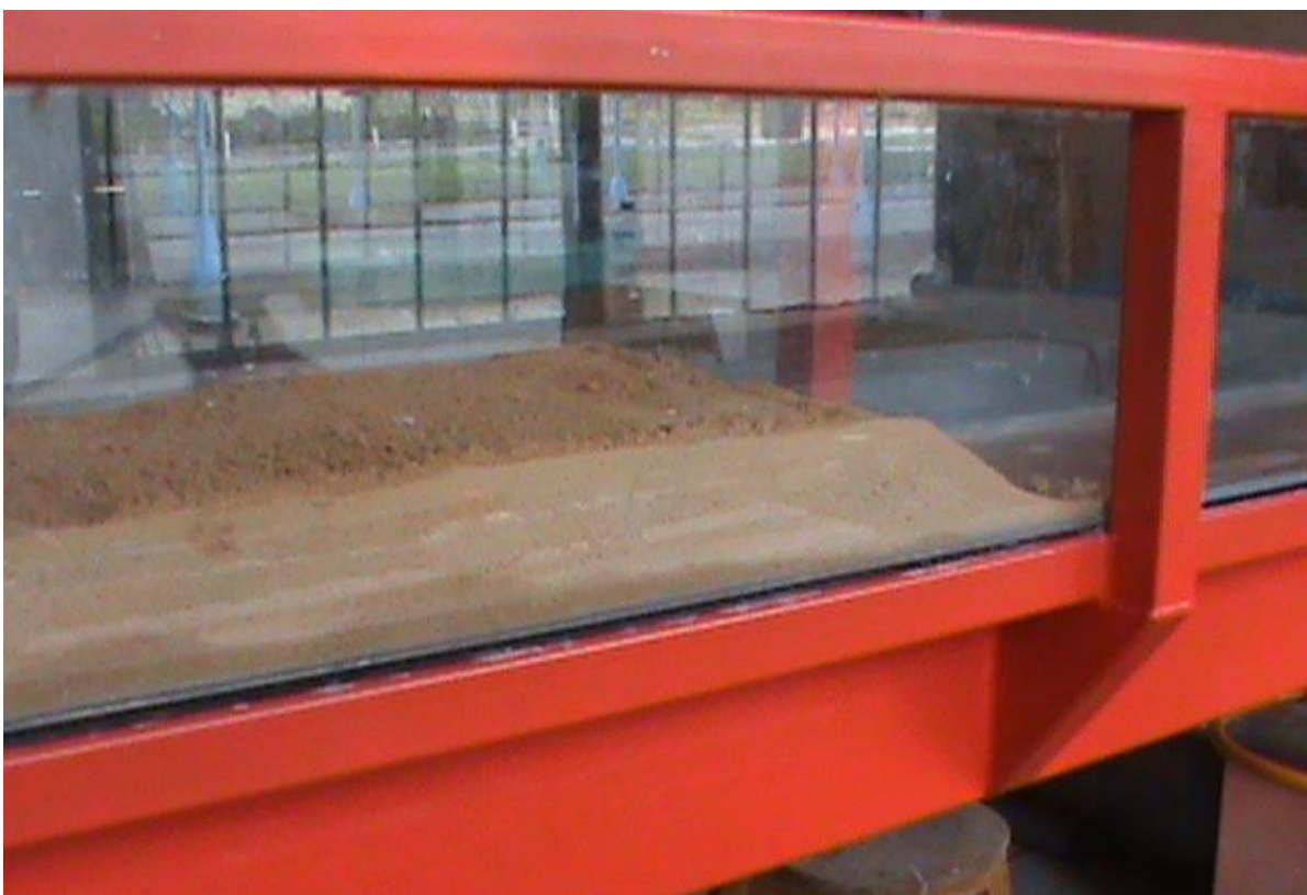
Figura 9: Conformación del cauce modelado para el ensayo.
