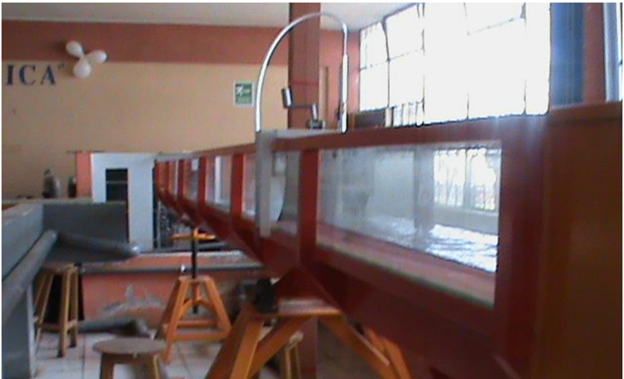
Figura 7: Canal de pendiente variable del laboratorio para el modelaje.
