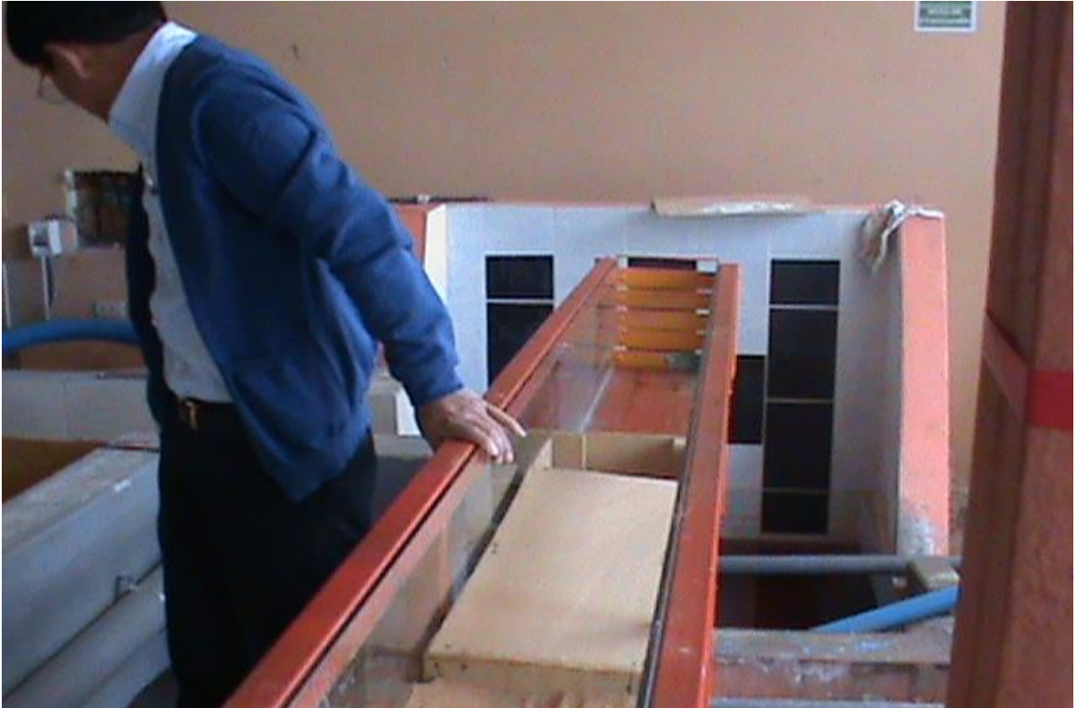
Figura 10: Colocación de soporte para desarenación a la salida del flujo en el modelo.
