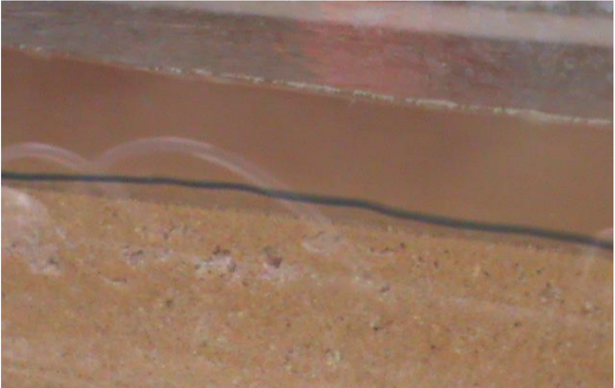
Figura 12: Zona socavada en el modelo, por acción del flujo (debajo de línea negra)
