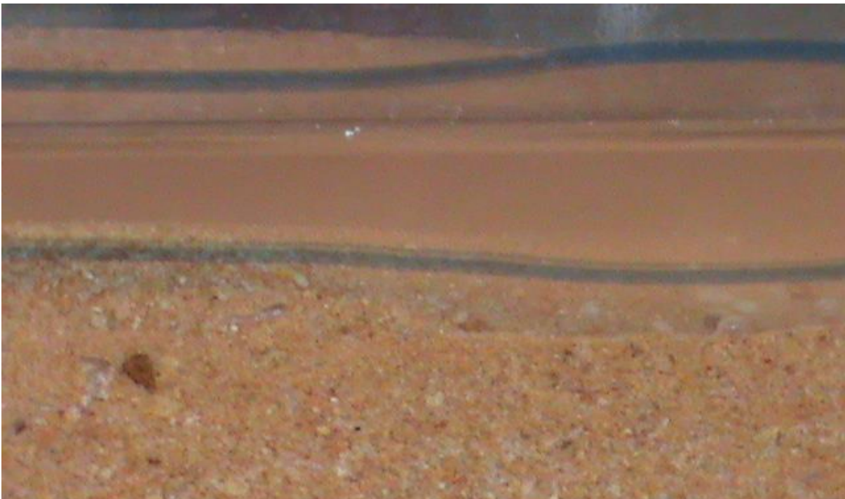
Figura 15: Socavación final en el modelo (Espacio entre líneas negras)
