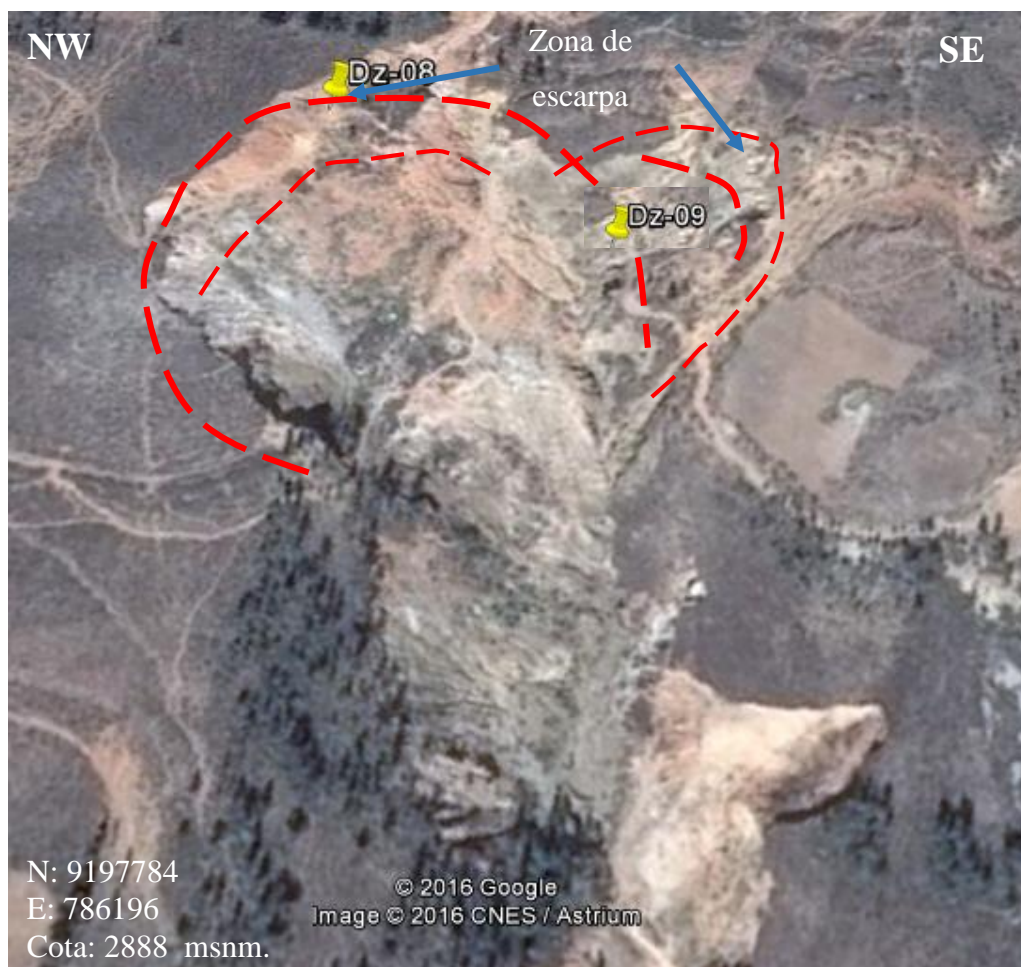
Figura N° 37: Imagen satelital del Dz-08 y Dz-09 en la estación N° 5, el eje principal del Dz-08 está en dirección SW y del Dz-09 en dirección NE; ambos se encuentran sobre depósitos coluvio-aluviales.
