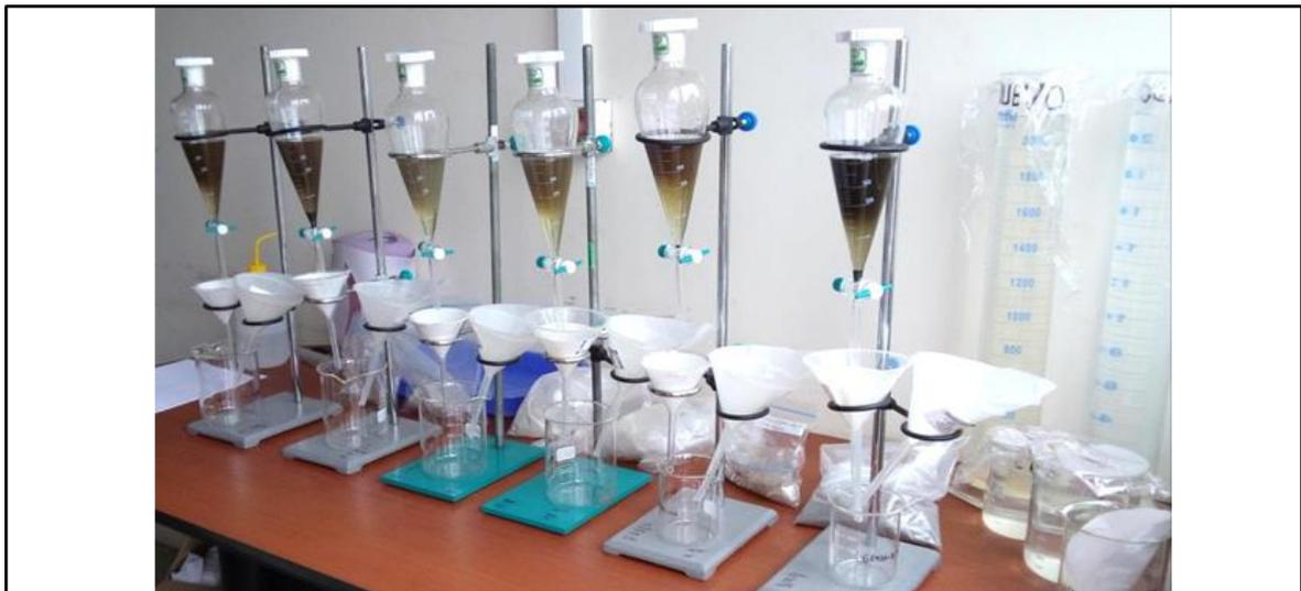
Figura 3. 29. Proceso de separación de minerales pesados usando politungstato de sodio. Laboratorio de Preparación mecánica de muestras, INGEMMET.
