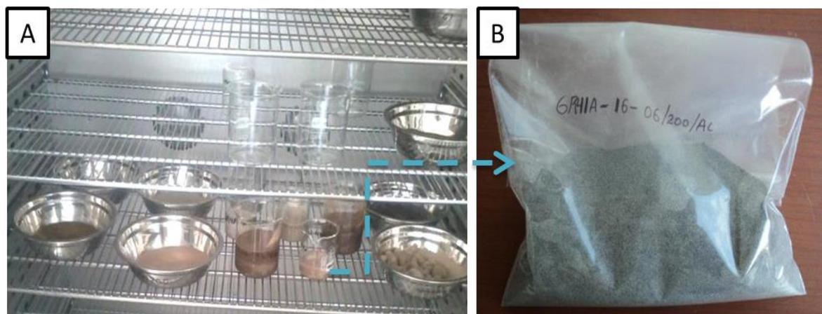
Figura 3. 24. A) Secado de la muestra en estufa eléctrica a Temperatura  $\leq 50^{\circ}\text{C}$ : B) Muestra extraída de la estufa, codificada y pesada con balanza de miligramos.
