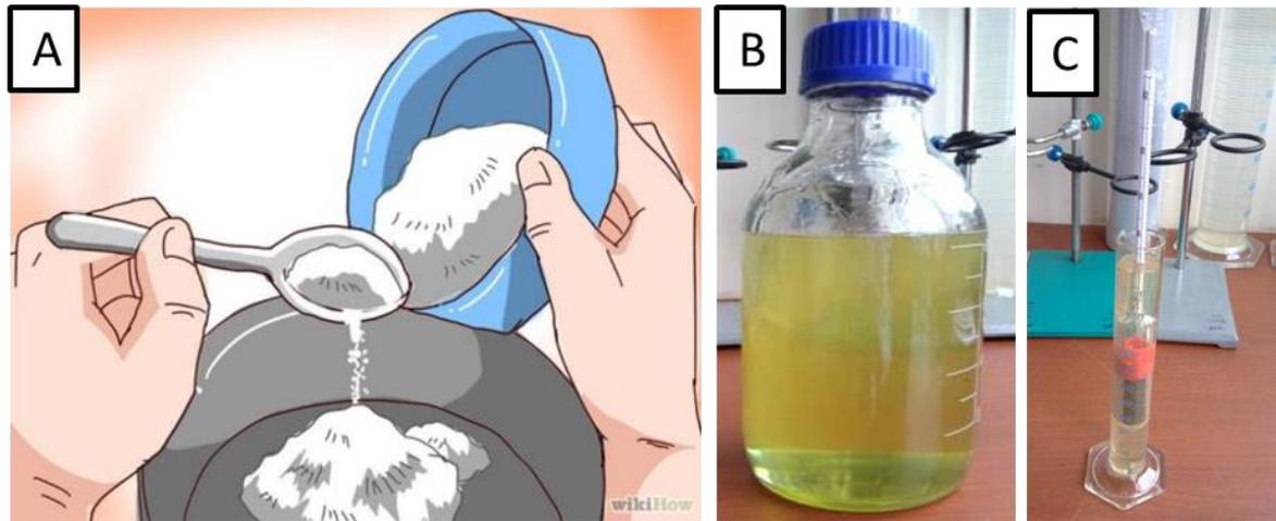
Figura 3. 25. A) Representación del Politungstato de sodio en fase sólida, B) PS preparado y C) medida de la densidad de Politungstato de sodio (PS).
