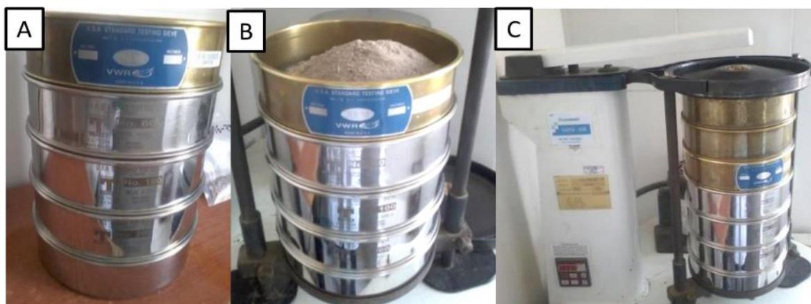
Figura 3. 19. A) Tamices utilizados para seleccionar la muestra por su granulometría (mallas N°10, N°60, N°100, N°200 y base), en B) muestra triturada lista para ser tamizada y C) tamizador RO-TAP.
