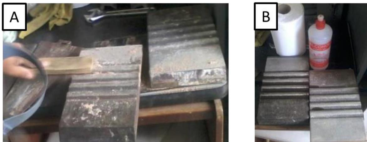
Figura 3. 17. A y B) Limpieza de mandíbula de la chancadora secundaria con alcohol y cepillo metálico.
