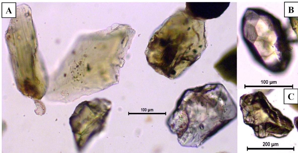
Figura 4. 21. Minerales pesados identificados al microscopio, en A) piroxenos y titanita de GR41A-16-09, B) zircón y C) titanita de la muestra GR41A-16-10 (ver proporciones en la Figura 4.20).
