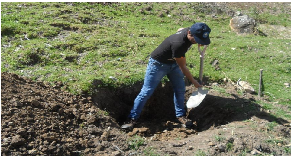
Figura D.27: Exploración de las calicatas.
