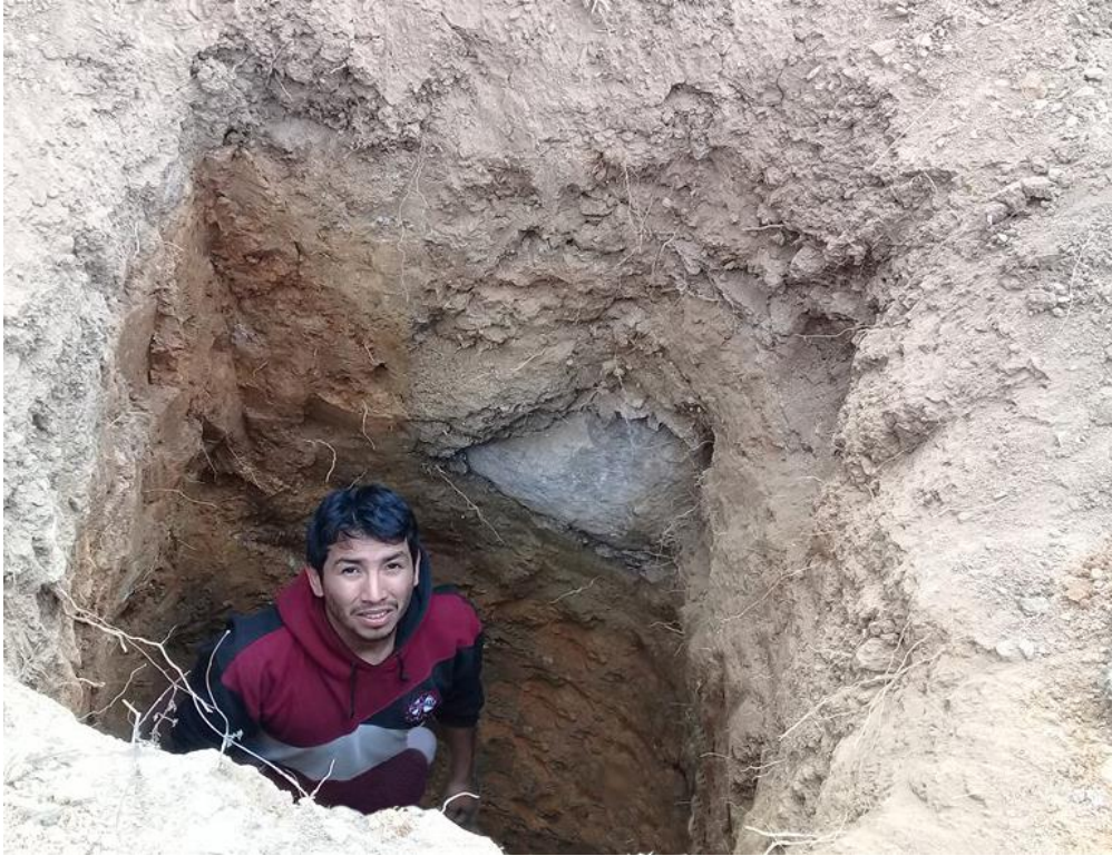
Figura D.59: Profundidad de la calicata C-5 = 2.50m..
