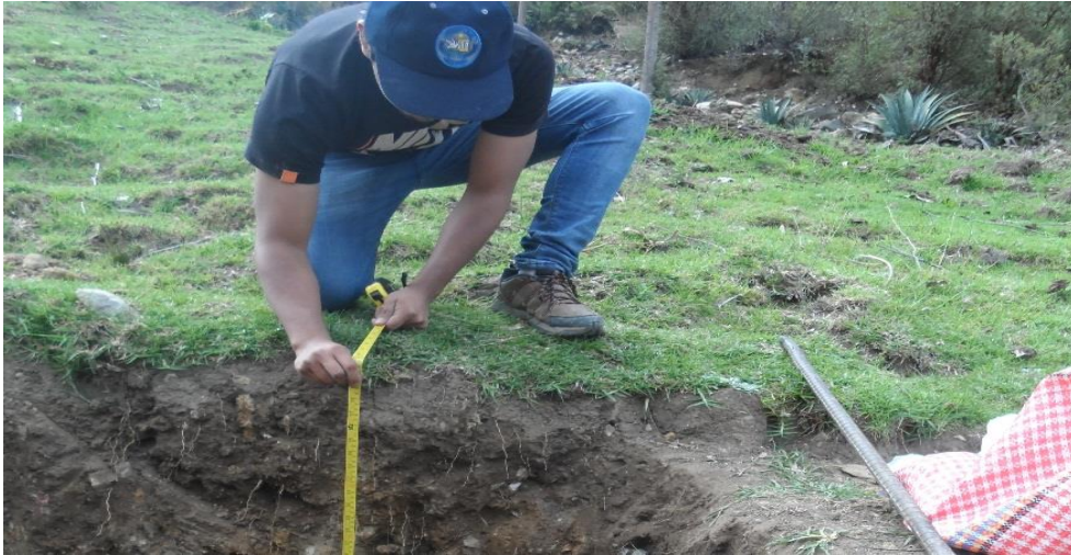
Figura D.28: Profundidad de la calicata C-1 = 1.20m.
