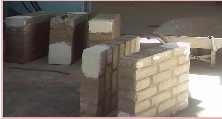
Figura 35. Muretes de albañilería.
