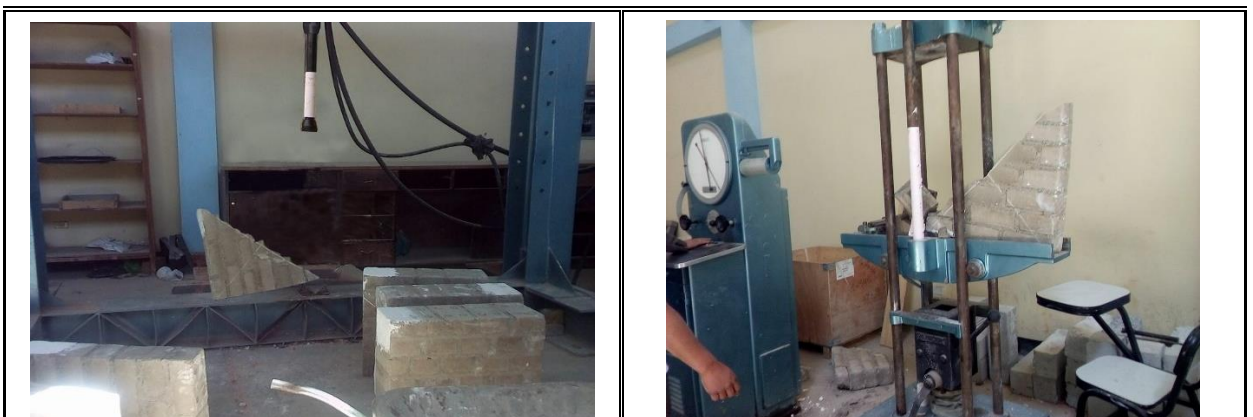
Imagen N°19.- Falla típica muretes de ladrillo de suelo-cemento compactado con el mortero óptimo.
