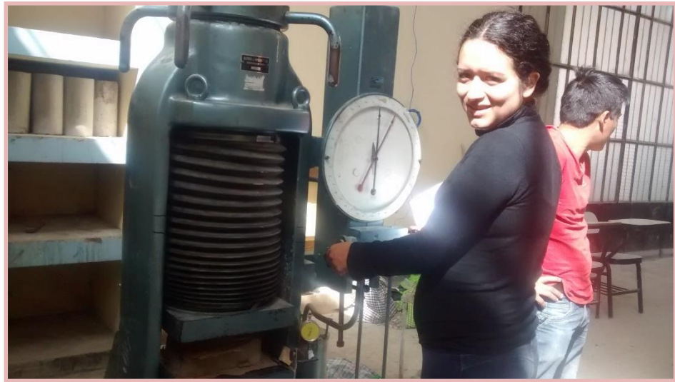
Figura 28. Realizando el ensayo a compresión axial de ladrillos alternativo suelo-cemento compactado en la máquina universal.
