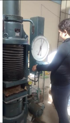
Imagen N°08.- Ensayo a compresión de ladrillo alternativo sin cocción.
