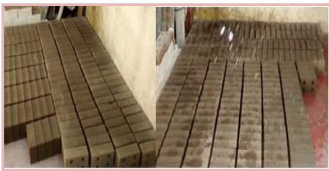
Figura 9. Acopio y curado de ladrillos de suelo-cemento compactado.
