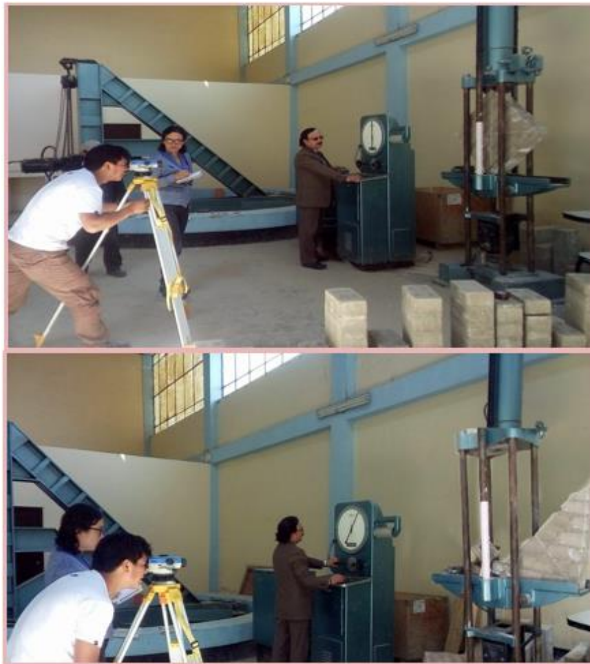
Figura 36. Ensayo a compresión de los Muretes de albañilería.
