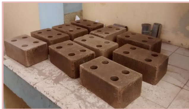
Figura 1. Ladrillos alternativos de suelo-cemento compactado en Laboratorio de Universidad Nacional de Cajamarca.
