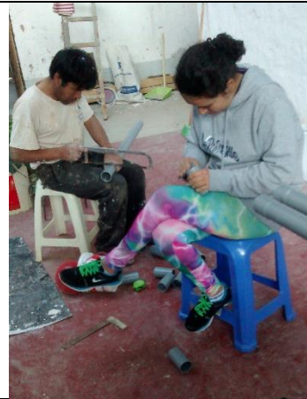
Imagen N°14.- Elaboración de moldes para especímenes de morteros..
