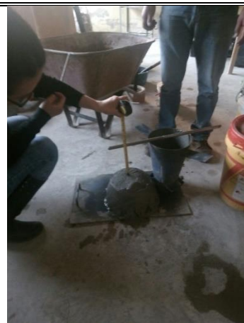
Imagen N°12.- Realizando el test de Slump para los morteros.
