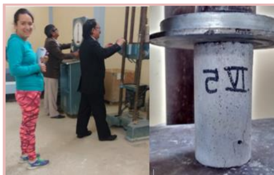
Figura 33. Ensayo a compresión del mortero.
