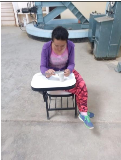
Imagen N°16.- Toma de medidas de Especímenes de mortero con Bernier.
