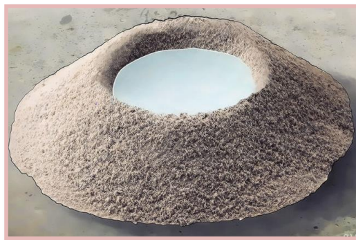
Figura 17. Agregado de agua a la mezcla en seco.
