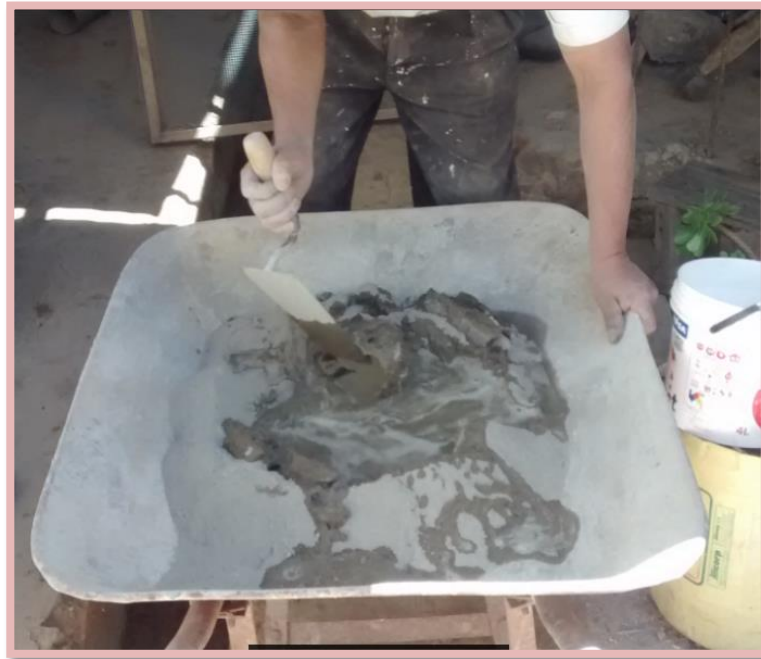
Figura 24. Mezcla de suelo, cemento y agua para elaboración de ladrillo alternativo.
