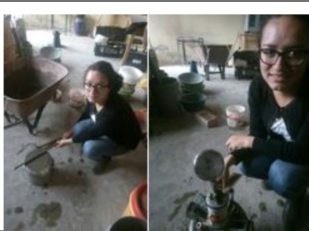
Imagen N°13.- Aire atrapado en morteros, ensayo de la olla de Washington.
