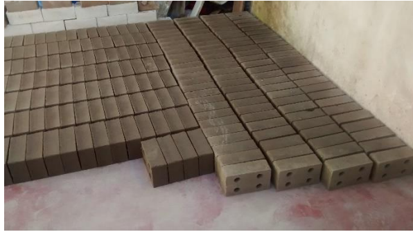
Imagen N°07.- Acopio y curado de ladrillo alternativo de suelo – cemento compactado.
