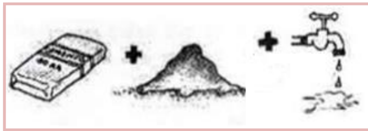
Figura 6. Ilustración de materiales para realizar el mezclado en seco de suelo con cemento, la mezcla debe quedar uniforme.
