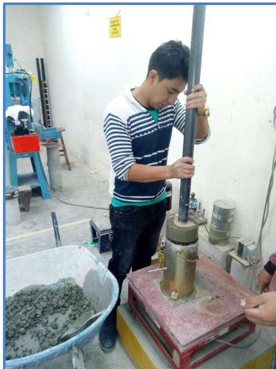
Figura 41. Ensayo Vebe por Capas.
