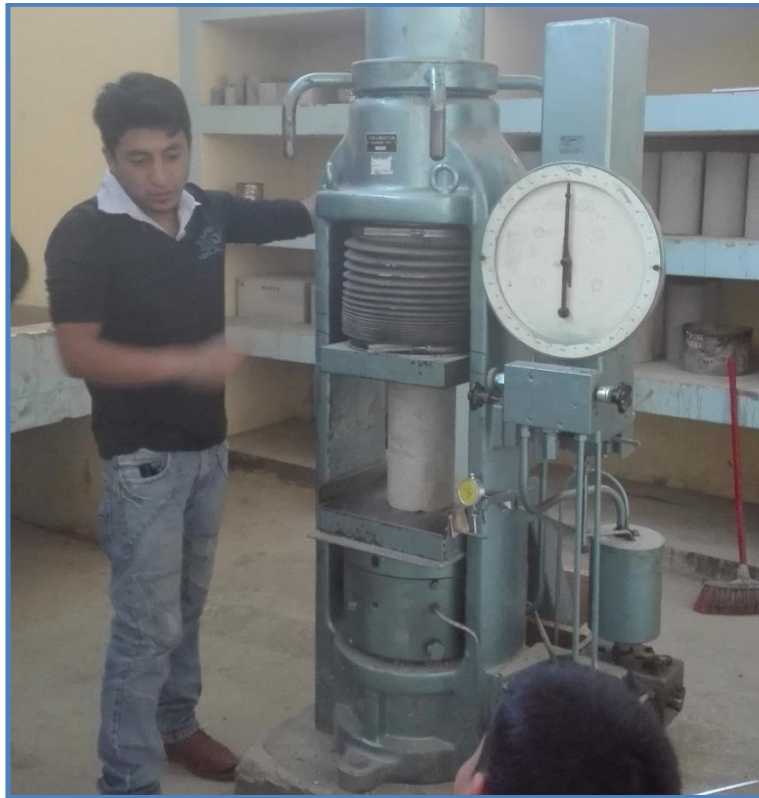
Figura 37. Lectura del Deformímetro para los diagramas de esfuerzo Vs deformación unitaria
