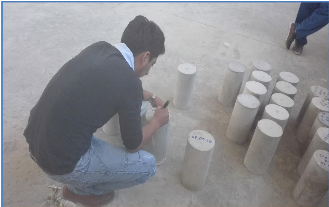
Figura 33. Codificación de los especímenes de concreto.
