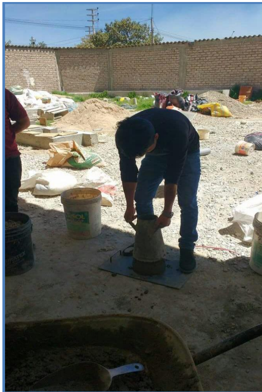
Figura 29. Ensayo de Slump de la mezcla de concreto
