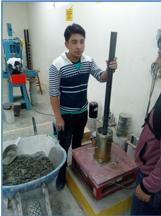
Figura 40. Ensayo Vebe por Capas.
