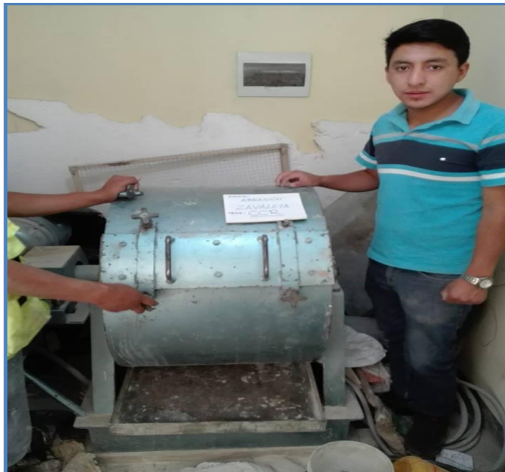
Figura 25. Ensayo de abrasión con la Máquina de los Ángeles.
