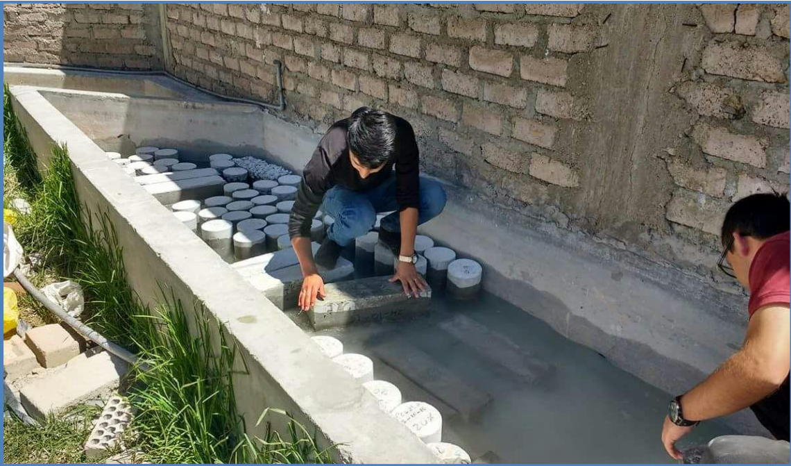
Figura 34. Curado de los especímenes de concreto.
