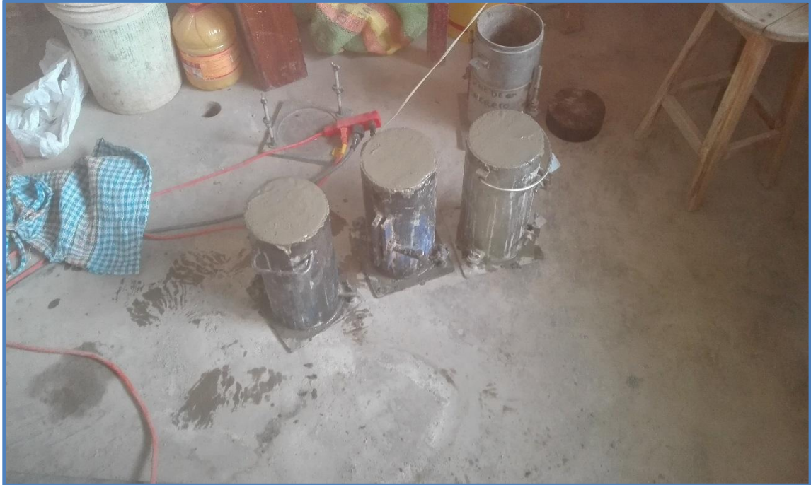
Figura 32. Vista de los especímenes luego de ser elaborados con compactación.
