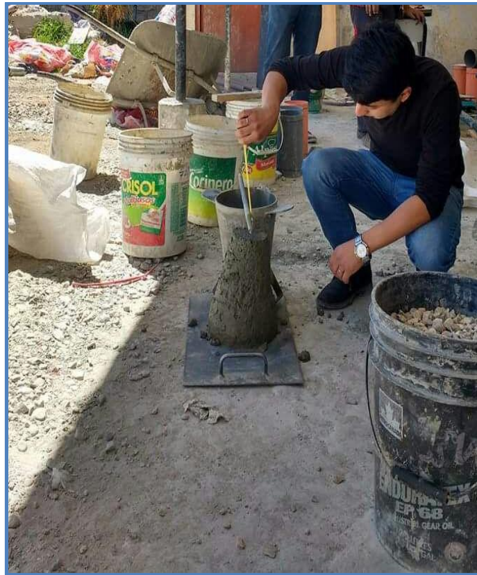
Figura 30. Medida del asentamiento de la mezcla de concreto.
