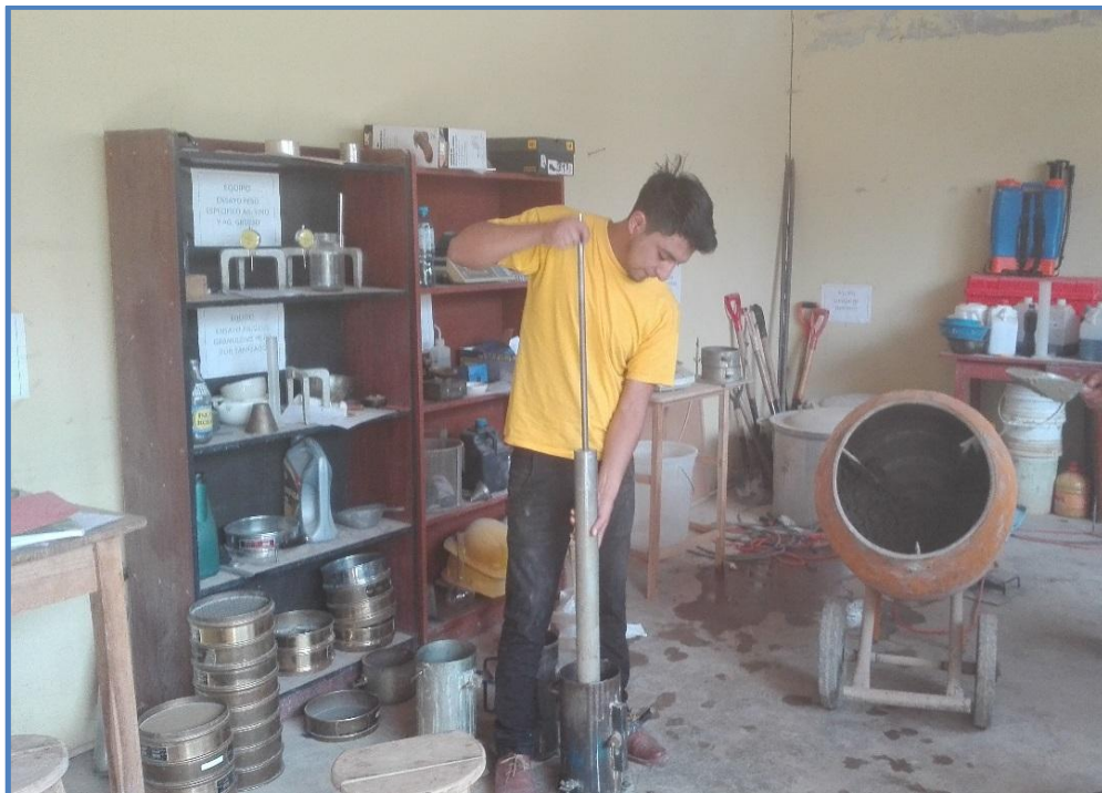
Figura 31. Compactación de los especímenes de concreto.
