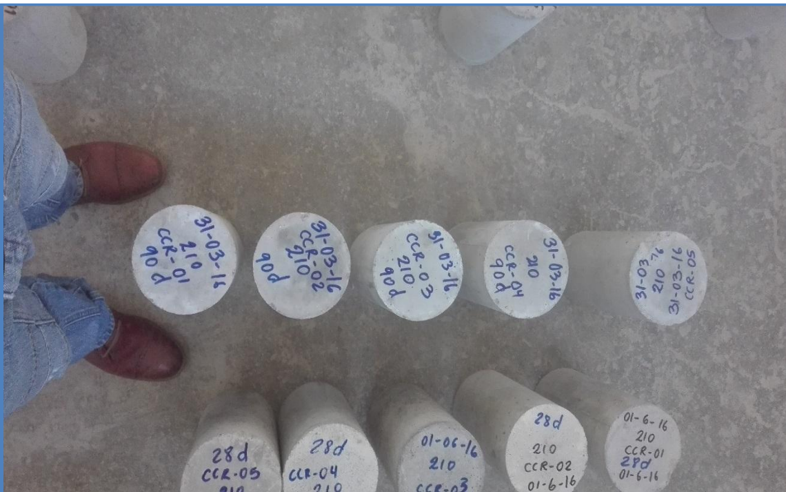
Figura 35. Especímenes codificados para ser ensayados a compresión Uniaxial.
