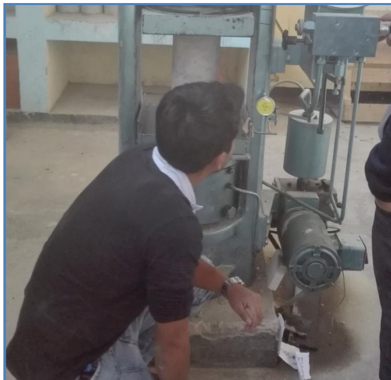
Figura 37. Lectura del Deformímetro para los diagramas de esfuerzo Vs deformación unitaria
