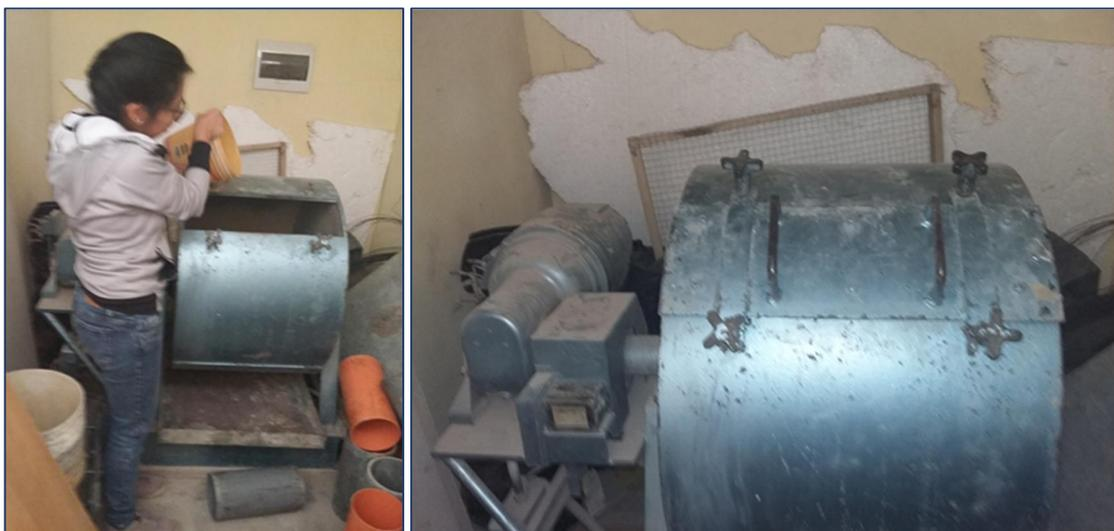
Figura 57. Ensayo de abrasión en la máquina Los Ángeles.
