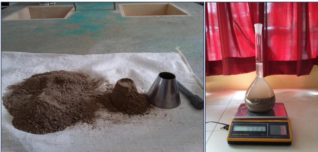
Figura 54. Agregado fino saturado superficialmente seco, frasco lleno con muestra y agua hasta la marca de 500cm<sup>3</sup>.
