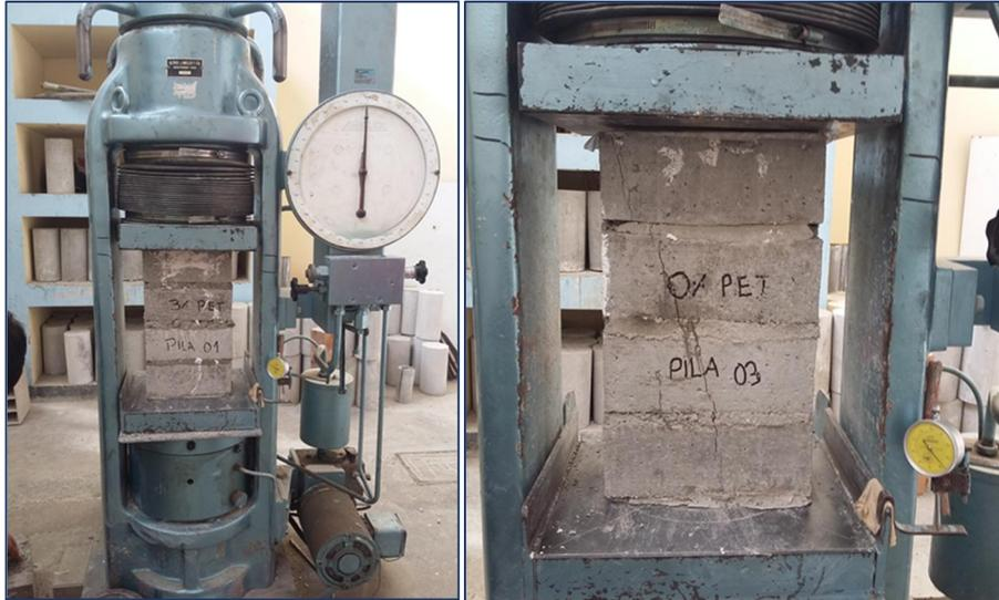
Figura 79. Ensayo de compresión axial de pilas de ladrillos de concreto.
