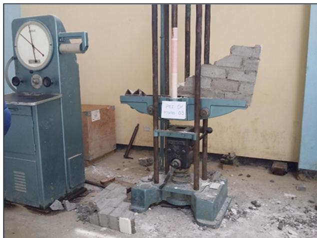
Figura 81. Ensayo de corte en murete de ladrillos con PET 0%. Falla típica.
