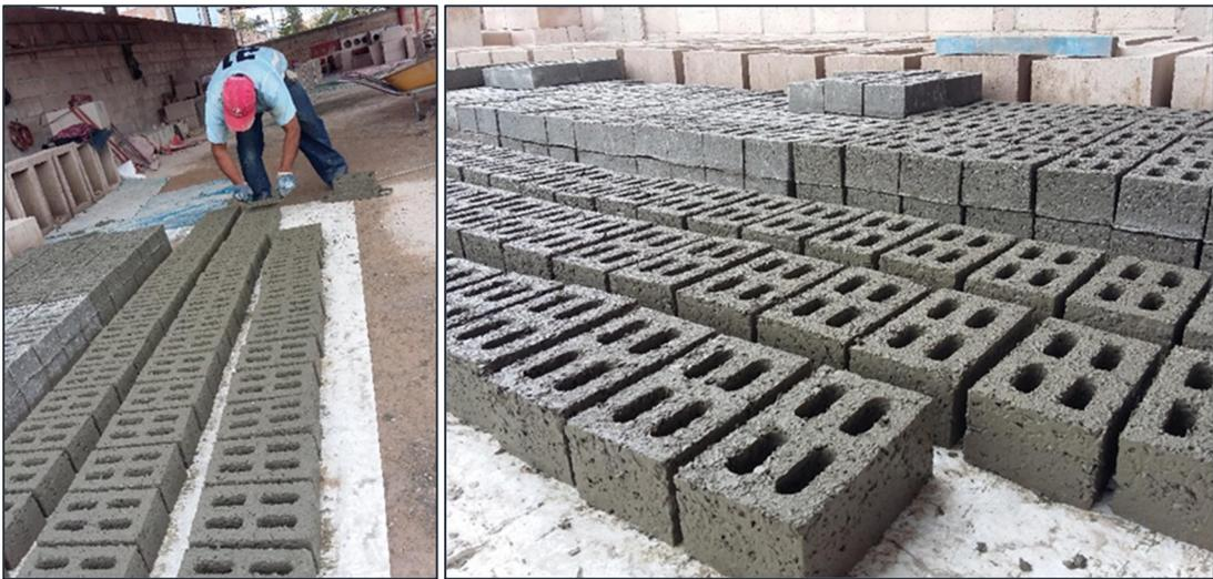
Figura 68. Desmolde y curado de los ladrillos de concreto vibrado con PET
