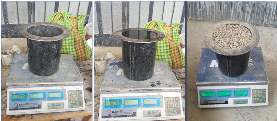
Figura 56. Recipiente metálico: vacío, con agua, con agregado (confitillo).
