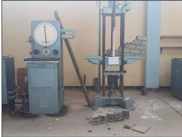
Figura 82. Ensayo de corte en murete de ladrillos con PET 3%. Falla típica.
