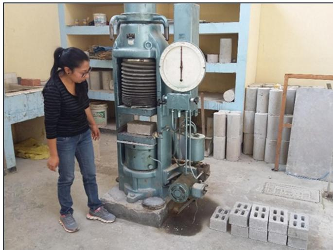
Figura 63. Ensayo de compresión de los ladrillos de prueba.
