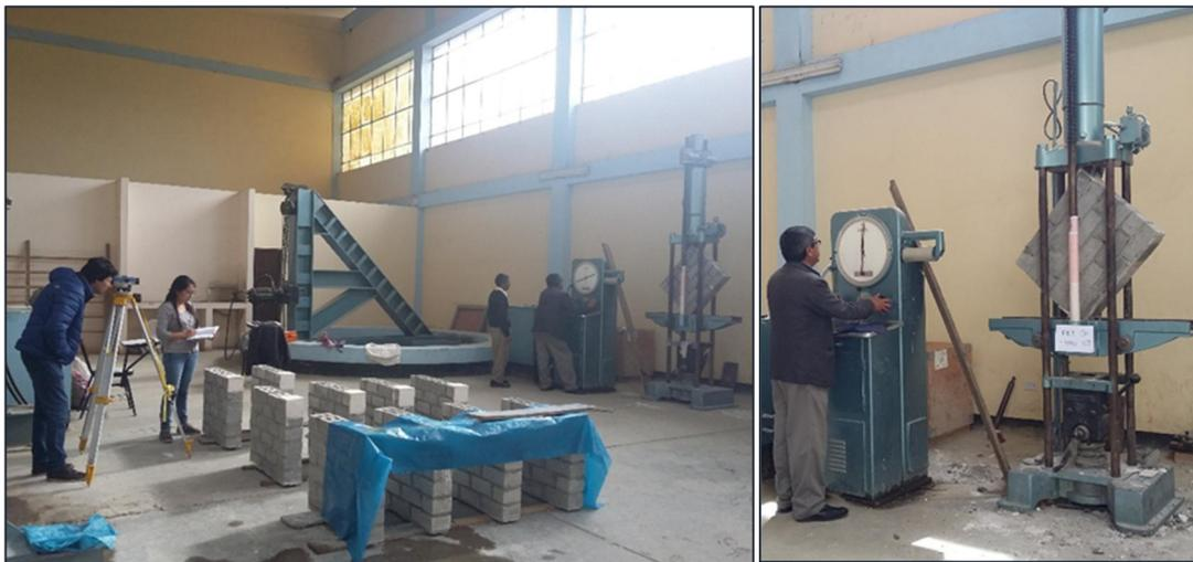
Figura 80. Ensayo de corte en muretes de albañilería.
