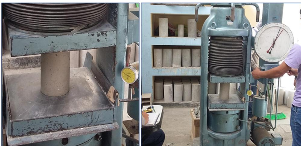
Figura 78. Ensayo a compresión del mortero.
