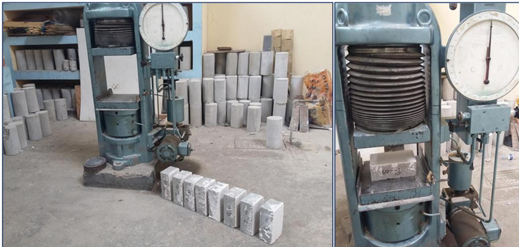
Figura 74. Ensayo de resistencia a compresión de los ladrillos de concreto.
