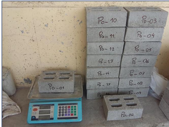
Figura 70. Registro del peso de cada ladrillo de concreto.
