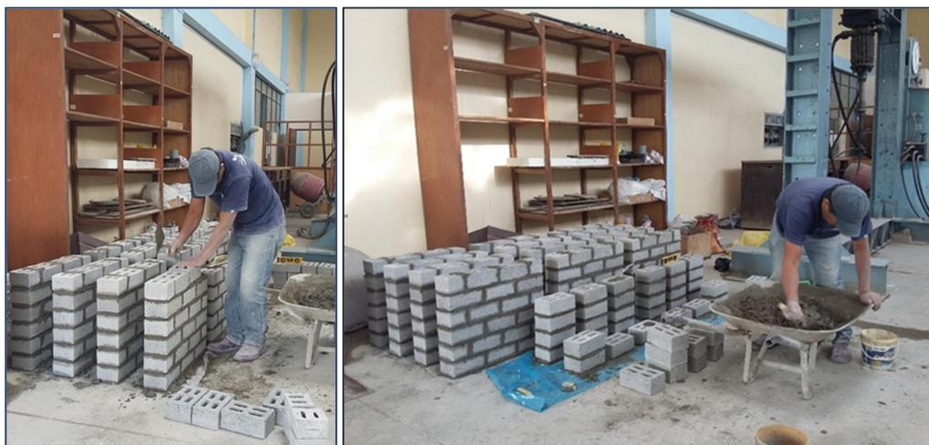
Figura 75. Construcción de pilas y muretes de albañilería simple.
