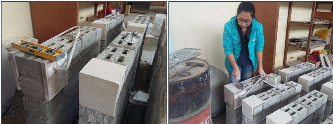
Figura 77. Aplicación del capping en los muretes de albañilería simple.
