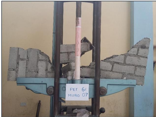
Figura 83. Ensayo de corte en murete de ladrillos con PET 6%. Falla típica.
