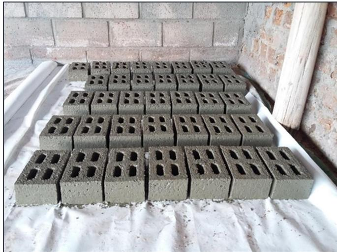
Figura 62. Reposo y curado de los ladrillos de prueba.
