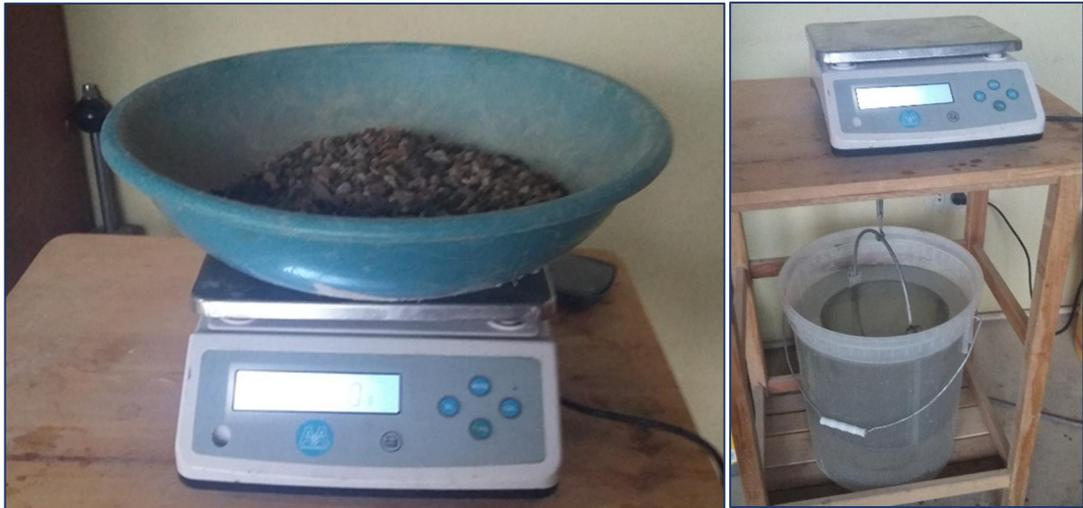
Figura 55. Confitillo en estado s. s. s. más canastilla sumergidos en agua.
