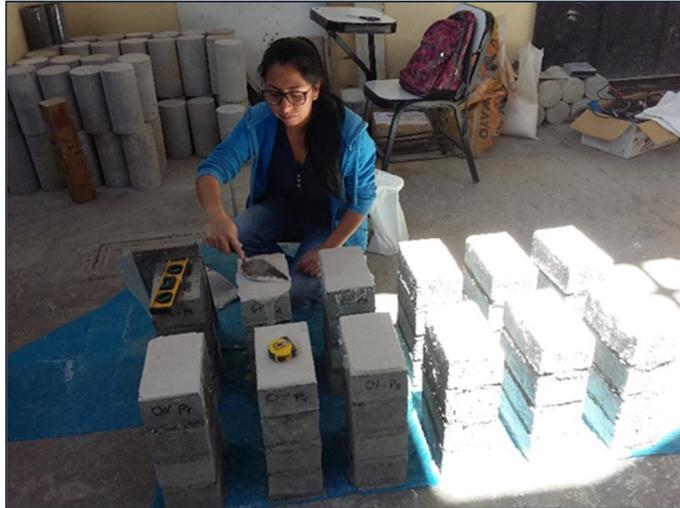
Figura 76. Aplicación del capping en las pilas de albañilería.
