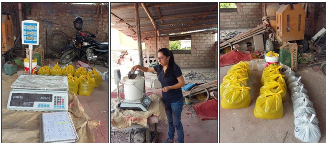
Figura 60. Determinación de pesos de los agregados de las mezclas prueba.
