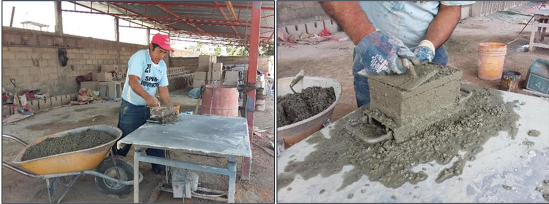
Figura 67. Modelado de la mezcla de concreto en la mesa vibradora.
