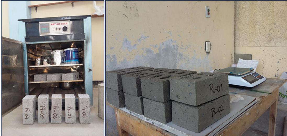
Figura 73. Ladrillos de concreto secados en la estufa y saturados.
