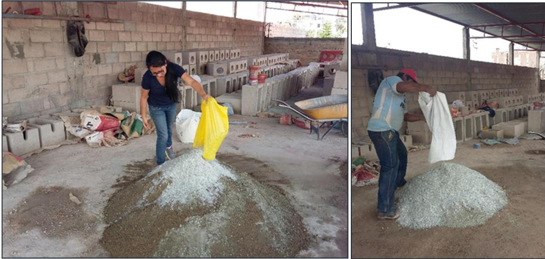
Figura 64. Adición de las hojuelas de PET a la mezcla de ladrillos de concreto vibrado.
