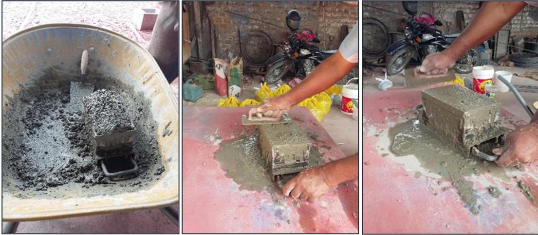
Figura 61. Fabricación de ladrillos con las mezclas de prueba
