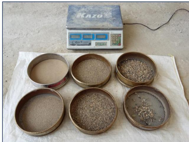
Figura 53. Tamices y balanza utilizados en el ensayo granulométrico
