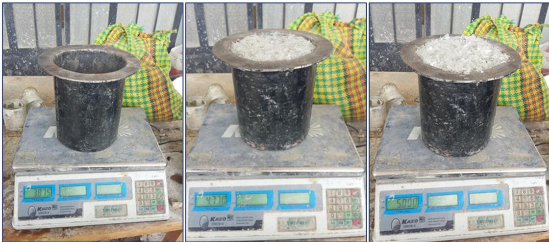
Figura 59. Recipiente metálico: vacío, con hojuelas de PET suelto y PET compactado.
