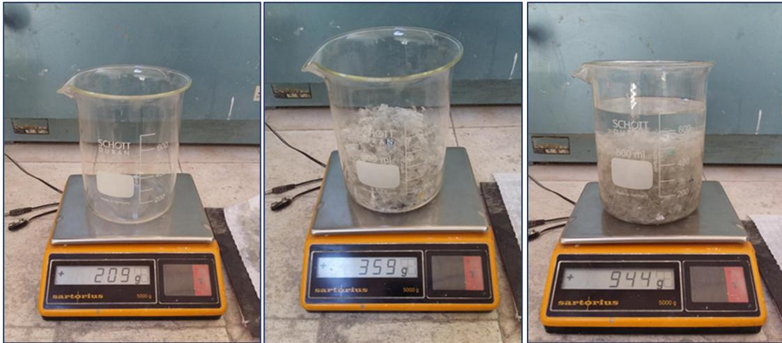
Figura 58. Recipiente vacío, con hojuelas de PET y con hojuelas de PET más agua.
