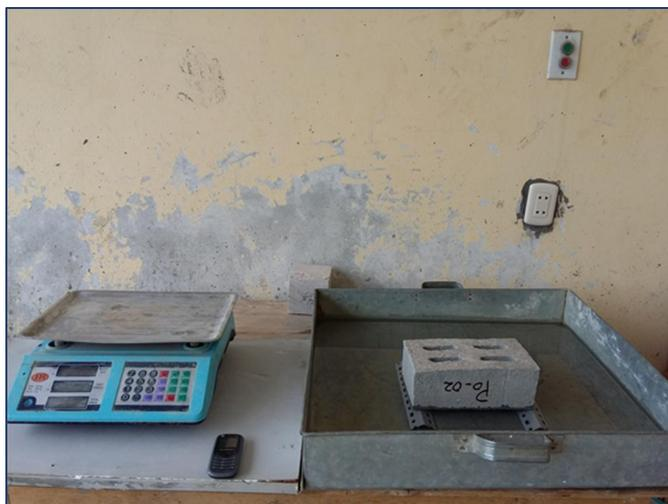
Figura 72. Ladrillo de concreto sobre bandeja metálica con agua.
