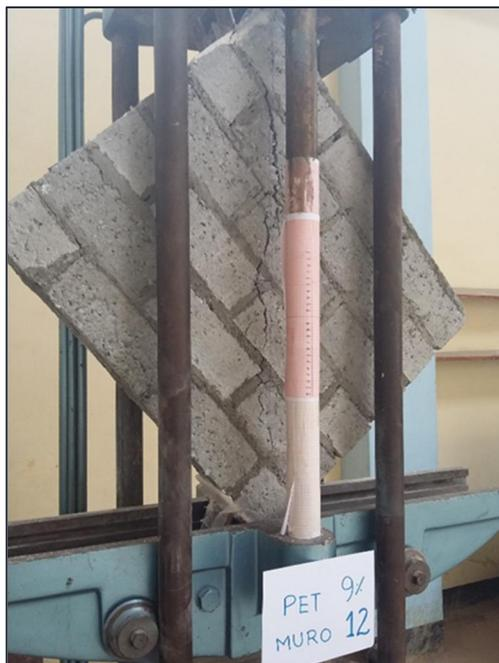
Figura 84. Ensayo de corte en murete de ladrillos con PET 9%. Falla típica.
