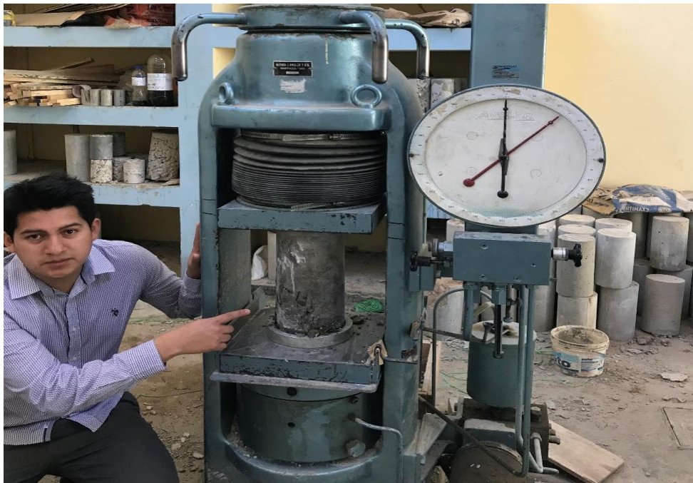
Fotografía 2. Rotura de probetas a los 28 días para un concreto de resistencia a la compresión de 210 \text{ Kg/cm}^2 , en el Laboratorio de Ensayo de Materiales de la UNC.
