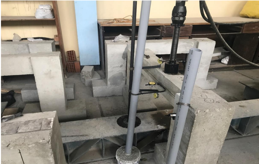
Fotografía 7. Pre - ensayo de un pórtico de concreto armado en la maquina universal de 100 ton para determinar donde se producen las deformaciones.
