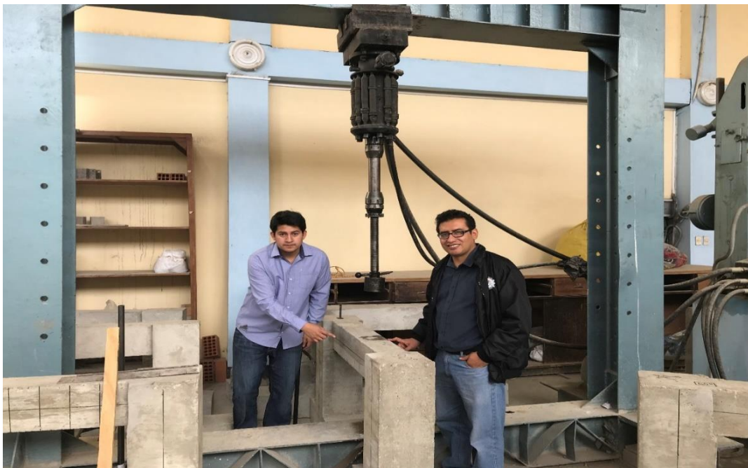
Fotografía 8. Asesor y Tesista verificando fisuras producidas por el esfuerzo cortante en las vigas de concreto armado.
