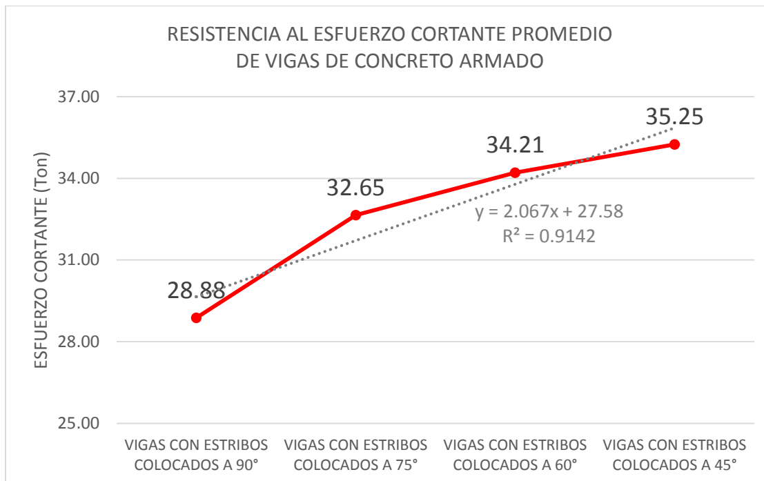
Figura 43. Gráfico de esfuerzos cortantes promedio y vigas de concreto armado con estribos inclinados.
