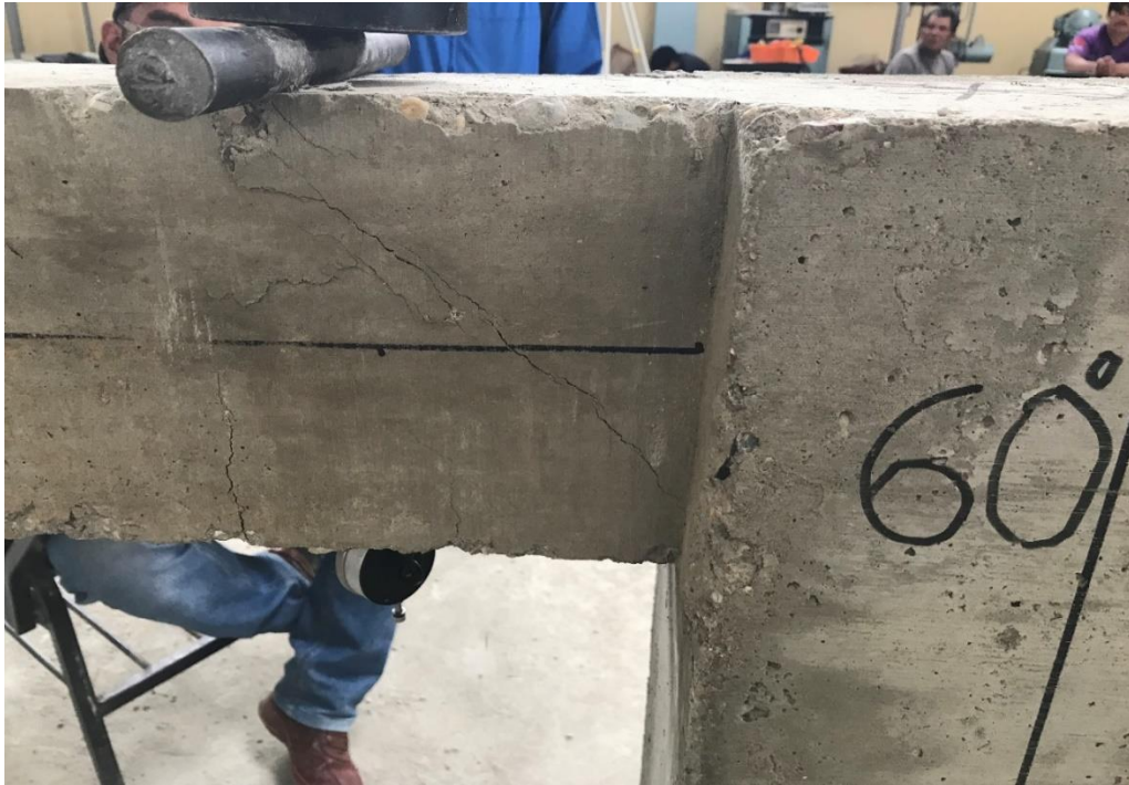
Fotografía 11. Falla producida por esfuerzo cortante en viga con estribos colocados a 60^\circ con respecto al acero longitudinal.
