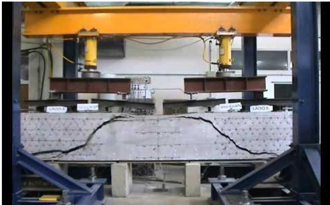
Figura 1. Falla por tensión diagonal producida por esfuerzo cortante en viga.
