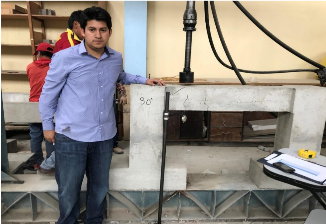
Fotografía 9. Falla producida por esfuerzo cortante en viga con estribos colocados a 90° con respecto al acero longitudinal.
