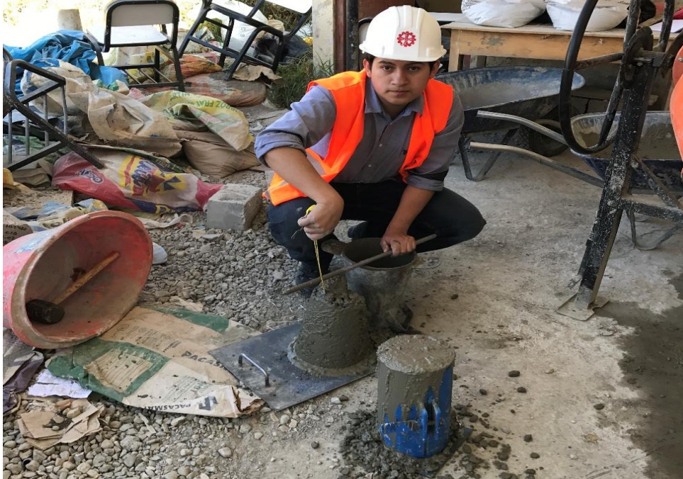
Fotografía 1. Diseño de mezcla para un concreto con f'c = 210 \text{ Kg/cm}^2 en el Laboratorio de Ensayo de Materiales de la UNC.
