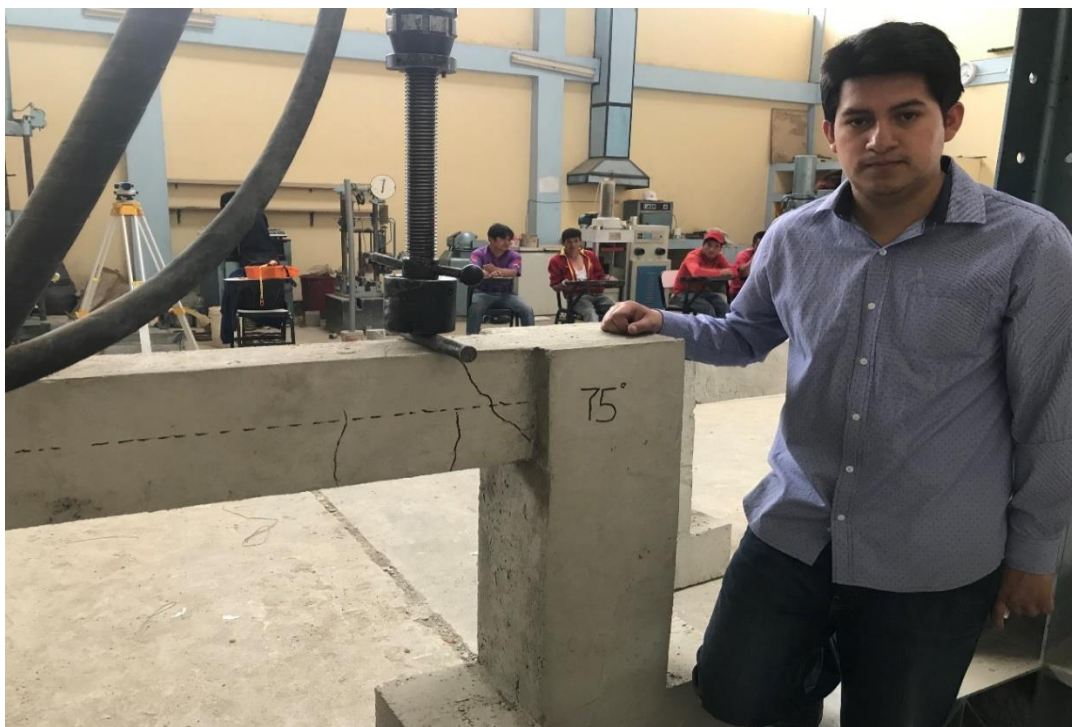
Fotografía 10. Falla producida por esfuerzo cortante en viga con estribos colocados a 75° con respecto al acero longitudinal.
