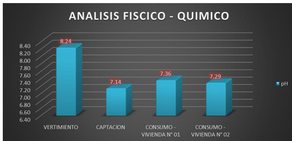
Figura 12. pH de las muestras de agua realizadas
