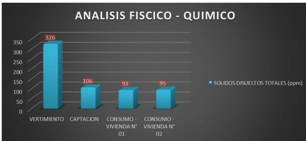
Figura 15. Sólidos Disueltos Totales de las muestras de agua realizadas
