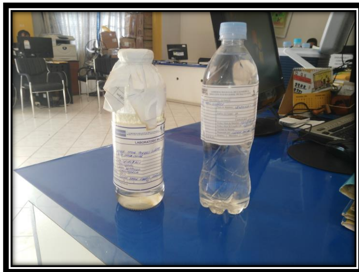
Figura 06. Frascos utilizados para muestreo físico – químico y bacteriológico debidamente etiquetados
