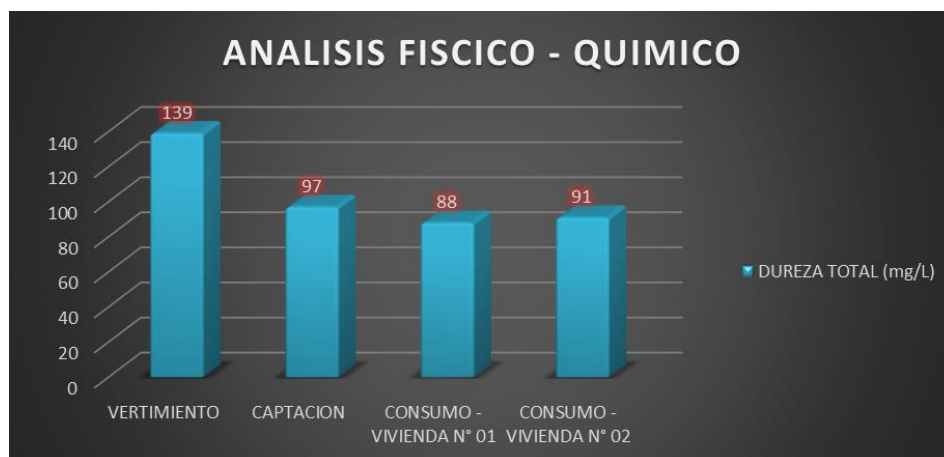
Figura 13. Dureza Total de las muestras de agua realizadas
