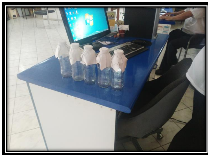
Figura 05. Frascos de vidrio utilizados para muestreo bacteriológico
