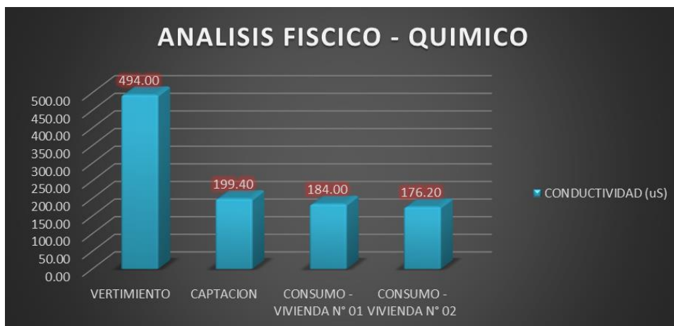
Figura 14. Conductividad de las muestras de agua realizadas
