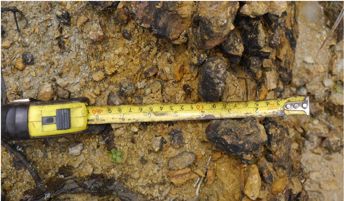
Figura 3.6. Medida directa de espesor de estratos con la ayuda de un flexómetro.
