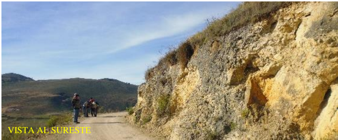
Figura 3.11. Intercalación de calizas en estratos medios con arcillitas amarillentas del Gpo. Pulluicana, carretera Celendín - La Huaylla.
