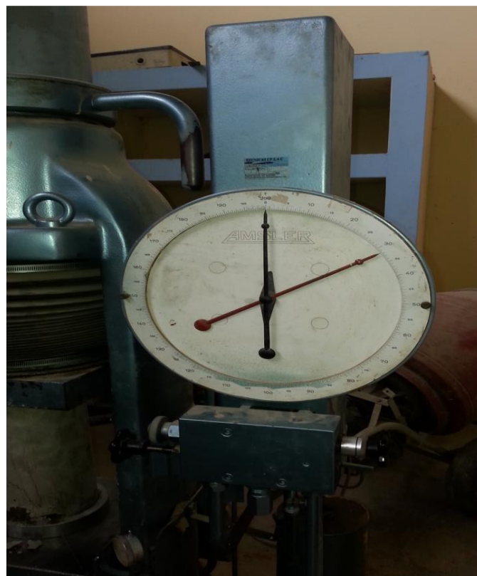
FOTO N° 12: Dial de lectura de la maquina a compresion.
