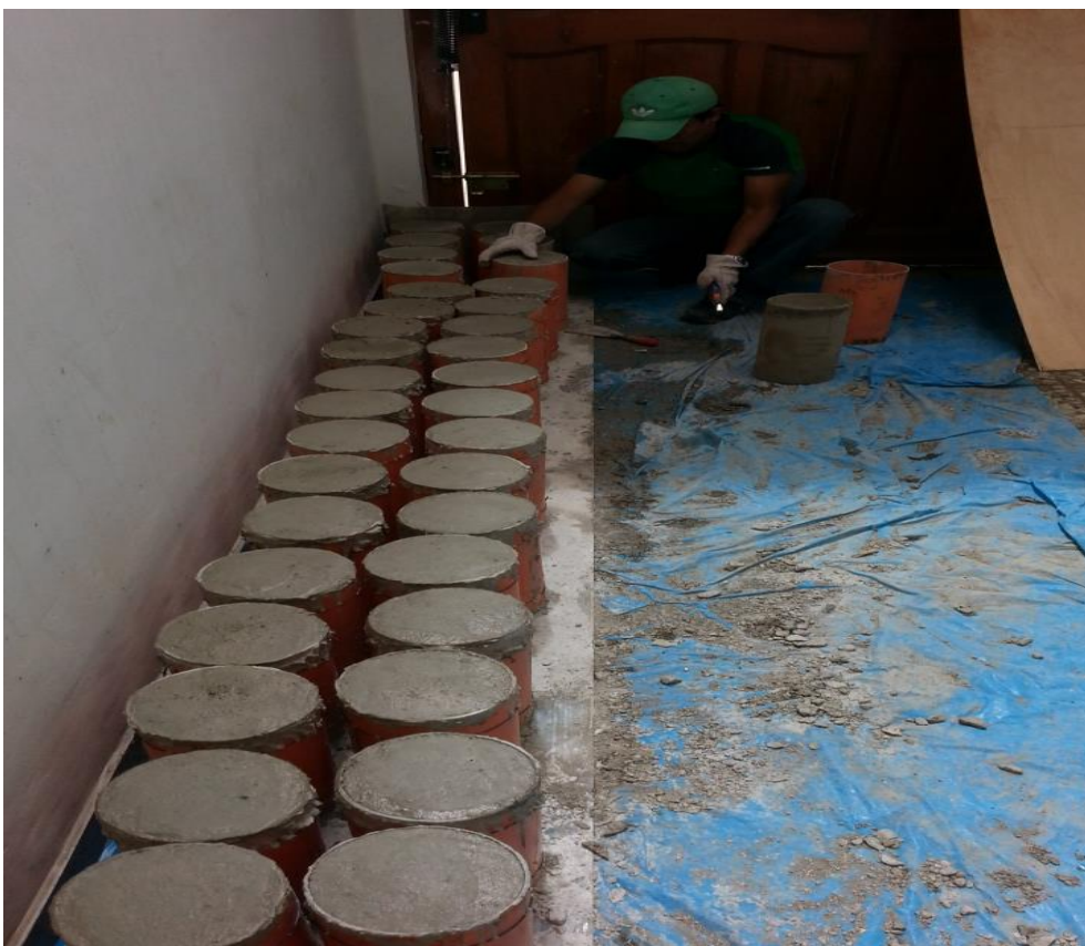
FOTO N° 7: especímenes de concreto.
