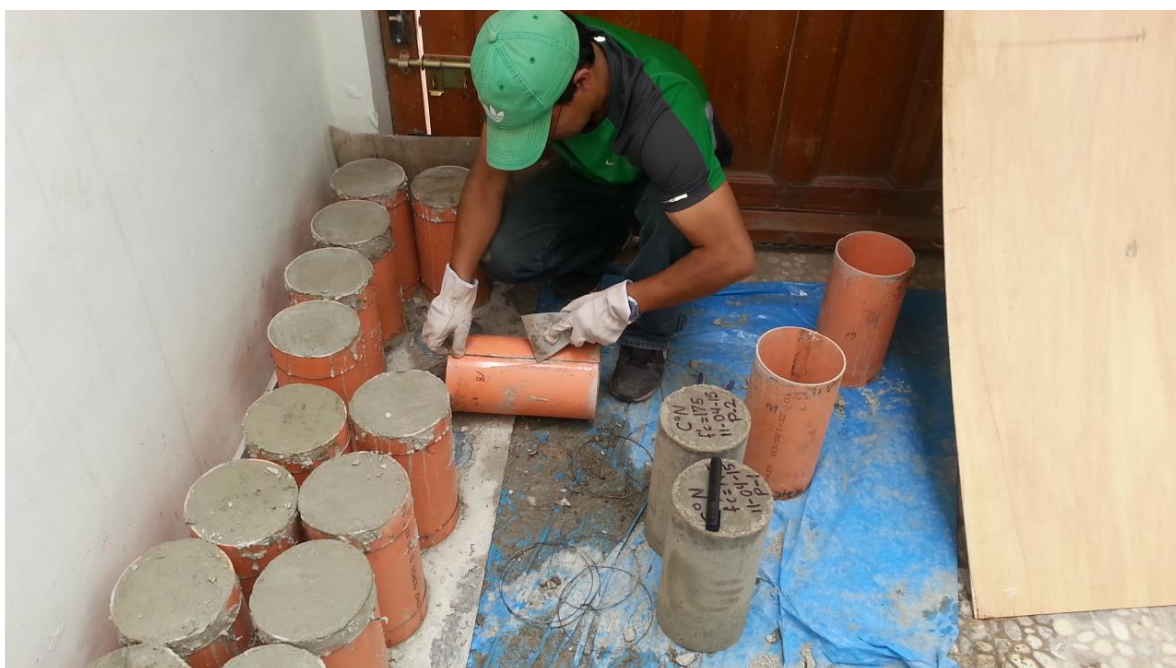
FOTO N° 8: desencofrado de los especímenes de concreto para posterior curado y para se ensayados a la compresion.
