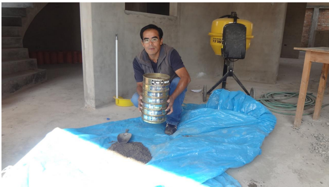
FOTO N° 15: Vista análisis granométrico del agregado fino.
