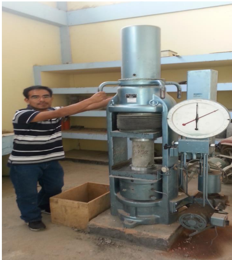
FOTO N° 12: Dial de lectura de la maquina a compresion.
