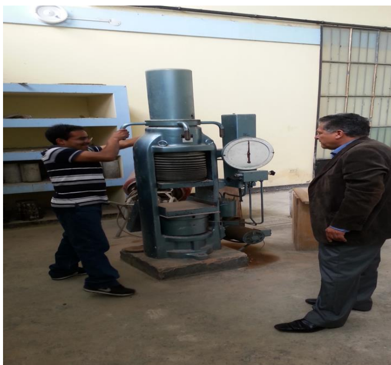
FOTO N° 10: Preparacion del equipo a a compresion para realizar el esnsayo correspondiente.
