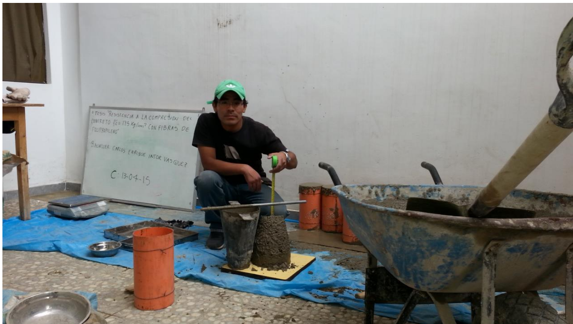
FOTO N° 5: ensayo de revenimiento del concreto
