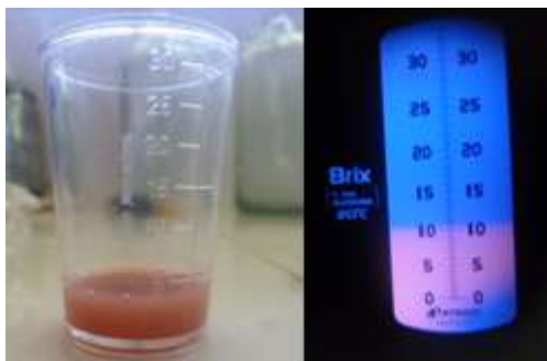
Figura 7. Zumo extraído de la fruta de pushgay (izquierda) y lectura de 10°Brix (derecha)
