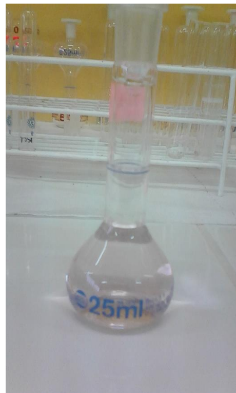
Figura 10. Dilución de extracto de antocianinas en \text{CH}_3\text{CO}_2\text{Na} 0,4 M pH 4,5
