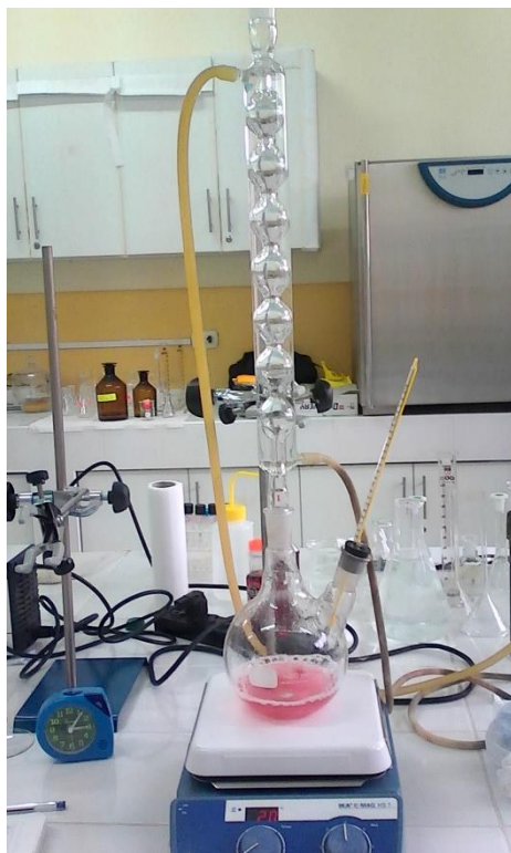
Figura 5. Extracción por destilación a reflujo
