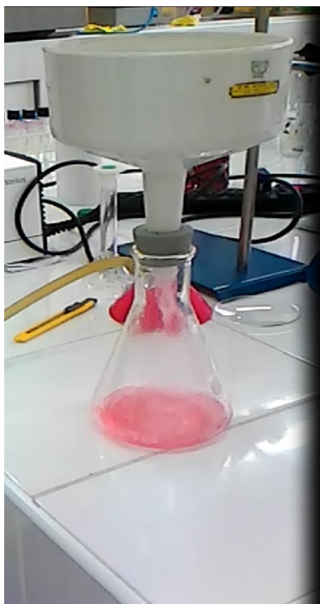
Figura 6. Filtración al vacío
