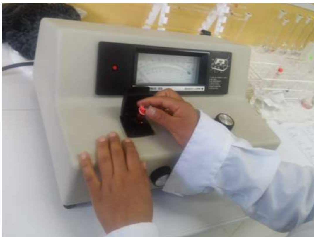
Figura 33. Lectura de la absorbancia en el espectrofotómetro
