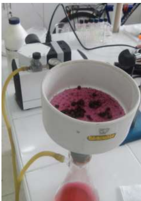
Figura 29. Filtrado al vacío
