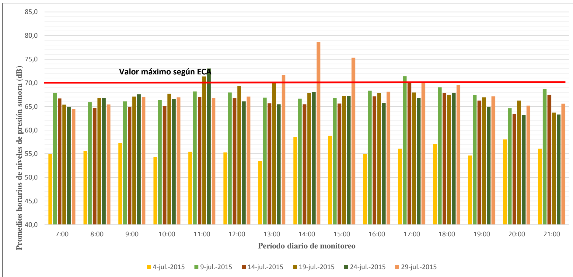
Figura 123: Variación de los LAeq horarios y comparación con el ECA para ruido, óvalo Augusto Gil, mes de julio.
