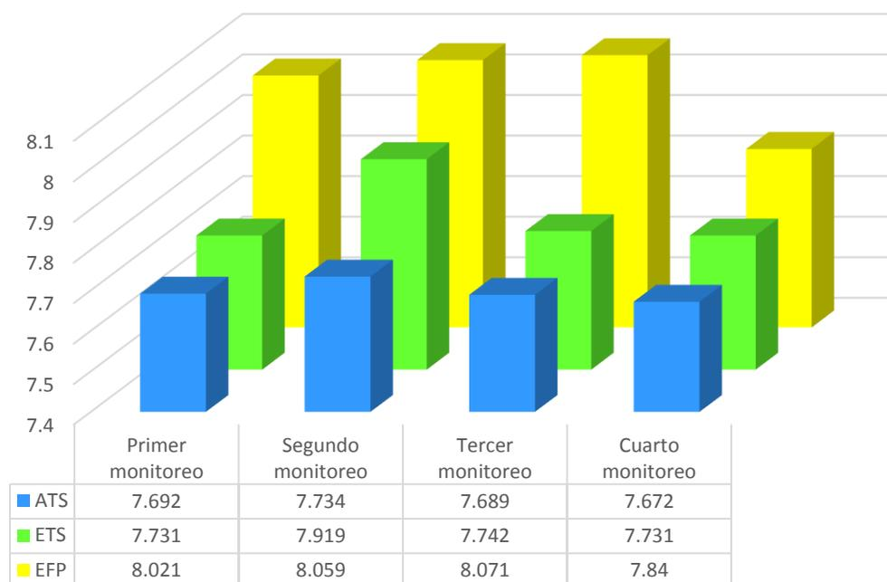
Figura 8 : Medición de pH en los puntos de monitoreo
