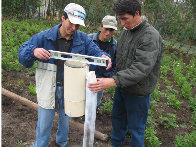
Figura 04. Instalación de Pluviómetro en campo experimental
