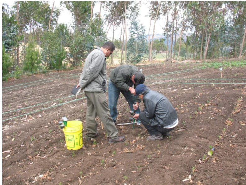
Figura 03. Instalación de tensiómetros en parcelas
