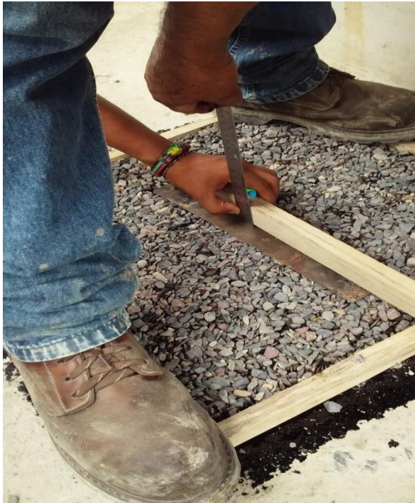
Figura 14. Determinación del espesor final donde se observa que el TSB fabricado en laboratorio con la gradación y dosificación establecida no cubre el espesor total del listón de 1" (2.5 cm).
