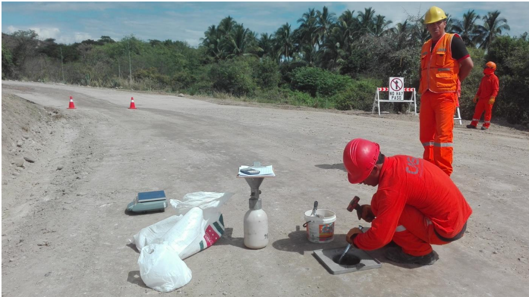
Figura 15. Vista donde se observa el muestreo en pista del material de mejoramiento para ser ensayadas en laboratorio – Julio 2016.
