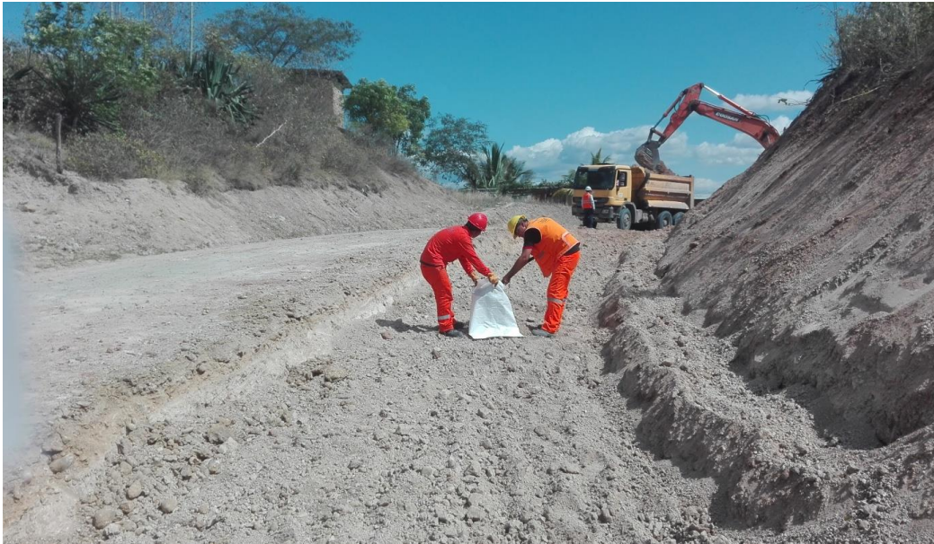
Figura 15. Vista donde se observa el muestreo en pista del material de mejoramiento para ser ensayadas en laboratorio – Julio 2016.
