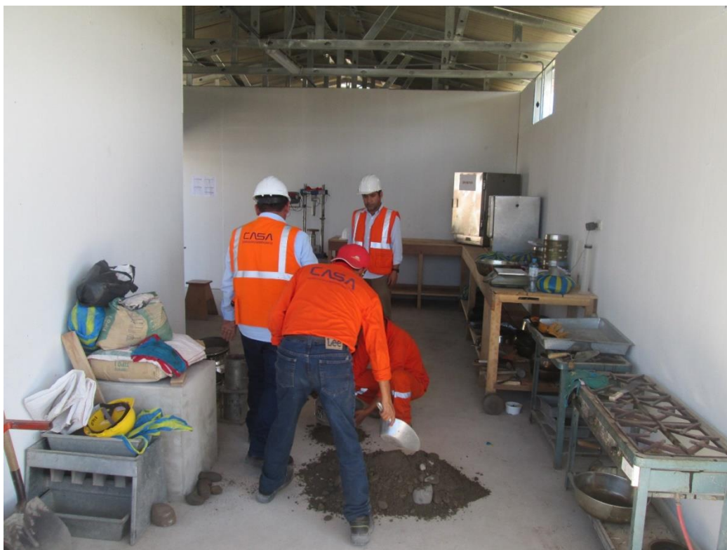
Figura 5. Material extraído para realizar las pruebas de granulometría. Personal Técnico de Laboratorio de Suelos de CASA, al fondo de la foto Carlos Alberto Rivera Cruz (Tesista).
