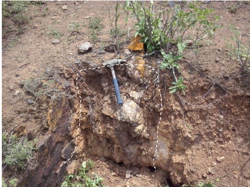
Foto 4: Toma de muestra mediante realización de trincheras en veta.
