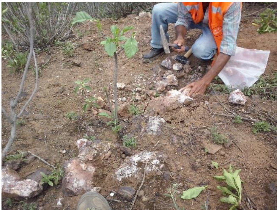
Foto 3: Toma de Muestra por método Rock Chip en afloramientos.
