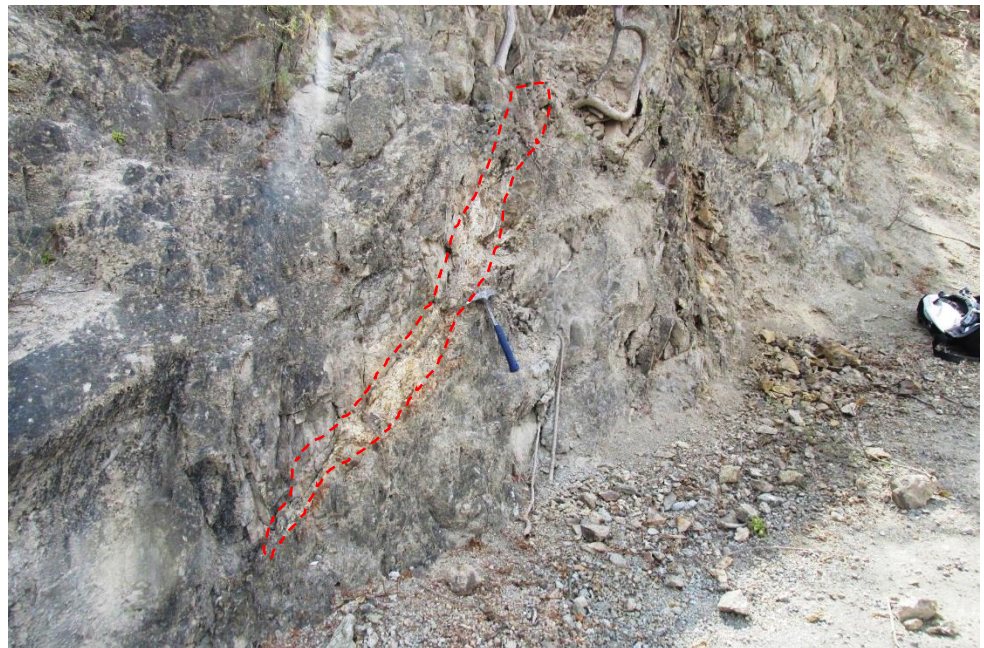
Foto 11: Andesitas grises ligeramente meteorizadas por agentes superficiales, así mismo se aprecian algunos lineamientos de arcillas rellenando fracturas considerables (aluminosilicatos).
