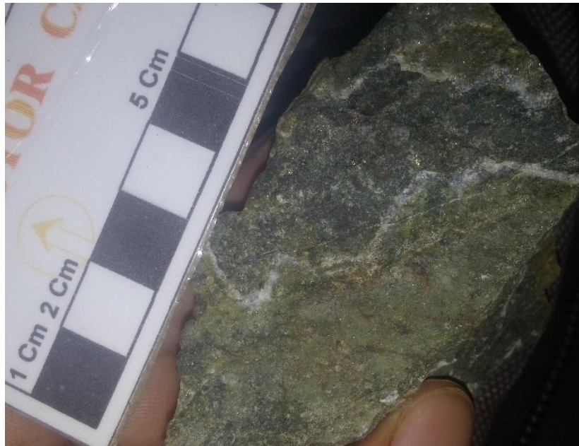
Foto 25: Muestra una Andesita fuertemente silisificada, con algunos cristales de pirita y venillas de Qz.
