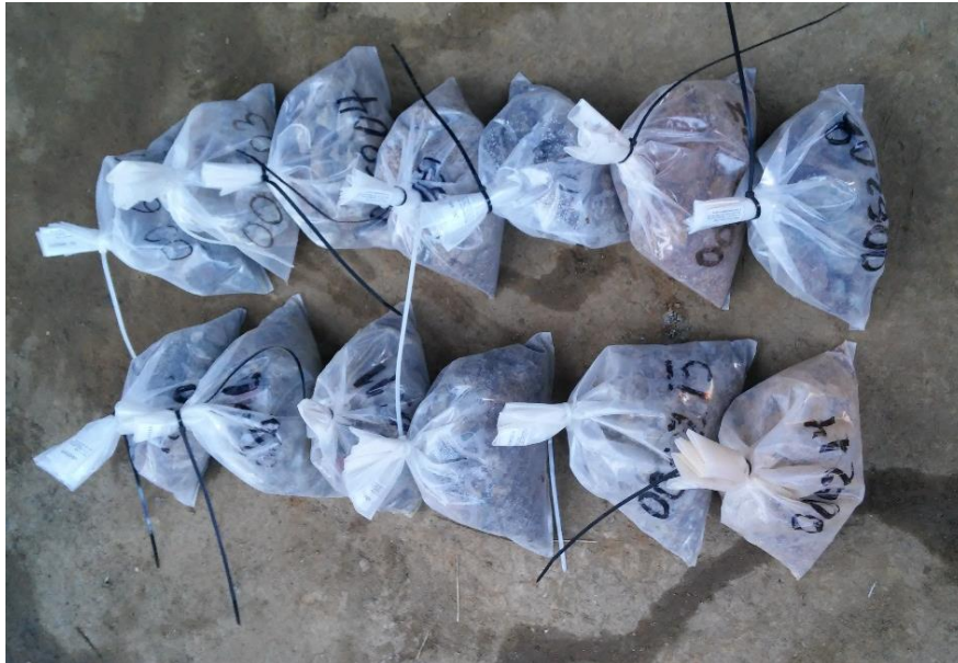
Foto 7: Muestras en bolsas de polipropileno codificados, para su respectivo envío al laboratorio para un barrido de 38 elementos.
