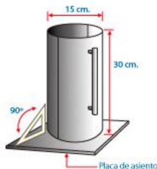
Figura 7: Molde cilíndrico para espécimen de concreto
