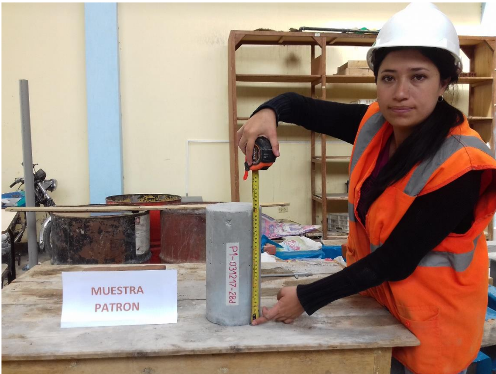
Figura 45: Fotografía de la medida de la esbeltez de los especímenes de concreto
