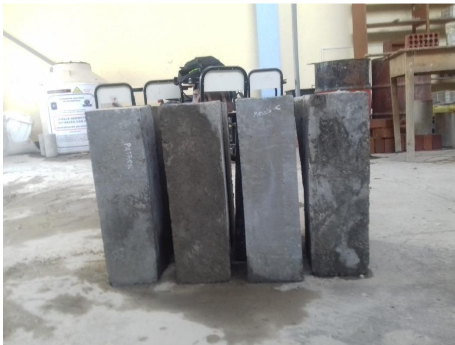
Figura 49: Probetas de concreto prismáticas para ensayo a flexión.
