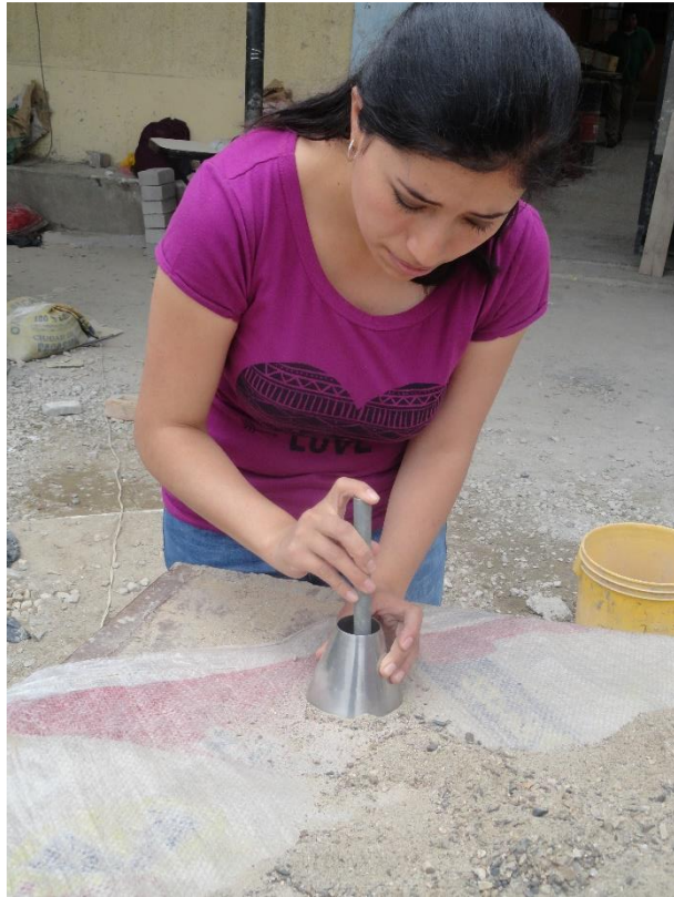
Figura 40: Fotografía del ensayo del Cono de Absorción de Arenas
