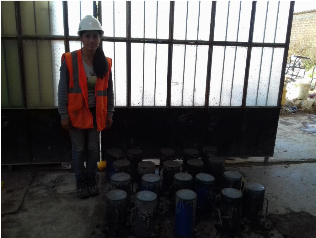
Figura 44: Tesista con especímenes recién vaciados a moldes los cuales serán ensayados a tracción
