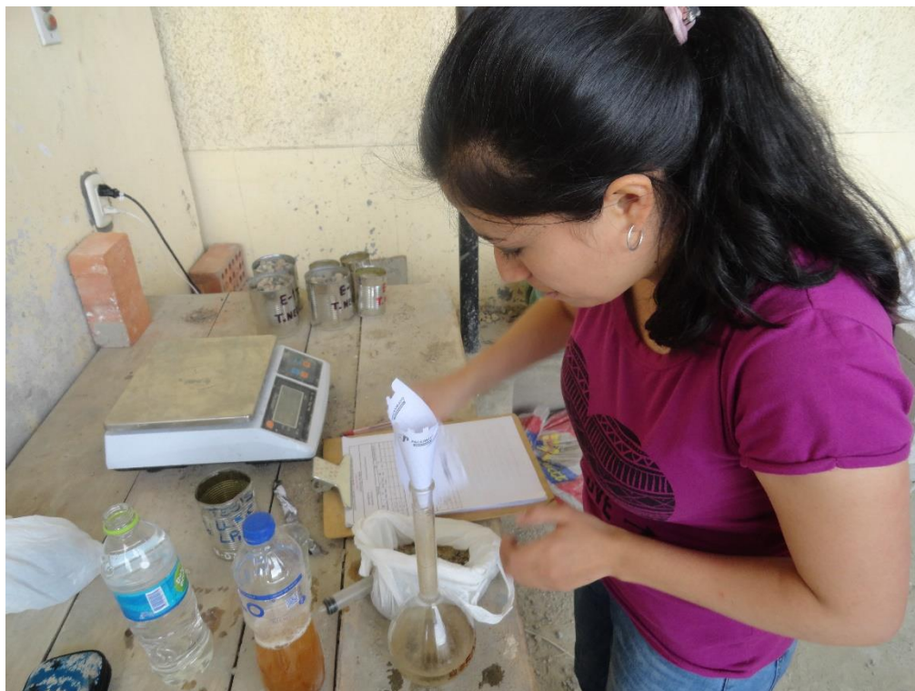
Figura 39: Fotografía del Ensayo de Peso específico del Agregado Fino
