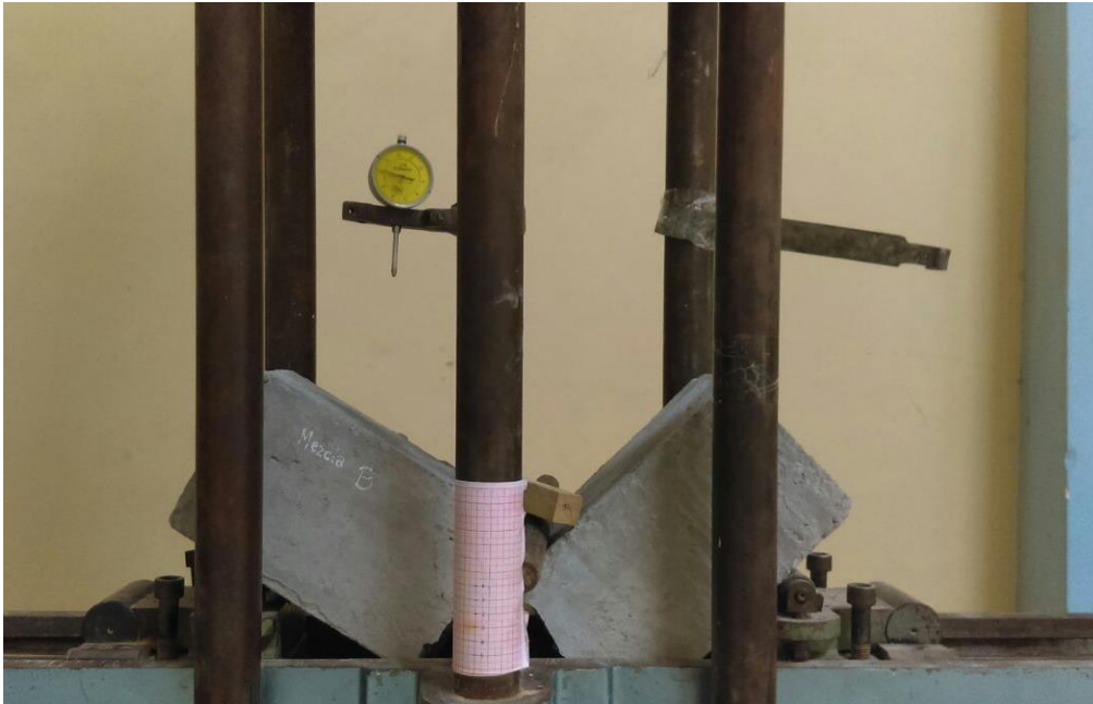
Figura 50: Fotografía de probeta prismática que ha fallado producto de ensayo a flexión
