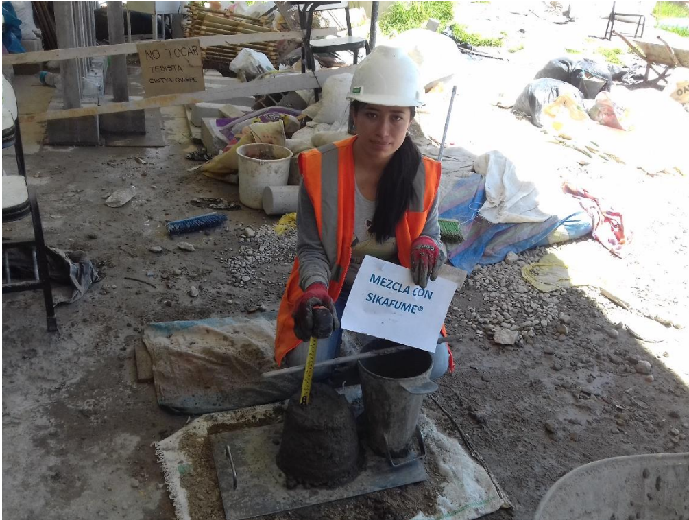
Figura 42: Fotografía del ensayo de Cono de Abrams de la Mezcla B.
