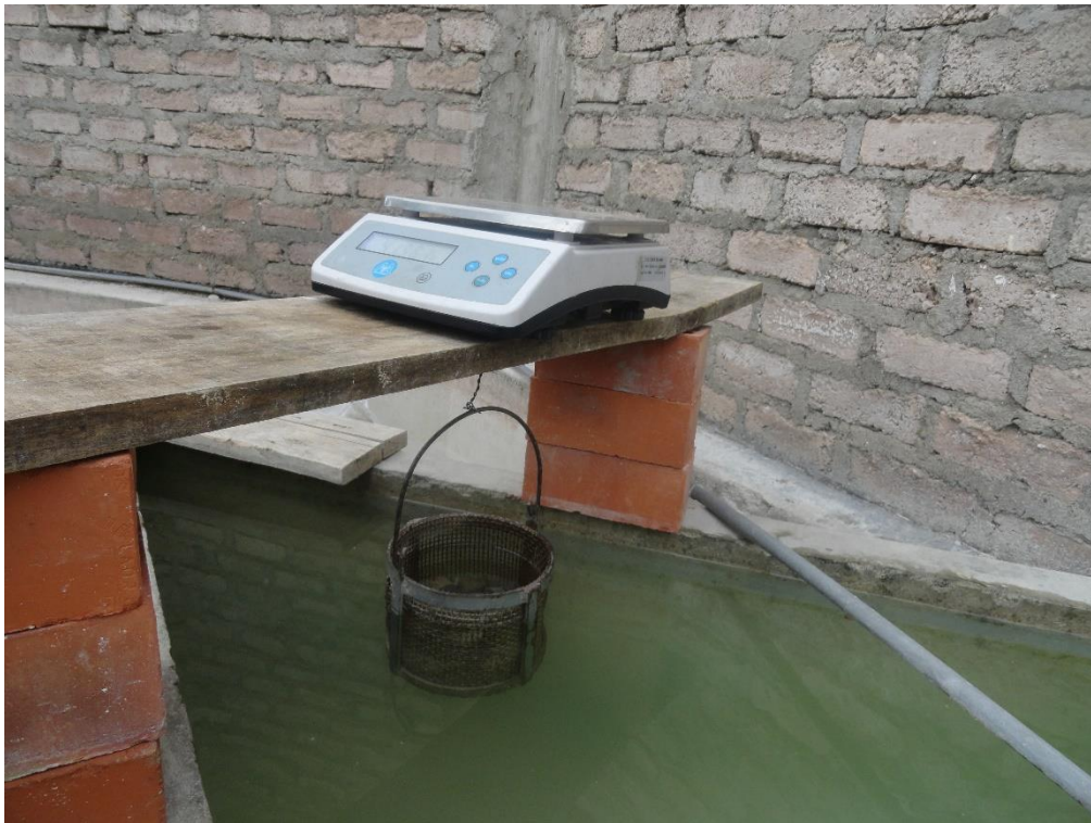
Figura 38: Fotografía del ensayo Peso específico del Agregado Grueso.
