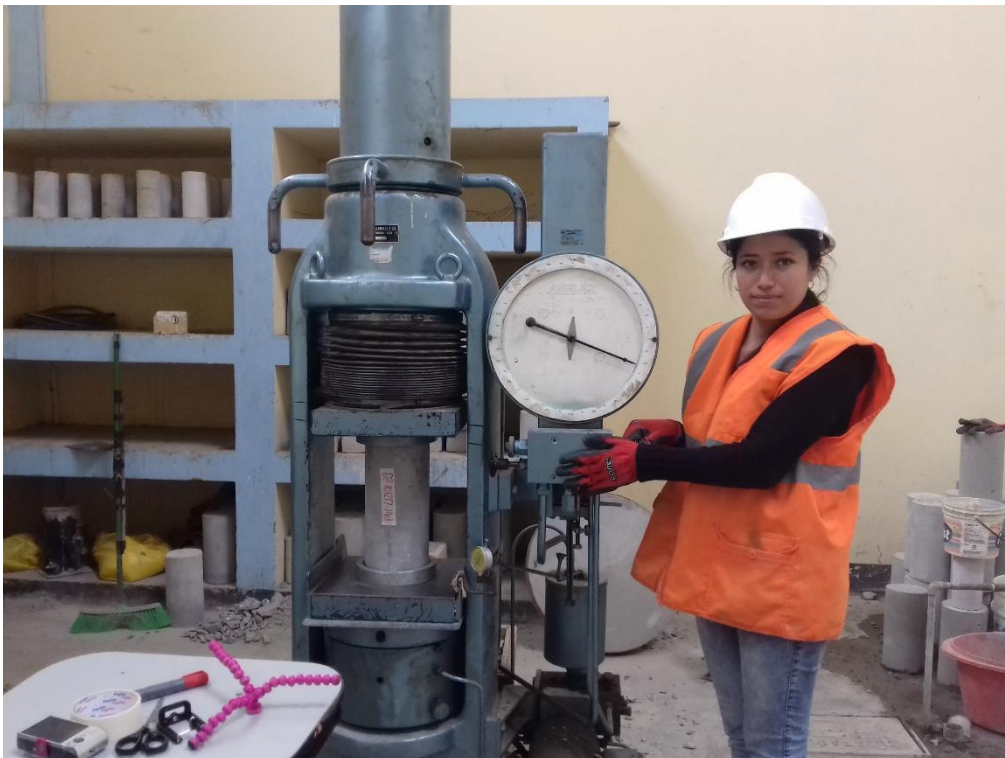
Figura 47: Tesista realizando ensayo a compresión.
