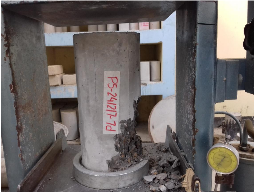
Figura 46: Fotografía de espécimen con falla frágil producto de ensayo a compresión.
