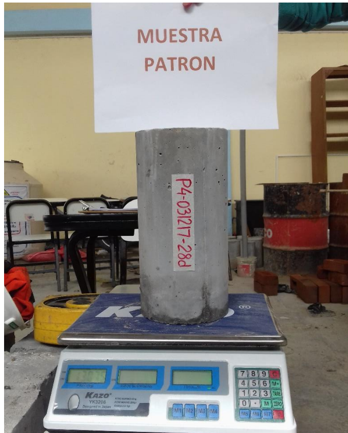
Figura 43: Fotografía de la toma del peso de los especímenes.
